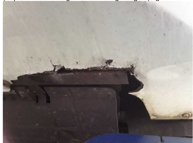
Beschädigung #4: Stossfänger vorn: Stossfänger vorn (Reparaturerweiterung nach Demontage möglich) - gebroche...
