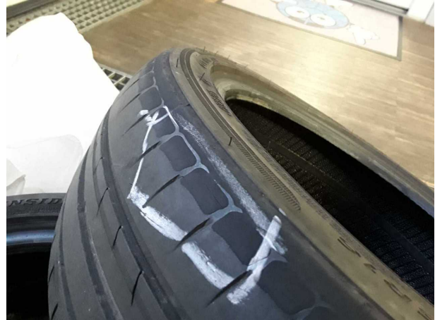
Beschädigung #1: 2.Radsatz: 2 Reifen - erneuern
