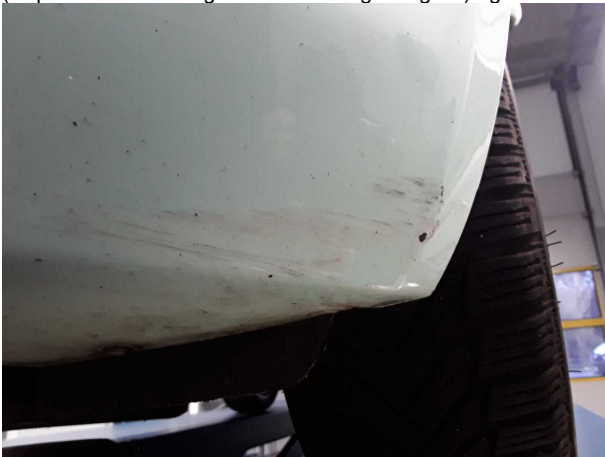
Beschädigung #4: Stossfänger vorn: Stossfänger vorn (Reparaturerweiterung nach Demontage möglich) - gebrochen /
