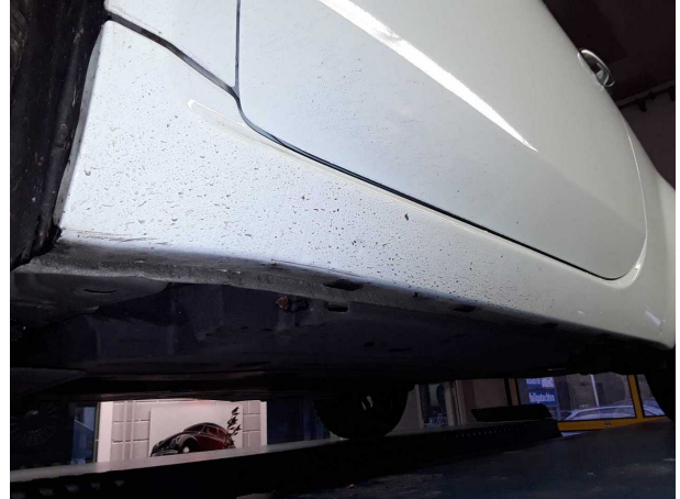
Beschädigung #3: Schweller links: Schweller - Kratzer - lackieren
