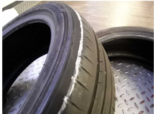
Beschädigung #1: 2.Radsatz: 2 Reifen - erneuern
