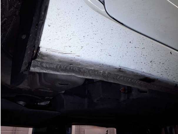
Beschädigung #3: Schweller links: Schweller - Kratzer - lackieren
