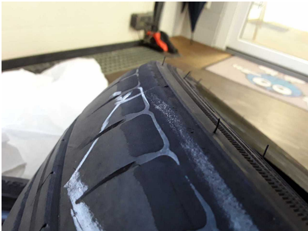
Beschädigung #1: 2.Radsatz: 2 Reifen - erneuern
