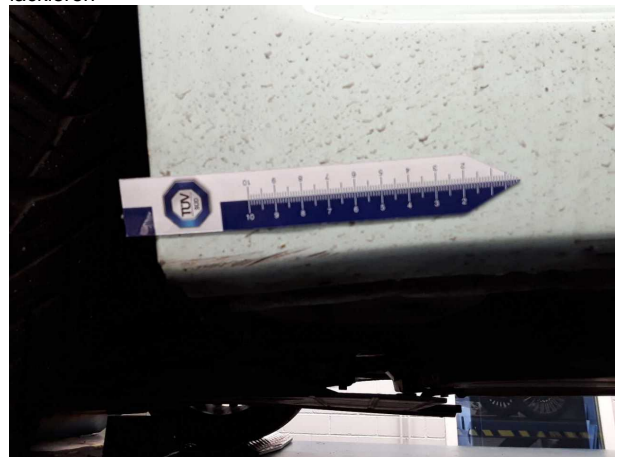
Beschädigung #3: Schweller links: Schweller - Kratzer - lackieren
