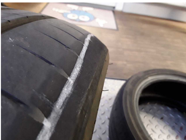
Beschädigung #1: 2.Radsatz: 2 Reifen - erneuern
