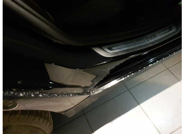
Beschädigung #2: Seitenwand rechts: Einstieg - Kratzer - Smart Repair
