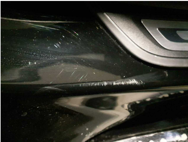
Beschädigung #2: Seitenwand rechts: Einstieg - Kratzer - Smart Repair
