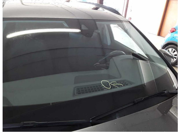
Beschädigung #5: Verglasung: Frontscheibe (Rissbildung) - Steinschlag - erneuern
