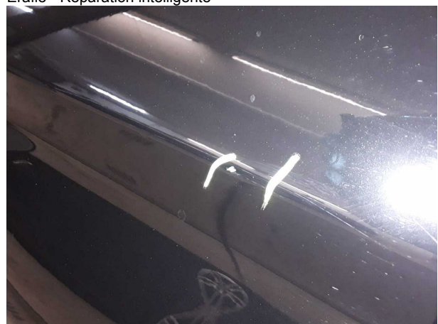
Domage #3: Panneau latéral arrière gauche: Paroi latérale - Eraflé - Réparation intelligente
