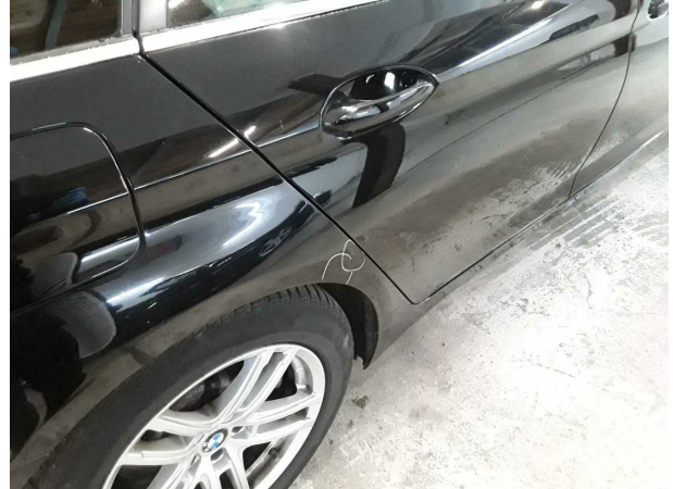
Dommmage #5: Panneau latéral arrière droit: Paroi latérale - bosse(s) - Bon travail de réparation
