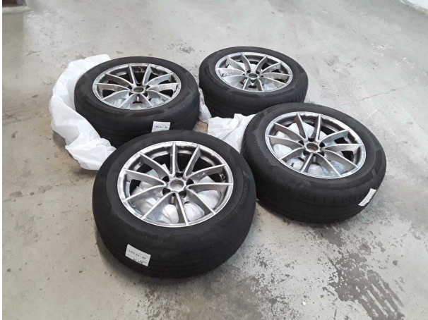
Domage #8: 2e Jeu de roues: Jeu de pneus complet (Seitlich abgefahren) - Usé - Remplacer
