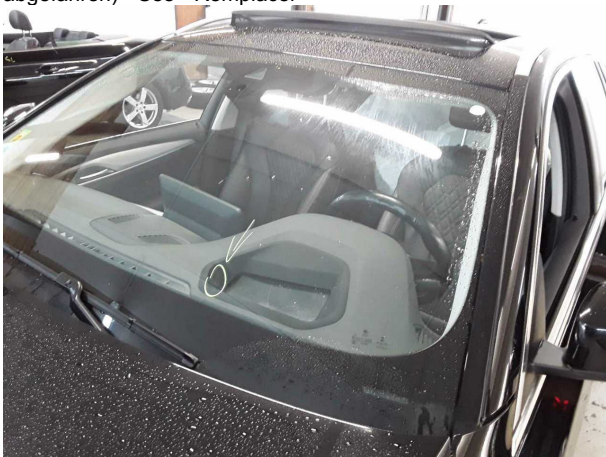
Domage #9: Vitrage: Pare-brise (Rissbildung) - Dommage causé par des cailloux - Remplacer
