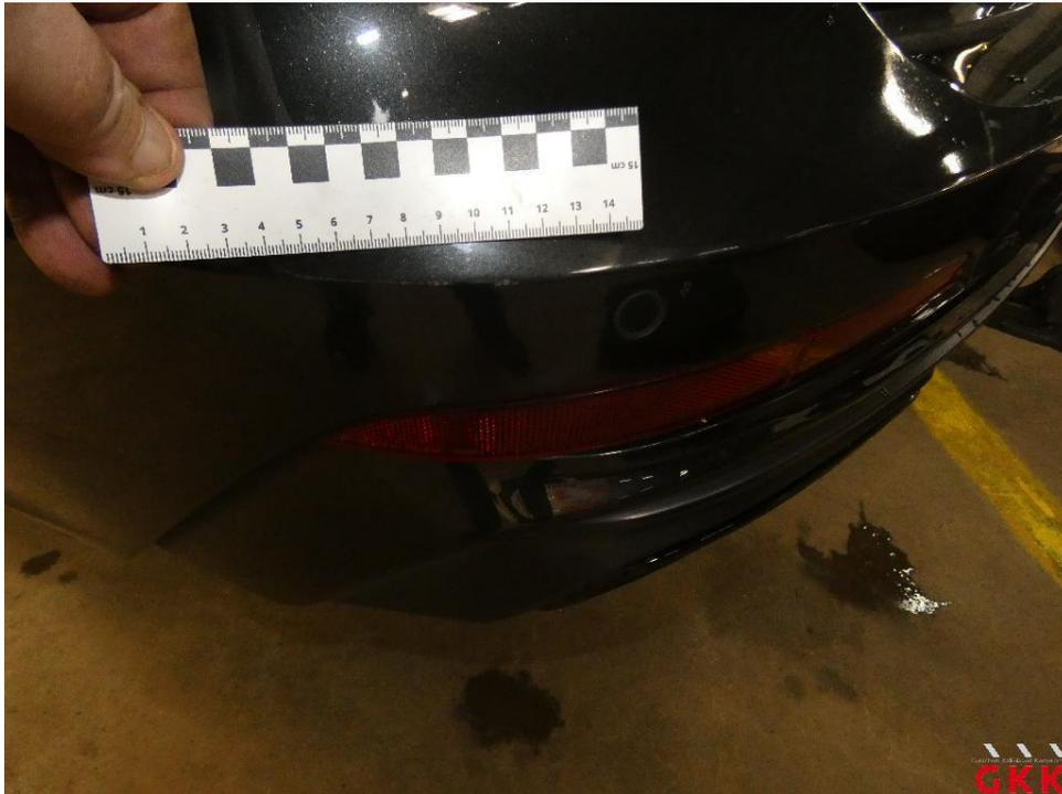
Bild 27 Stoßfänger hinten, Verkleidung -lackiert-, verkratzt, lackieren
