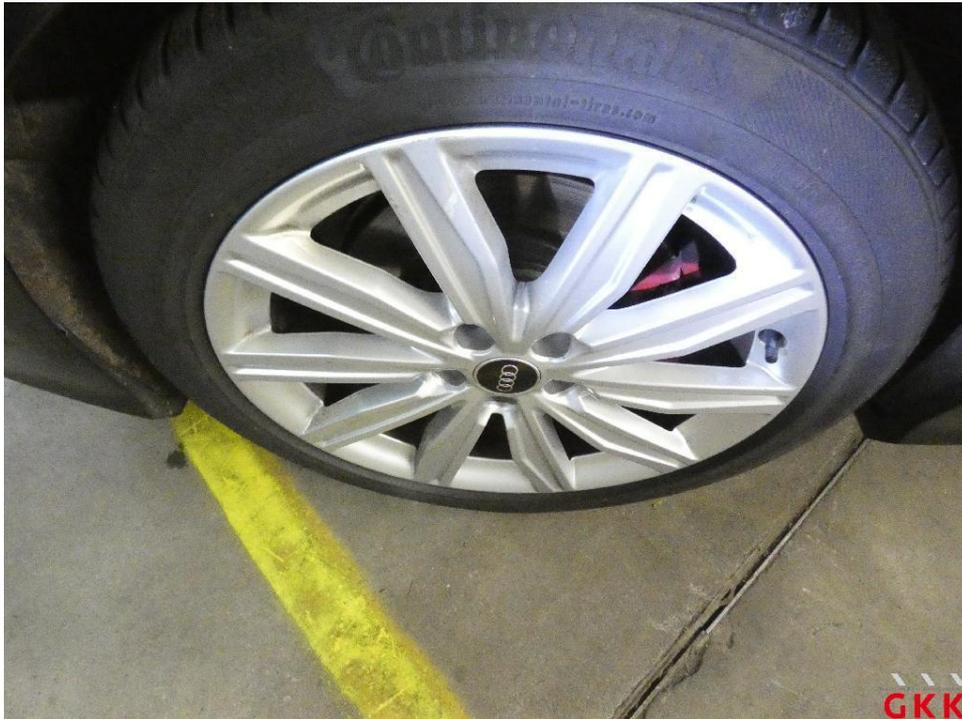
Bild 19 LM-Rad, hinten rechts, verkratzt, Smartrepair
