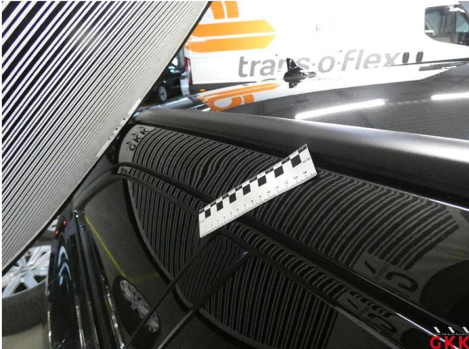
Bild 23 Dach, Holm rechts, beschädigt, kalt drücken
