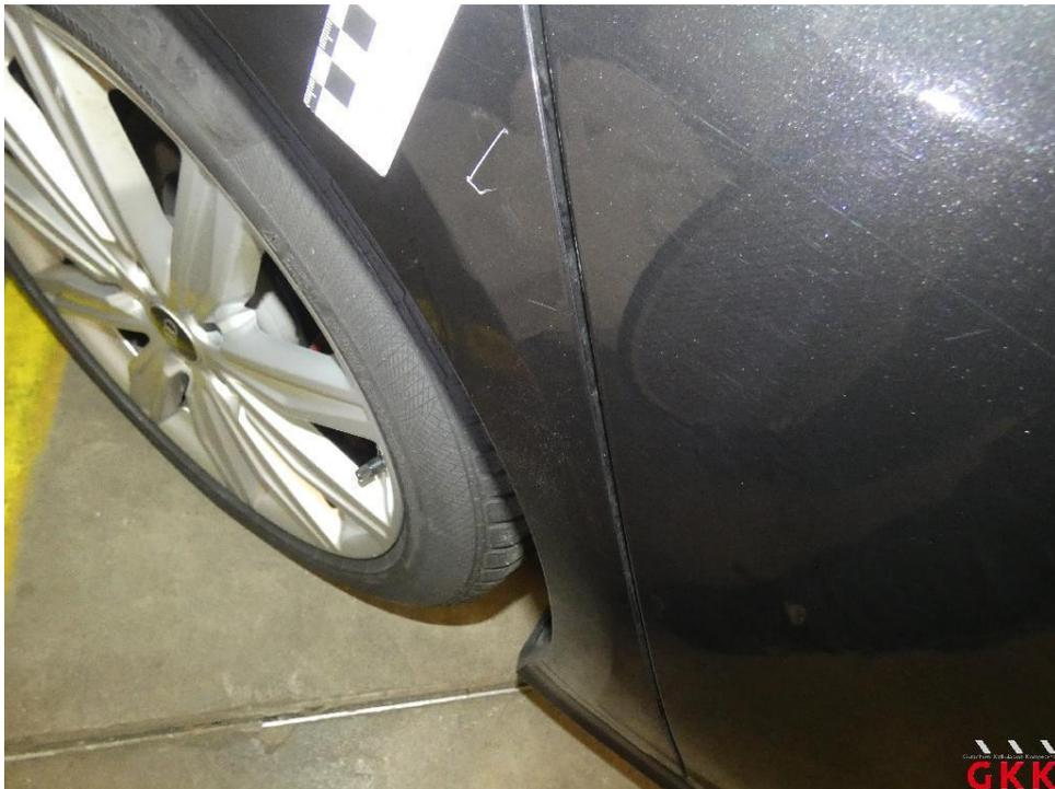
Bild 22 Seitenwand rechts, verkratzt, lackieren
