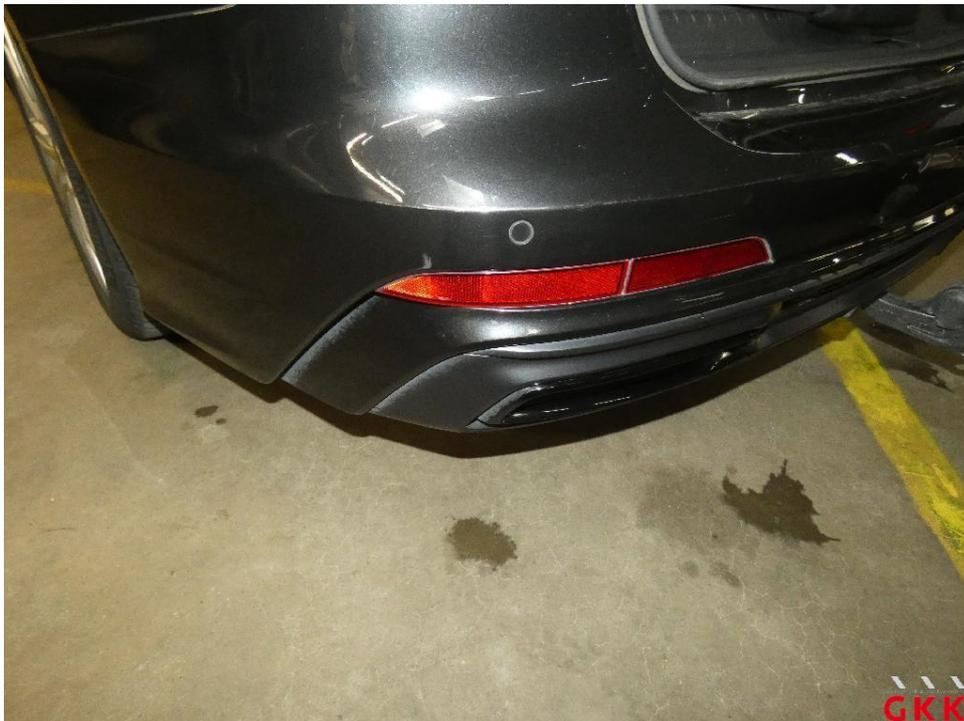
Bild 26 Stoßfänger hinten, Verkleidung -lackiert-, verkratzt, lackieren
