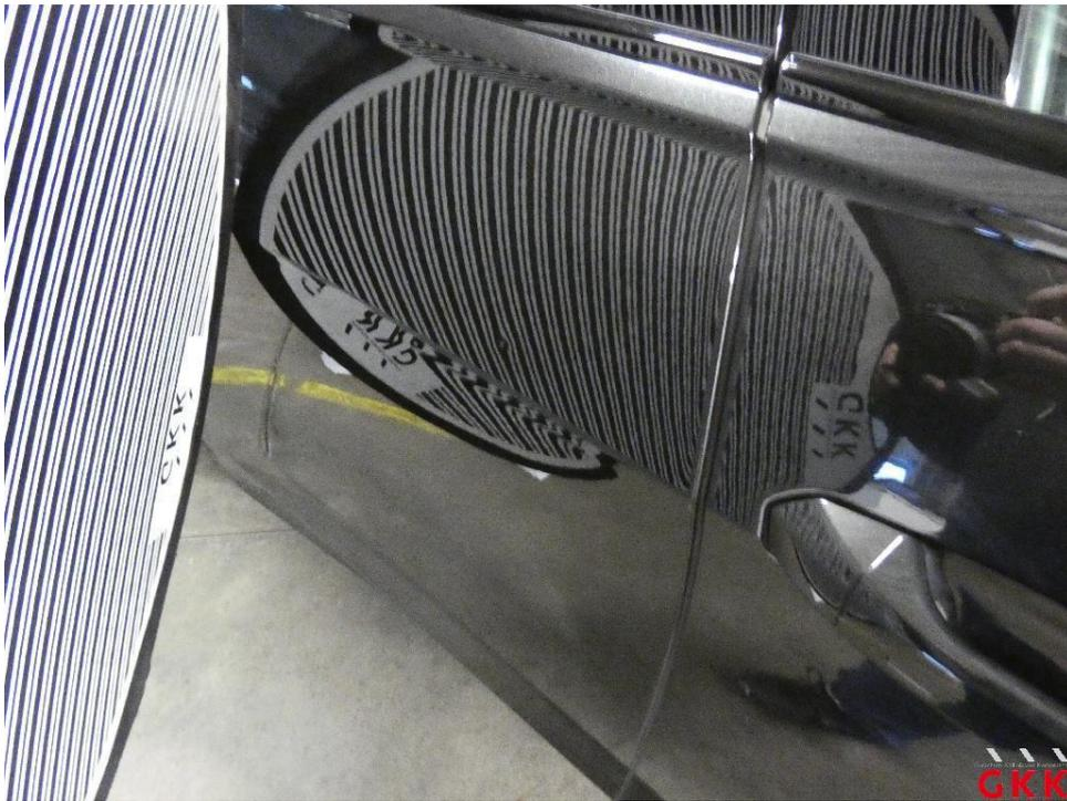
Bild 24 Tür hinten rechts, beschädigt, instand setzen - lackieren
