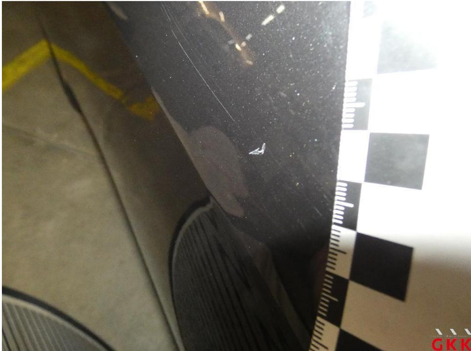
Bild 25 Tür hinten rechts, beschädigt, instand setzen - lackieren
