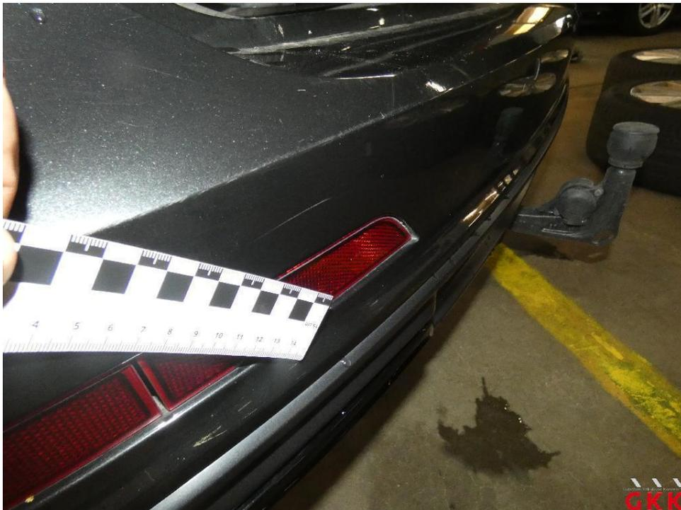
Bild 28 Stoßfänger hinten, Verkleidung -lackiert-, verkratzt, lackieren
