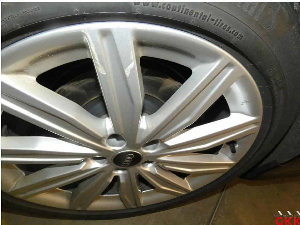
Bild 20 LM-Rad, hinten rechts, verkratzt, Smartrepair
