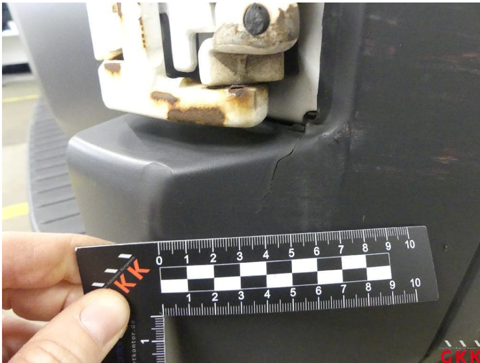
Bild 26 Stoßfänger hinten, Ecke rechts -unlackiert-, gerissen, ersetzen
