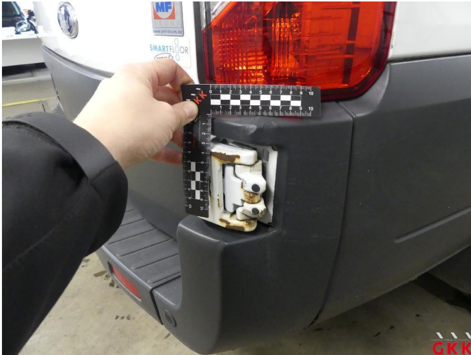
Bild 25 Stoßfänger hinten, Ecke rechts -unlackiert-, gerissen, ersetzen
