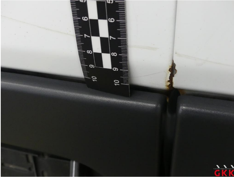
Bild 35 Hecktür links, korrodiert, instand setzen - lackieren
