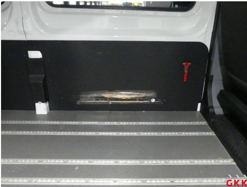
Bild 20 Laderaum, Abdeckung, beschädigt, ersetzen
