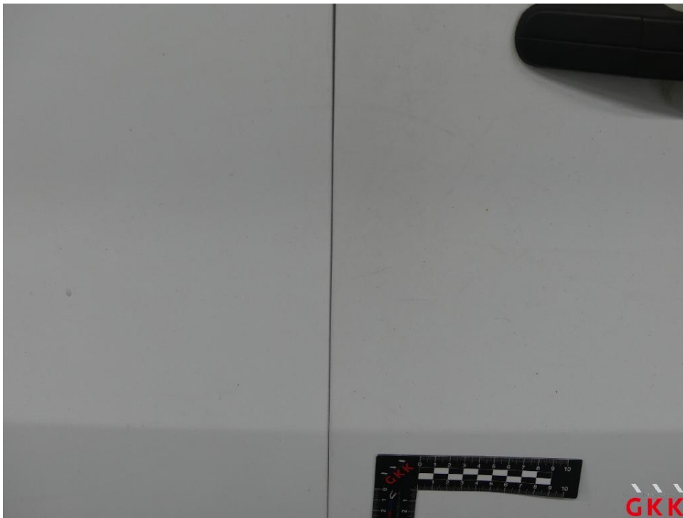
Bild 28 Hecktür rechts, Spaltmaß fehlerhaft, instand setzen
