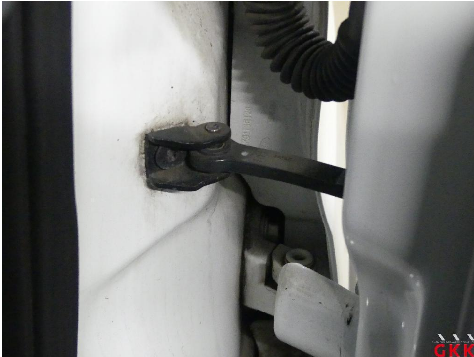
Bild 19 Tür vorne rechts, Fangband / Feststeller, untypische Geräusche, ersetzen
