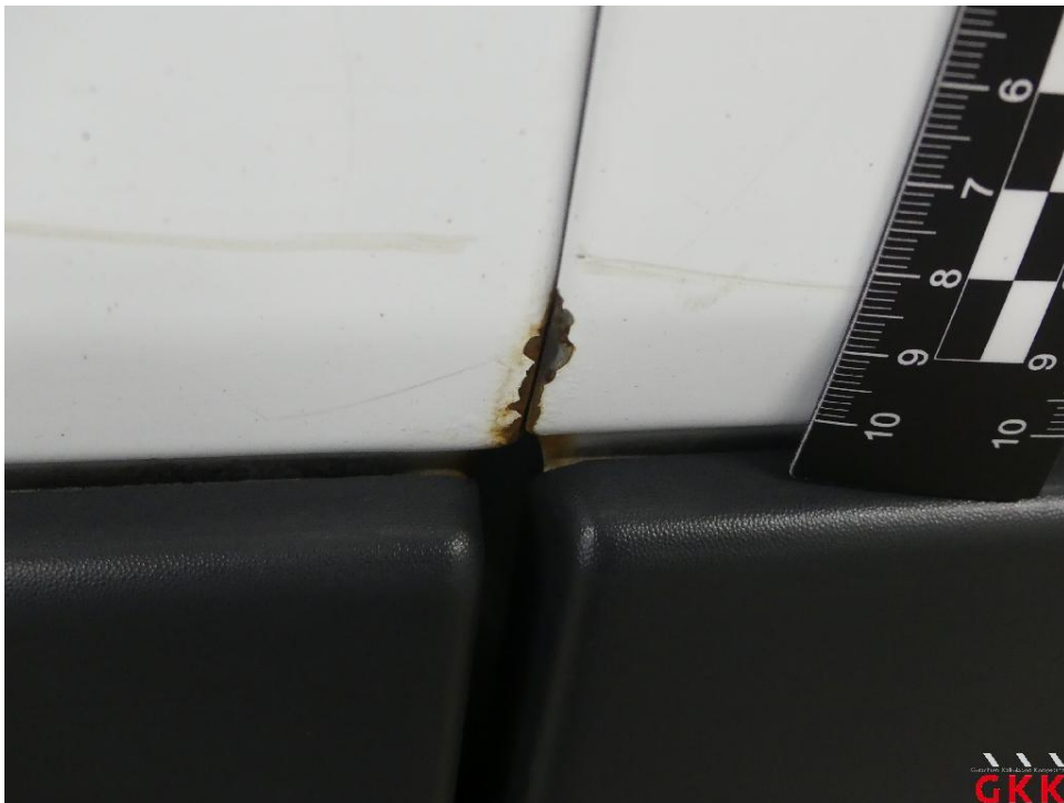
Bild 34 Hecktür links, korrodiert, instand setzen - lackieren
