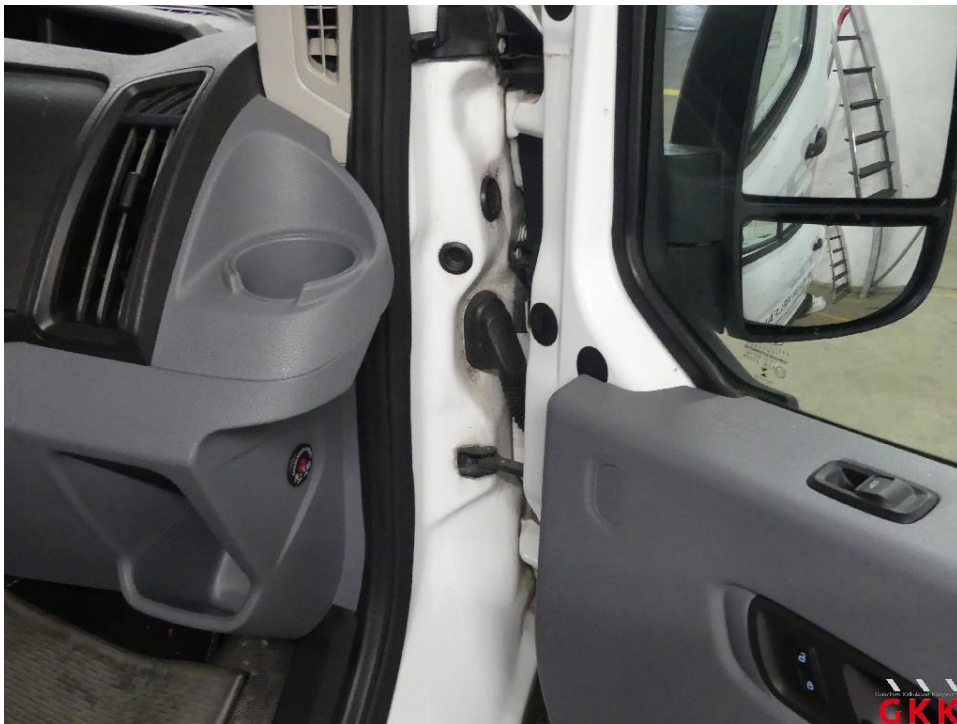
Bild 18 Tür vorne rechts, Fangband / Feststeller, untypische Geräusche, ersetzen
