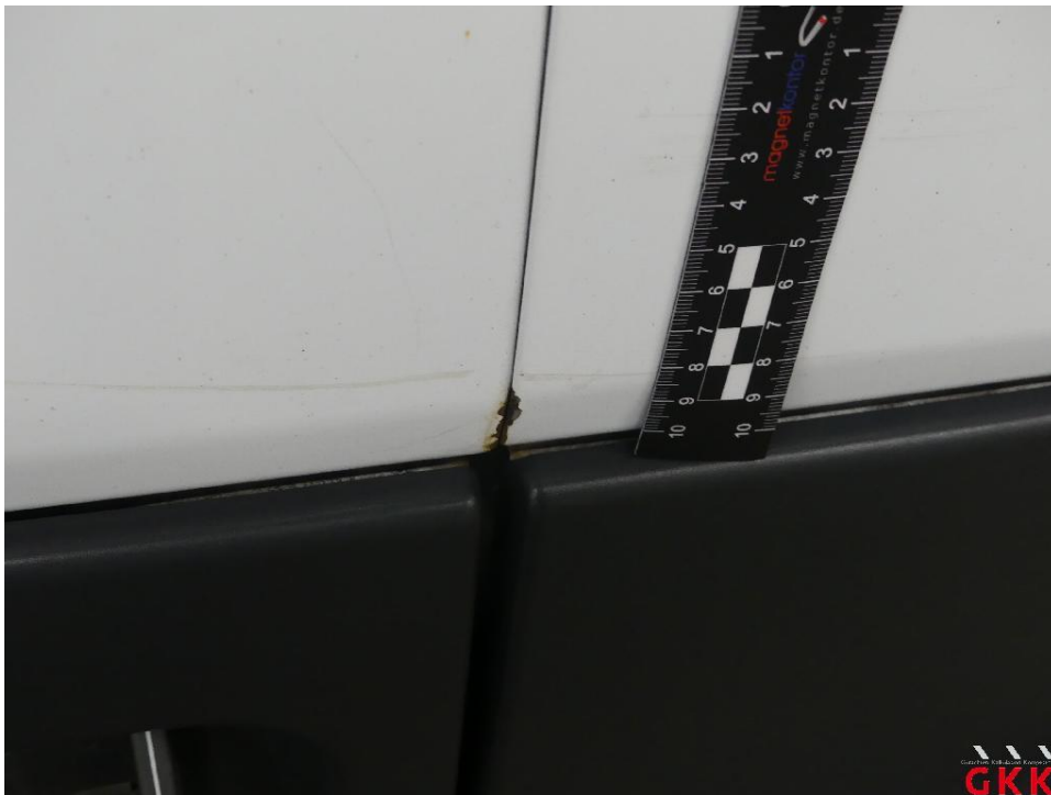
Bild 32 Hecktür rechts, korrodiert, instand setzen - lackieren
