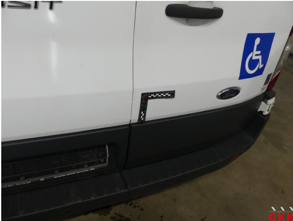
Bild 31 Hecktür rechts, korrodiert, instand setzen - lackieren
