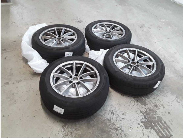
Damage #8: 2nd wheel set: Tyres - complete set (Seitlich abgefahren) - Worn - Replace
