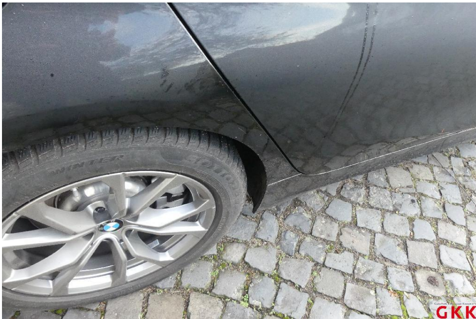
Bild 14. Seitenwand rechts, verkratzt, lackieren
