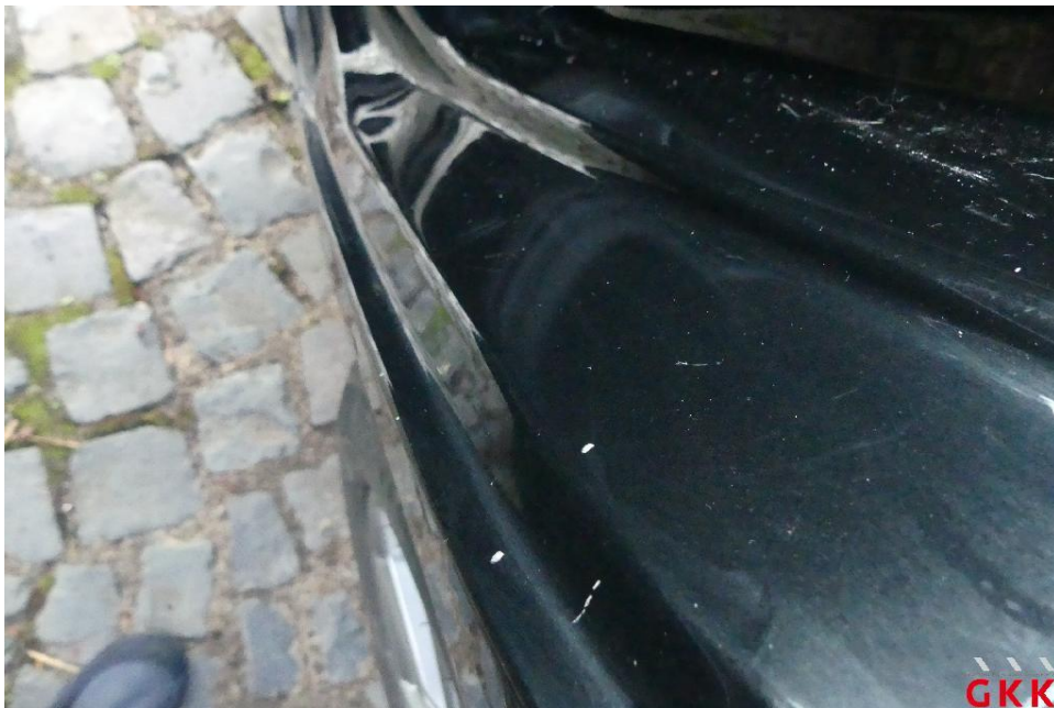
Bild 20. Tür hinten links, Einstieg, verkratzt, lackieren
