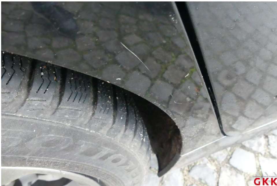
Bild 16. Seitenwand rechts, verkratzt, lackieren
