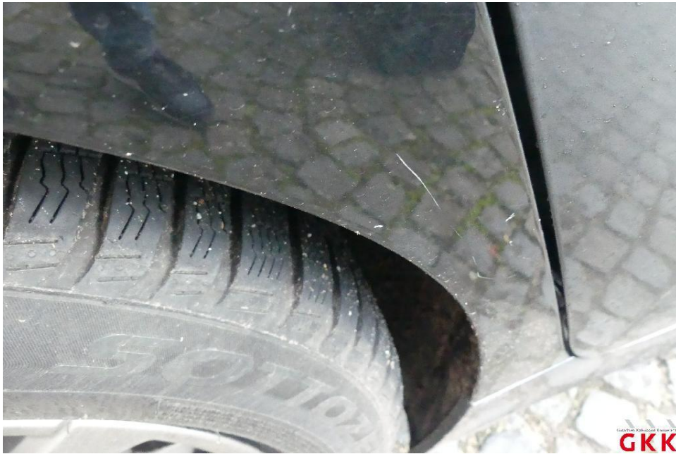
Bild 15. Seitenwand rechts, verkratzt, lackieren
