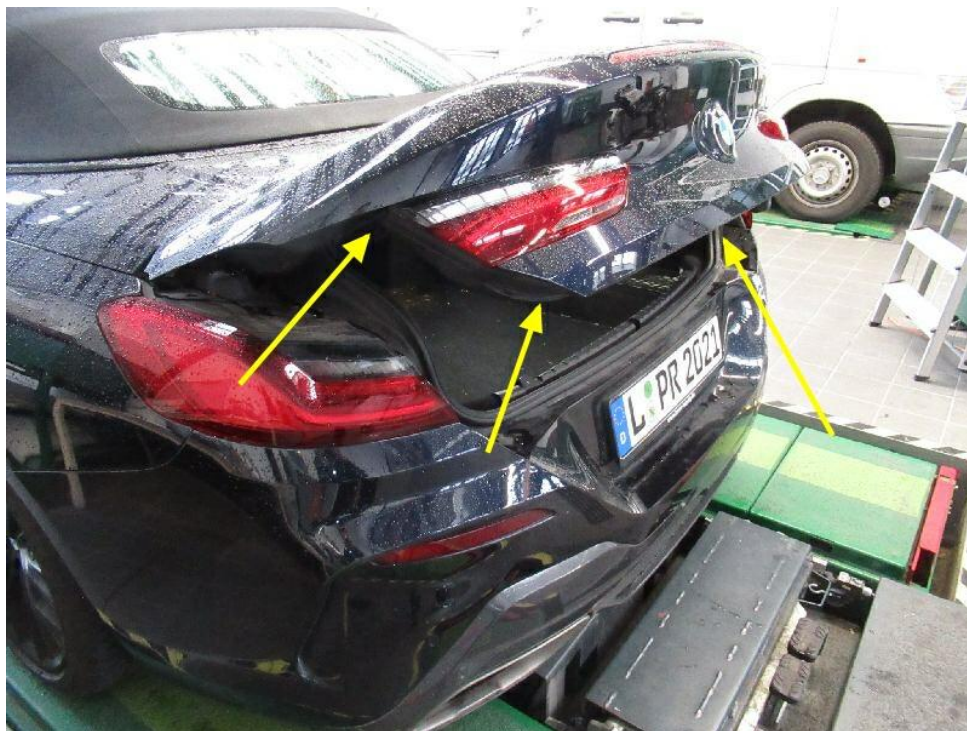
Bild 29 : Heckklappe öffnet nicht vollständig, klemmt, schließt nicht automatisch
