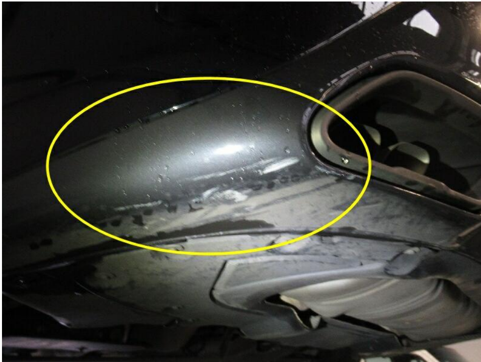
Bild 20 : Stoßfängerunterteil hinten verkratzt
