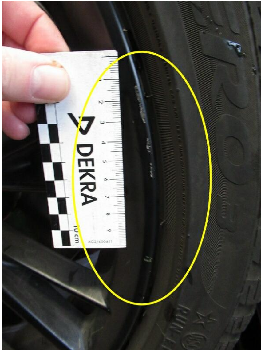
Bild 25 : Felge vorne rechts, verschrammt, smart repair
