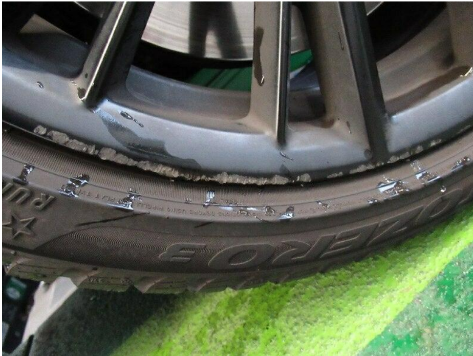
Bild 24 : Leichtmetallfelge hinten rechts tief verschrammt mit Materialabtrag
