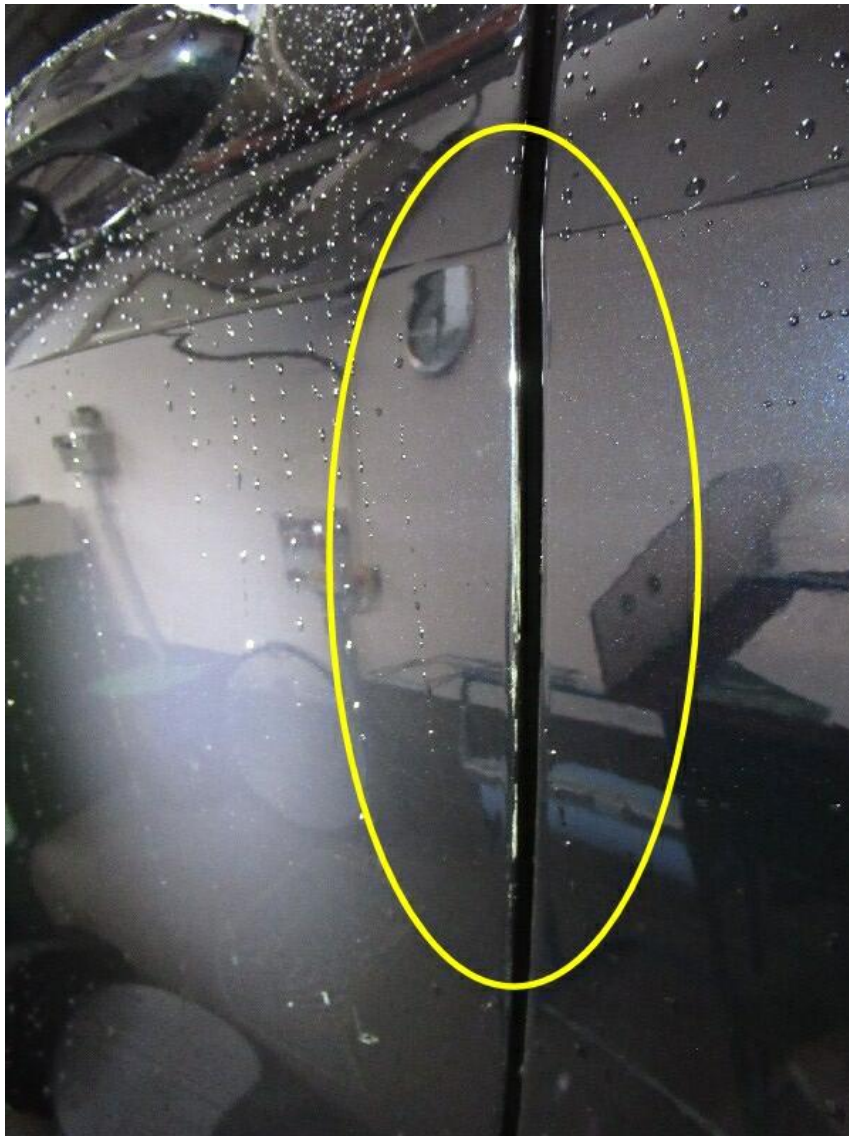
Bild 17 : Tür vorne links Türkante, verschrämmt, smart repair
