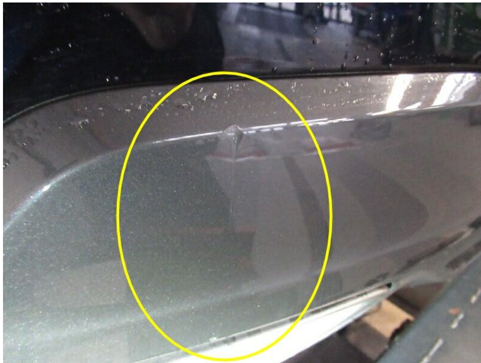
Bild 19 : Stoßfängerunterteil hinten verkratzt
