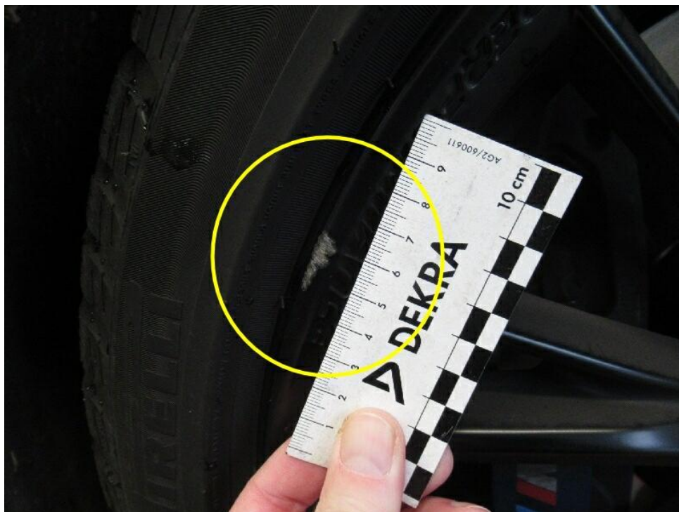
Bild 26 : Felge vorne rechts, verschrammt, smart repair
