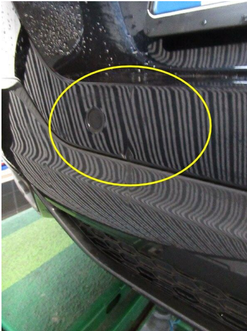
Bild 22 : Stoßfänger hinten, eingedellt, verkratzt, instandsetzen und lackieren mit Lackaufbau
