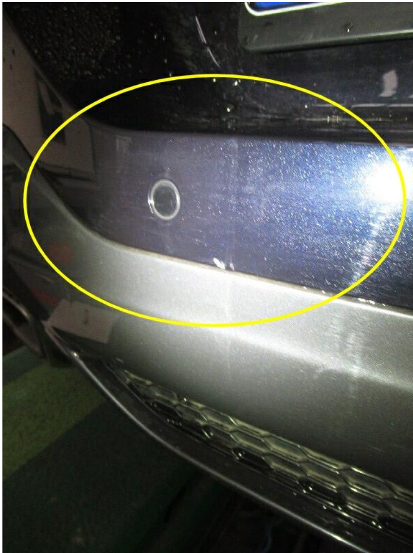
Bild 21 : Stoßfänger hinten, eingedellt, verkratzt, instandsetzen und lackieren mit Lackaufbau
