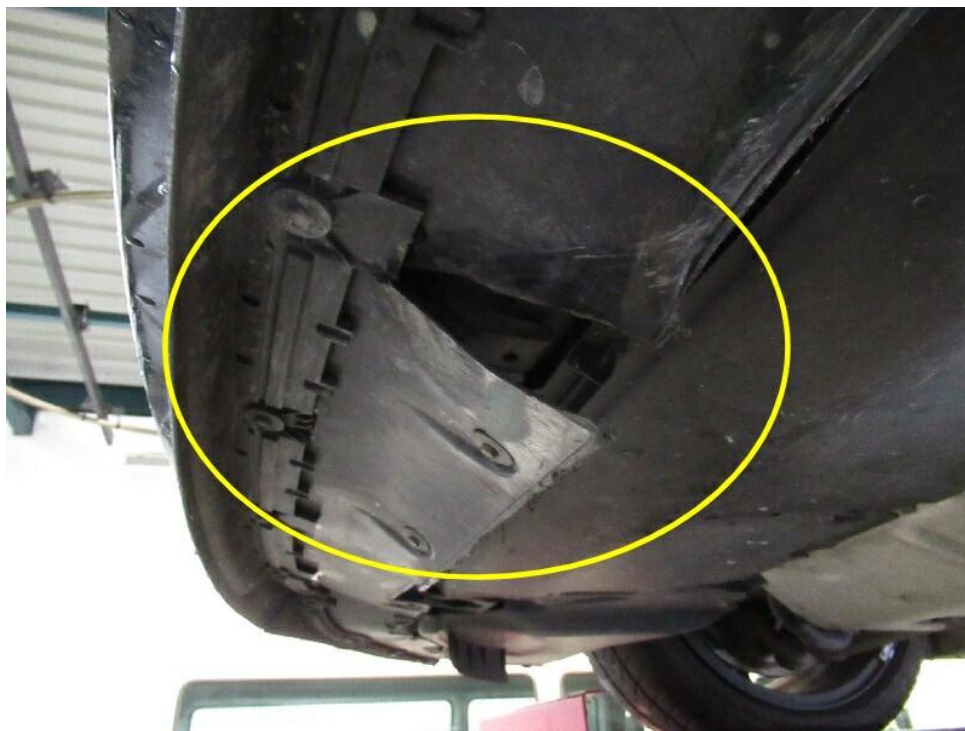
Bild 27 : Stoßfänger vorn unterhalb gerissen, gebrochen
