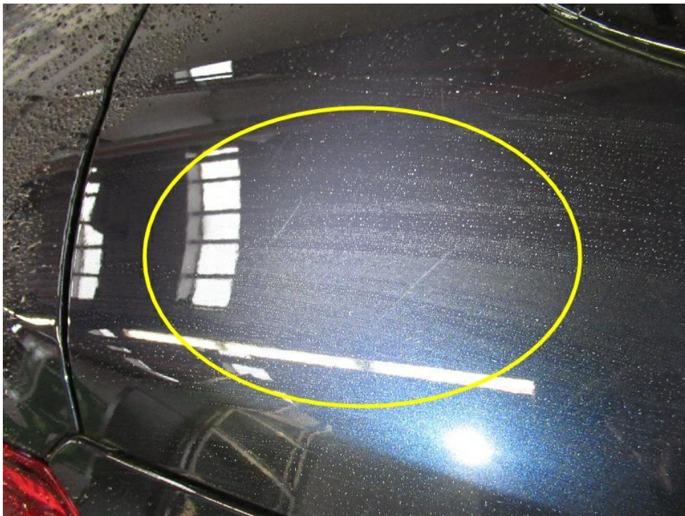
Bild 16 : Gesamte Karosserie Oberflächenkratzer, Lackanhaftungen, Lacktiefenbehandlung
