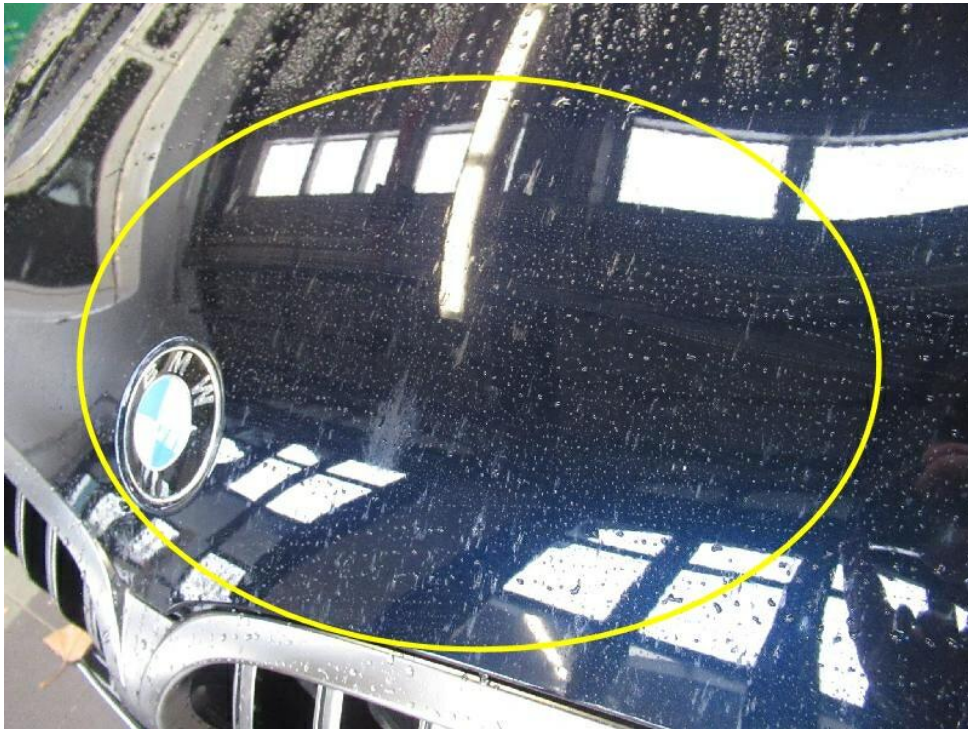
Bild 15 : Gesamte Karosserie Oberflächenkratzer, Lackanhaftungen, Lacktiefenbehandlung
