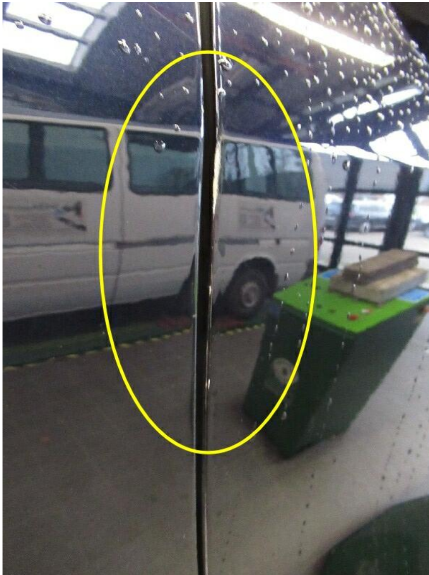
Bild 23 : Tür vorne rechts Türkante, verschrammt, smart repair
