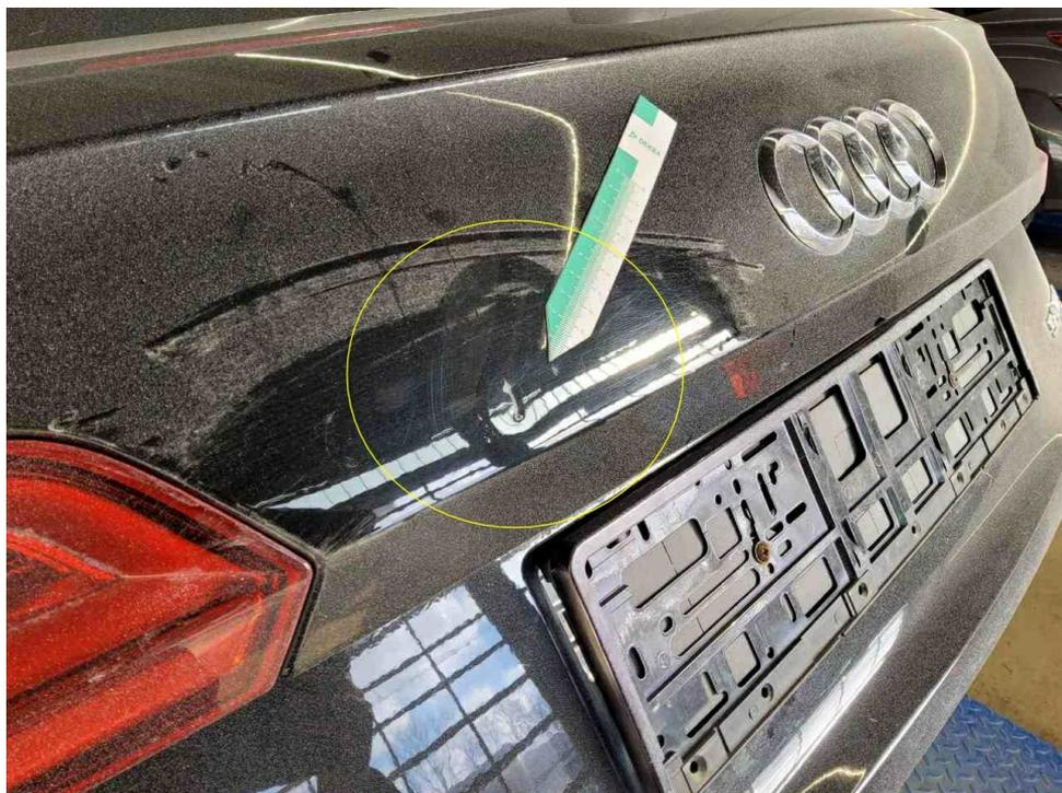
Bild 14 : Heckklappe eingedellt
