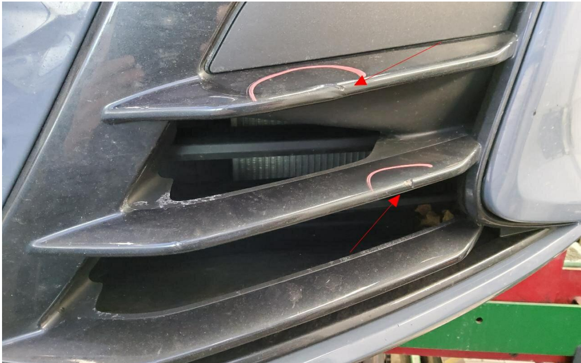
Bild 21 : Stoßfängerblende vorne plastisch verformt
