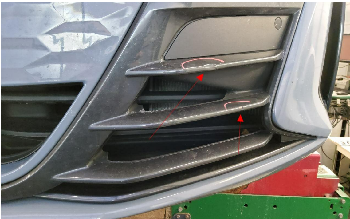
Bild 20 : Stoßfängerblende vorne plastisch verformt
