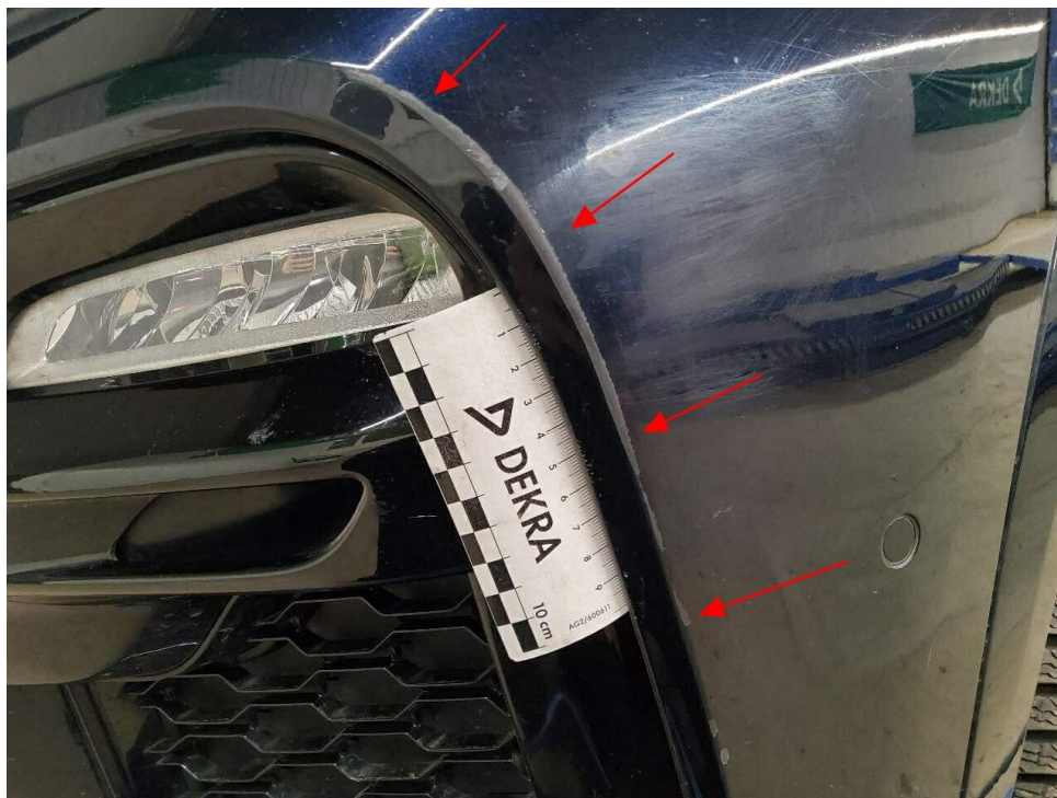
Bild 19 : Stoßfänger vorne Lackierung, verschrammt, lackieren mit Lackaufbau
