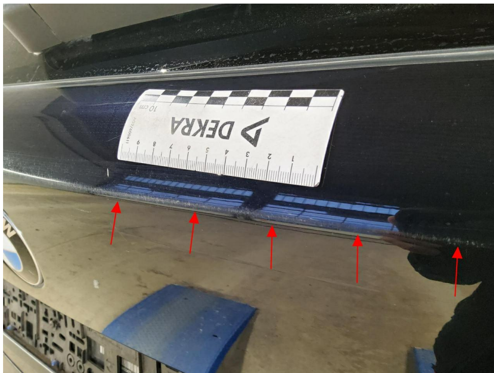
Bild 27 : Heckklappe, eingedellt, instandsetzen und lackieren mit Lackaufbau verschrammt
