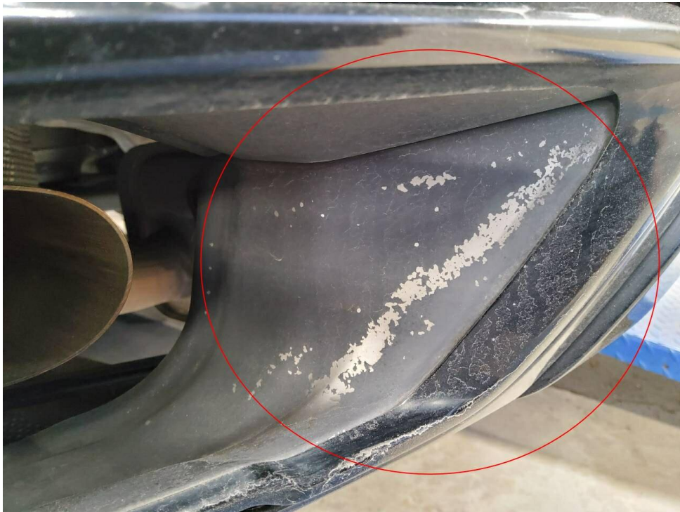
Bild 29 : Blende Auspuff links, Lackablösung
