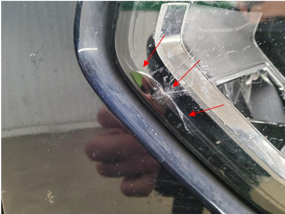
Bild 17 : Scheinwerfer links, Steinschlag mit Rissbildung
