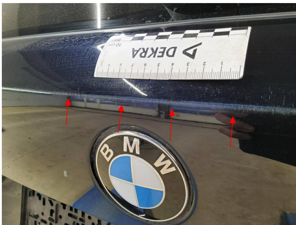
Bild 26 : Heckklappe, eingedellt, instandsetzen und lackieren mit Lackaufbau verschrammt
