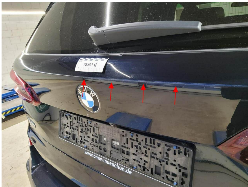
Bild 25 : Heckklappe, eingedellt, instandsetzen und lackieren mit Lackaufbau verschrammt
