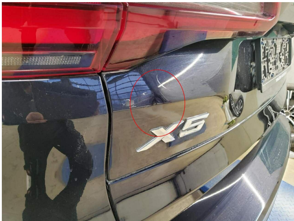
Bild 22 : Heckklappe, eingedellt, instandsetzen und lackieren mit Lackaufbau
