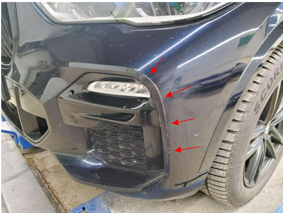
Bild 18 : Stoßfänger vorne Lackierung, verschrammt, lackieren mit Lackaufbau
