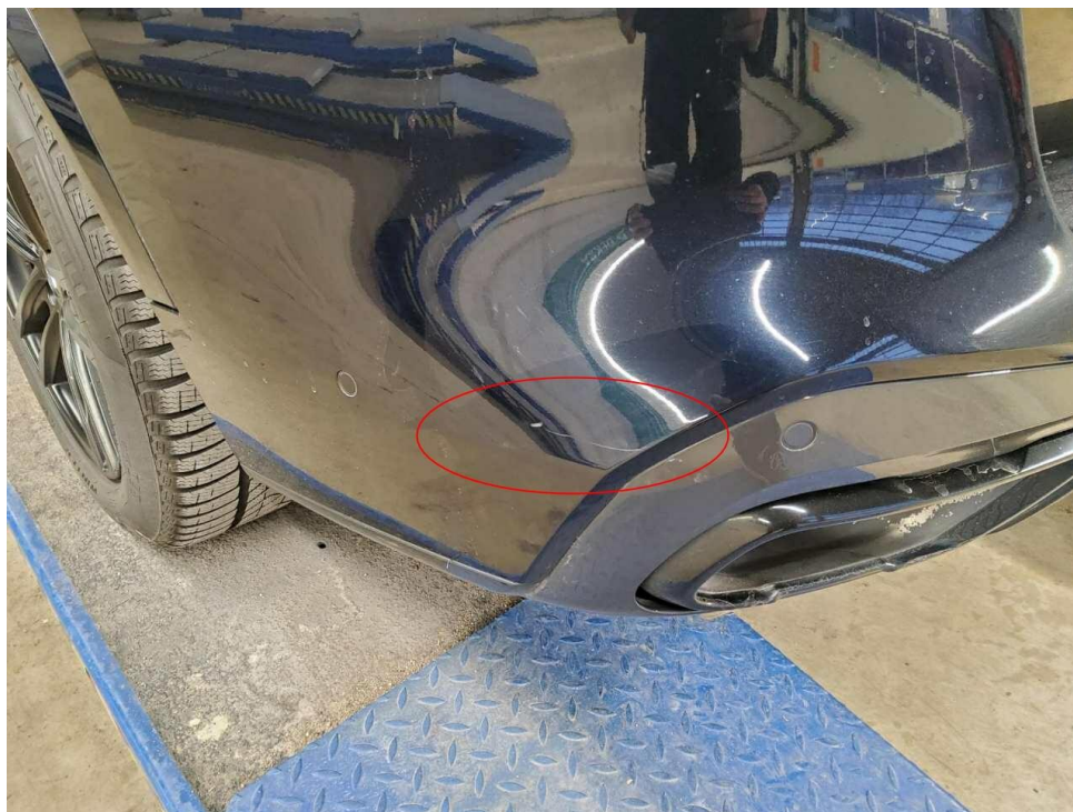
Bild 20 : Stoßfänger hinten Lackierung, zerkratzt, smart repair
