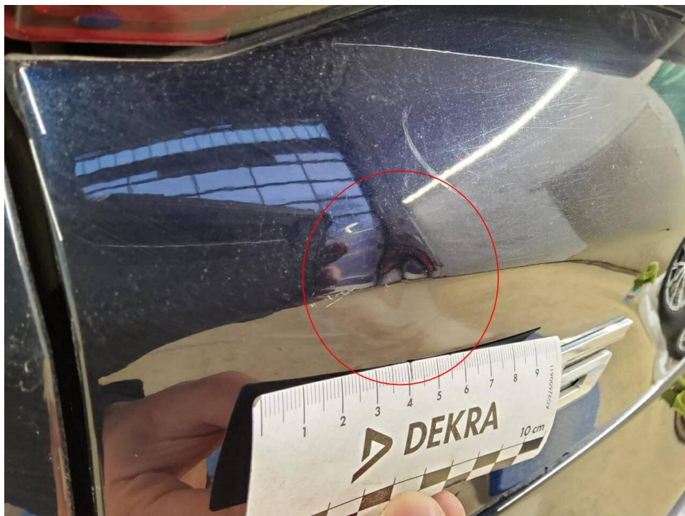
Bild 24 : Heckklappe, eingedellt, instandsetzen und lackieren mit Lackaufbau
