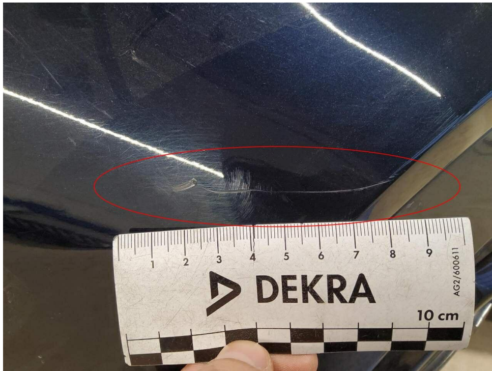
Bild 21 : Stoßfänger hinten Lackierung, zerkratzt, smart repair
