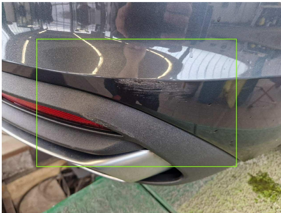
Bild 15 : Stoßfänger hinten zerkratzt Heckschürze zerkratzt
