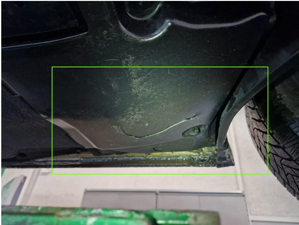
Bild 19 : Unterbodenverkleidung vorne links zerbrochen
