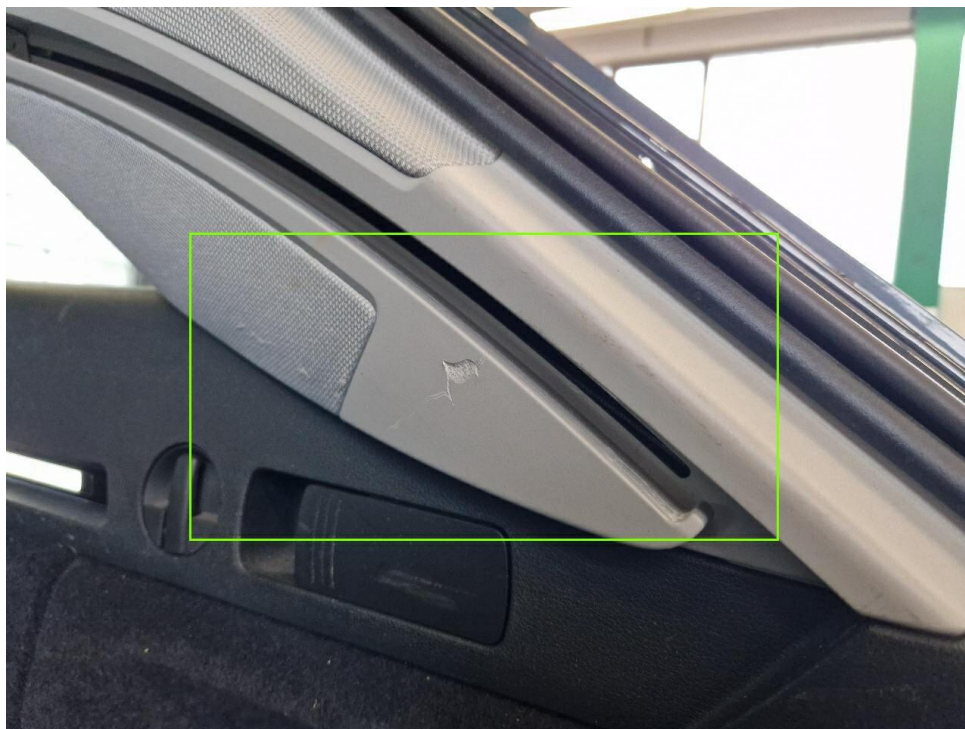
Bild 17 : Verkleidung Kofferraum rechts zerkratzt
