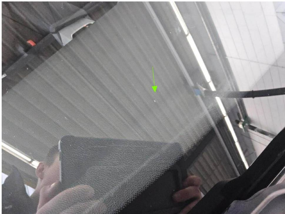
Bild 12 : Frontscheibe, Steinschlag, Gebrauchsspur
