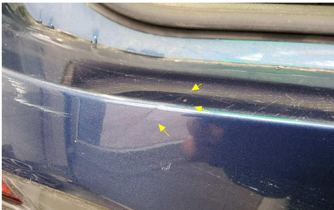
Bild 32 : Stoßfänger hinten plastisch verformt
