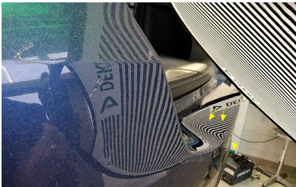
Bild 30 : Stoßfänger hinten plastisch verformt
