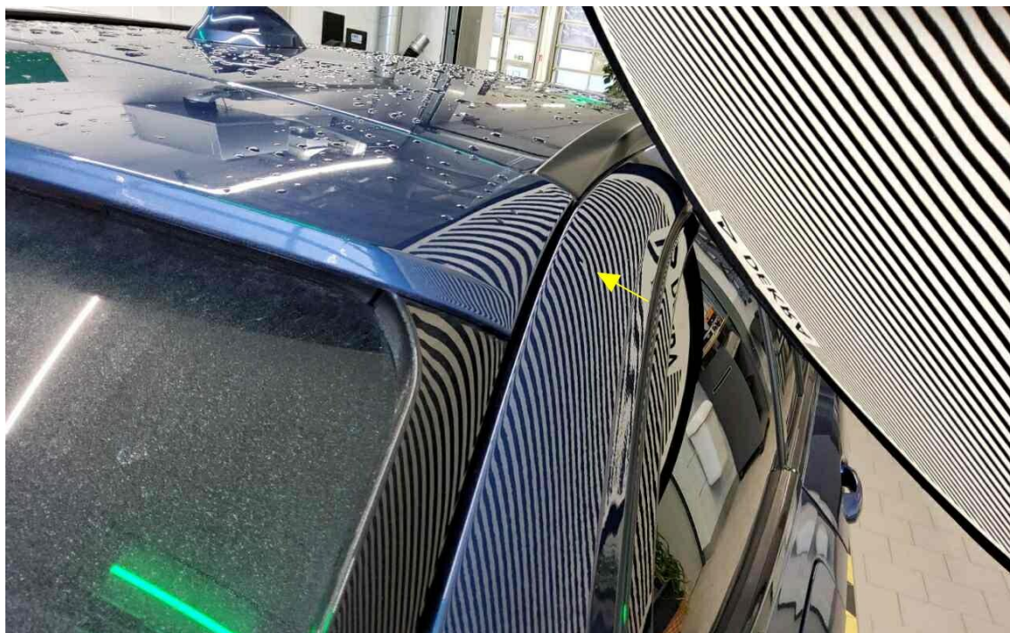
Bild 19 : Dachrahmen rechts, eingedellt, drücken
