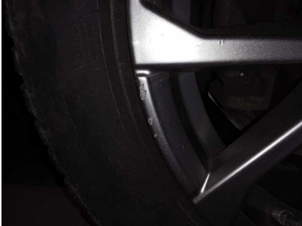
Beschädigung #3: Rad/Reifen: Leichtmetallfelge vorn rechts - verkratzt / verschürft - Smart Repair
