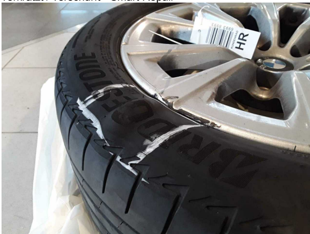
Beschädigung #4: 2.Radsatz: 1 Reifen - beschädigt - erneuern
