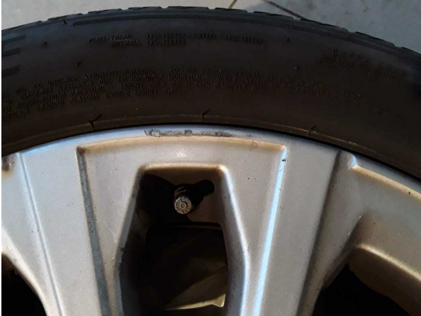
Beschädigung #1: 2.Radsatz: 1 Leichtmetallfelge - verkratzt / verschürft - Smart Repair
