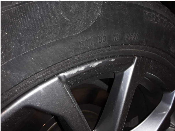
Beschädigung #2: Rad/Reifen: Leichtmetallfelge hinten rechts - verkratzt / verschürft - Smart Repair
