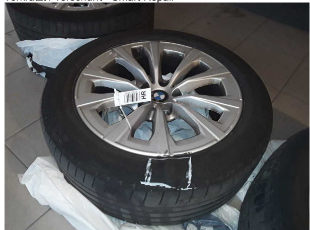
Beschädigung #4: 2.Radsatz: 1 Reifen - beschädigt - erneuern
