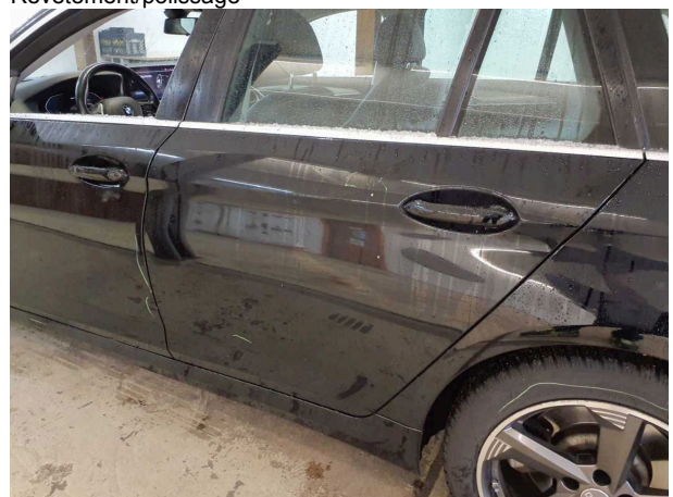
Domage #6: Porte ArG: Porte - Rayure(s) - Revêtement/ polissage
