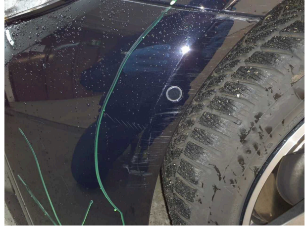
Domage #11: Pare-chocs avant: Pare-chocs avant - Dommages - Remplacer
