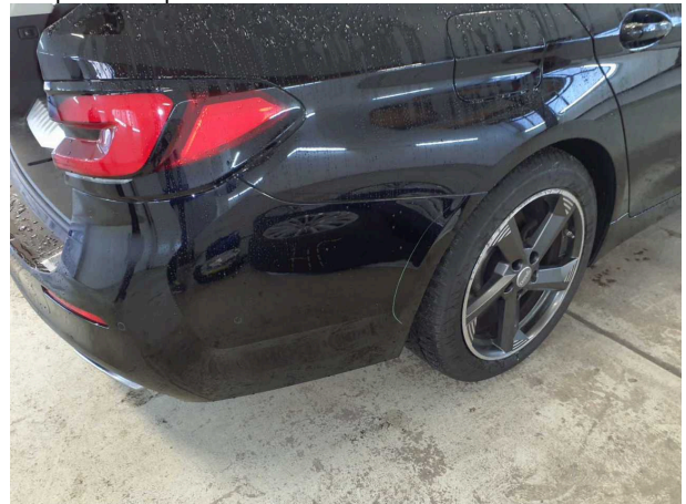
Domage #10: Pare-chocs arrière: Pare-chocs arrière - Erafilé - Réparer et repeindre
