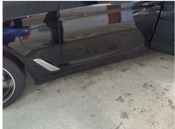
Damage #8: Seuil gauche: Habillage - Rayure(s) - Réparation intelligente
