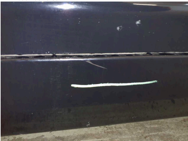
Damage #8: Seuil gauche: Habillage - Rayure(s) - Réparation intelligente
