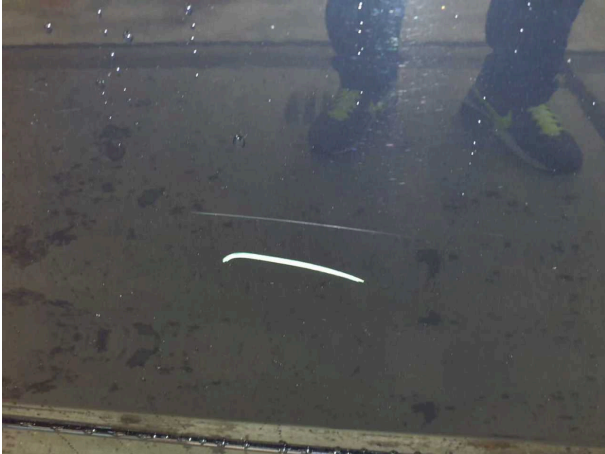
Damage #6: Porte ArG: Porte - Rayure(s) - Revêtement/ polissage
