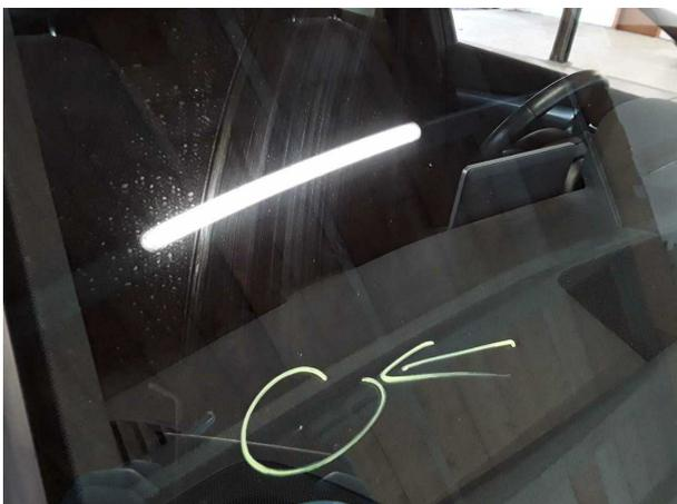
**Domage #5:** Vitrage: Pare-brise (Rissbildung) - Dommage causé par des cailloux - Remplacer
