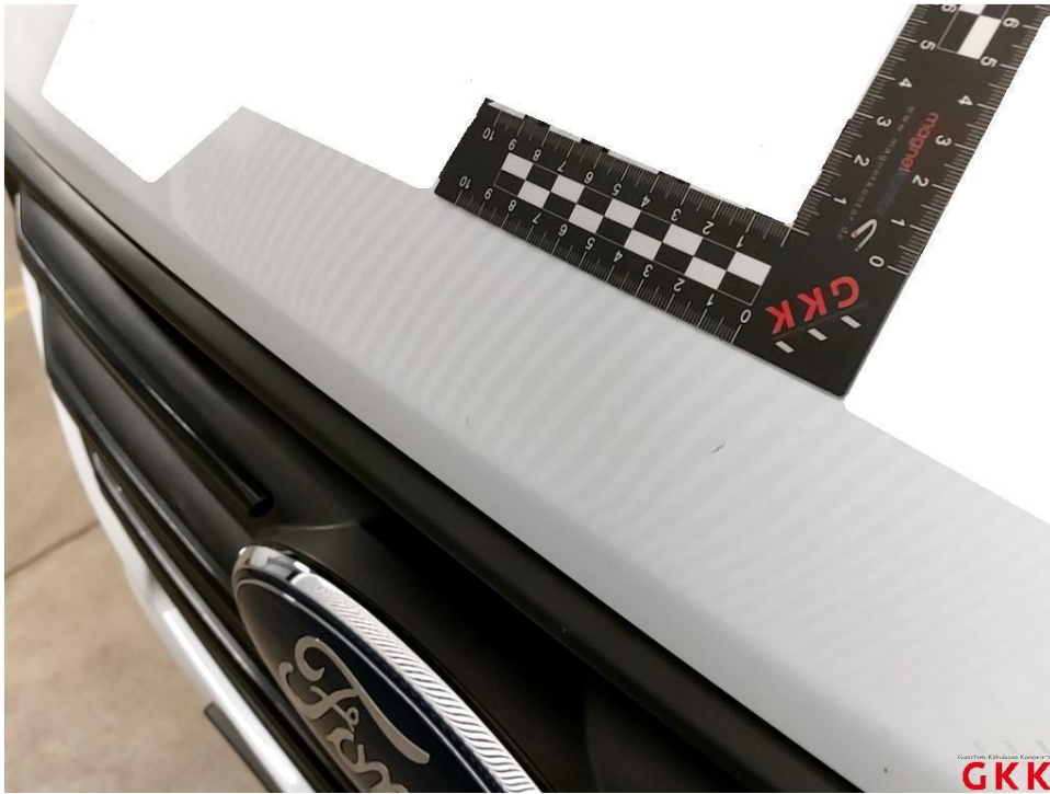
Bild 17 Motorhaube, beschädigt, instand setzen - lackieren
