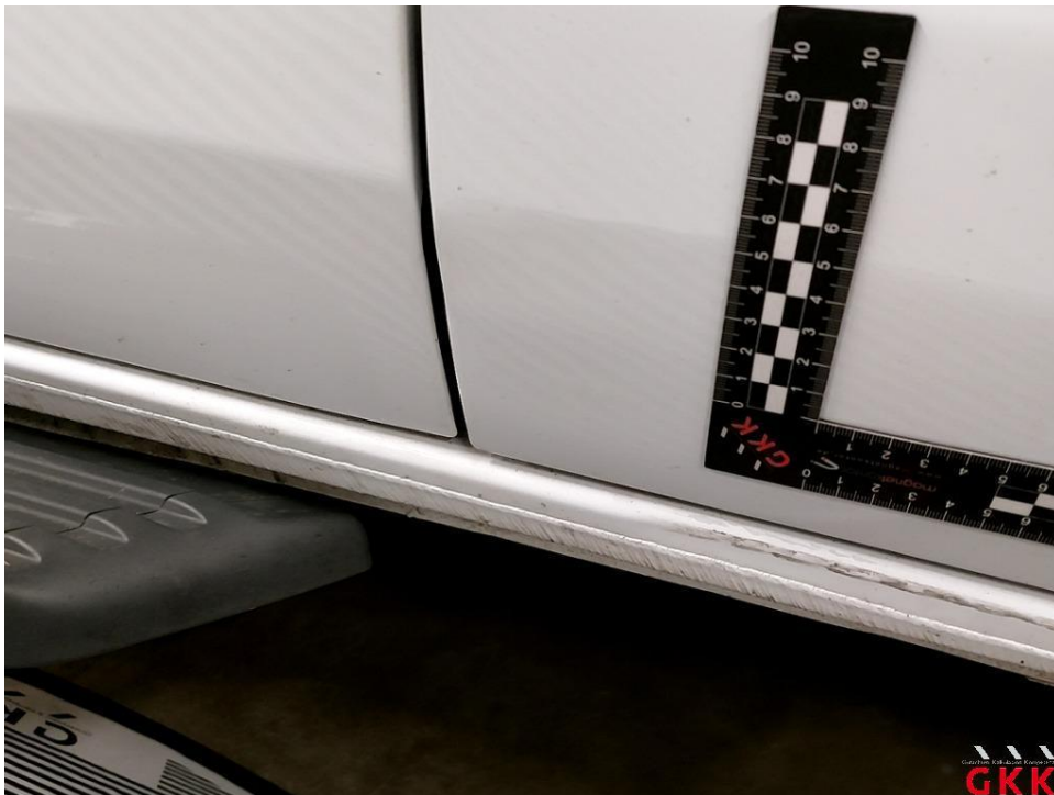
Bild 26 Tür vorne rechts, beschädigt, instand setzen - lackieren
