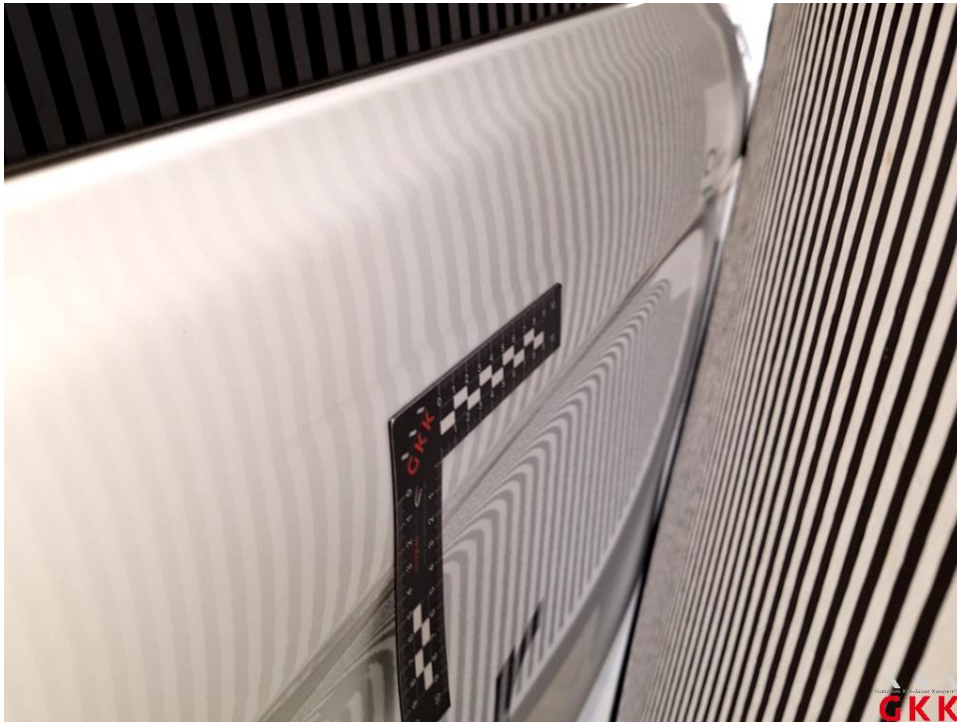
Bild 15 Seitenwand links, beschädigt, kalt drücken
