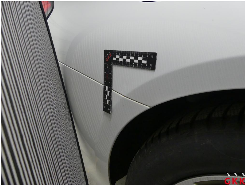
Bild 18 Seitenwand rechts, beschädigt, instand setzen
