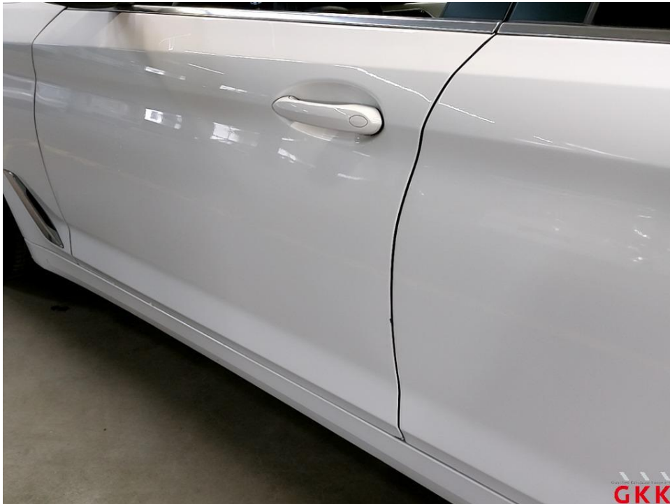
Bild 23 Tür vorne links, Kante, beschädigt, auslegen, schleifen, polieren
