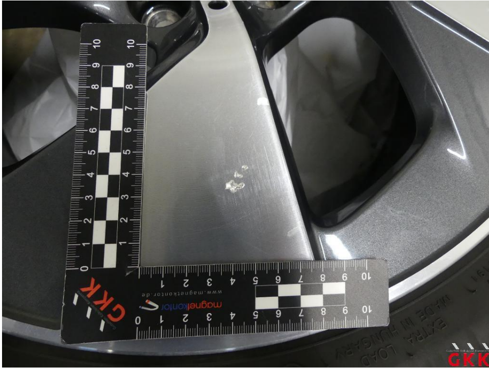
Bild 17 LM-Rad, 1 x beiliegend, beschädigt, ersetzen
