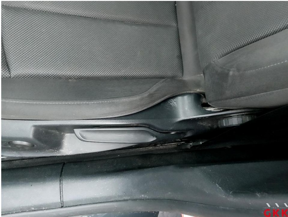
Bild 18. Sitz vorne links, Verkleidung, verkratzt, ersetzen
