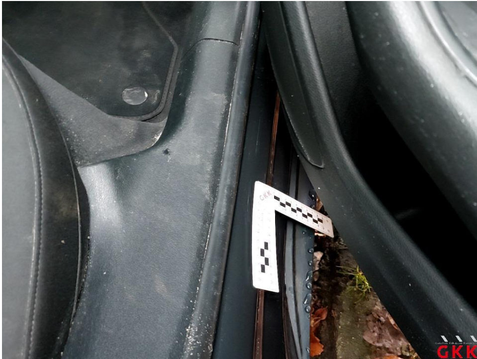
Bild 13. Tür hinten rechts, Einstieg, verkratzt, Smartrepair
