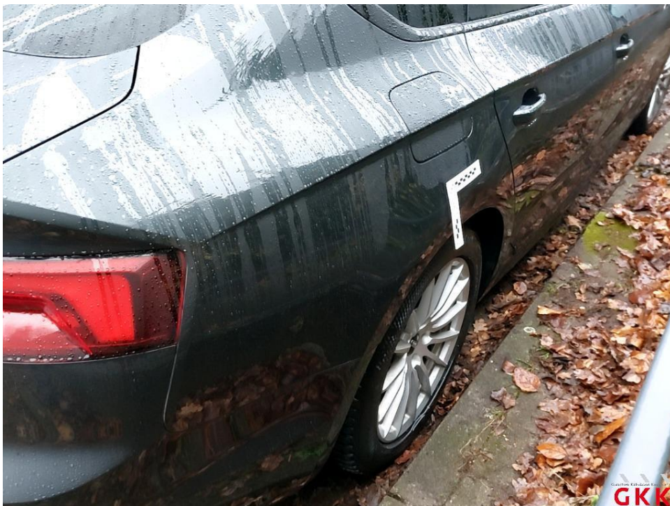
Bild 16. Seitenwand rechts, beschädigt, instand setzen - lackieren
