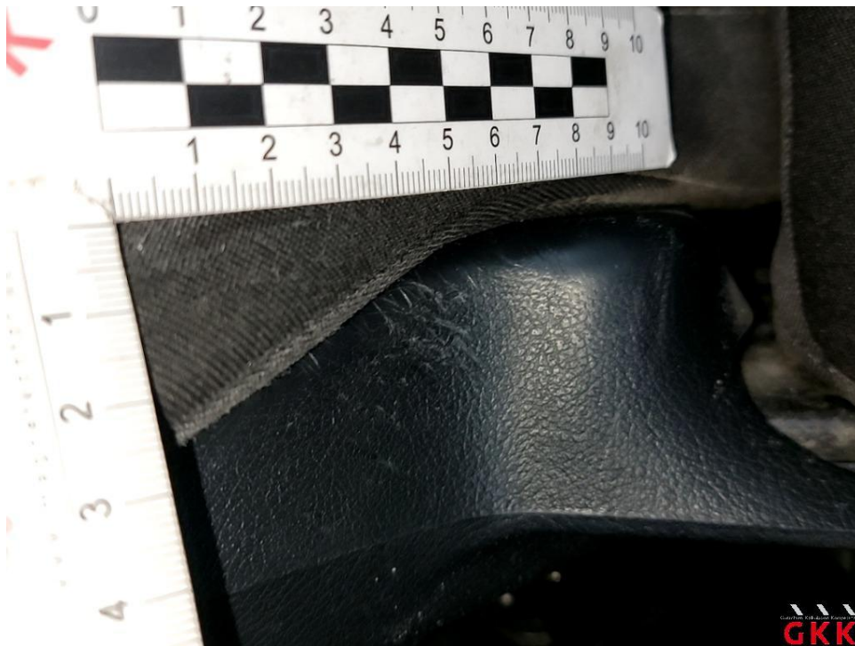
Bild 19. Sitz vorne links, Verkleidung, verkratzt, ersetzen
