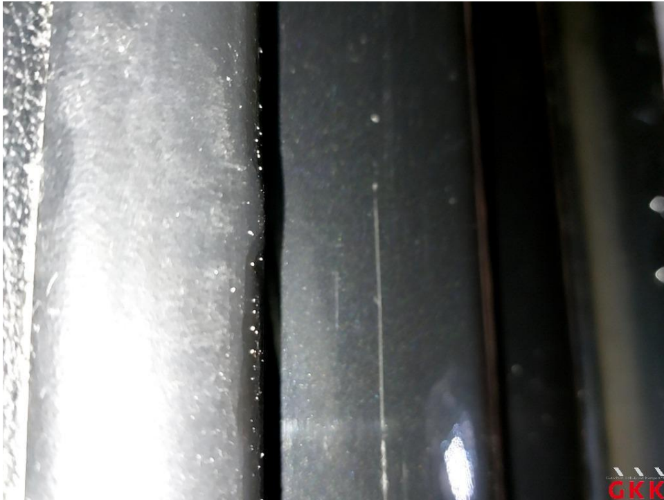
Bild 15. Tür hinten rechts, Einstieg, verkratzt, Smartrepair
