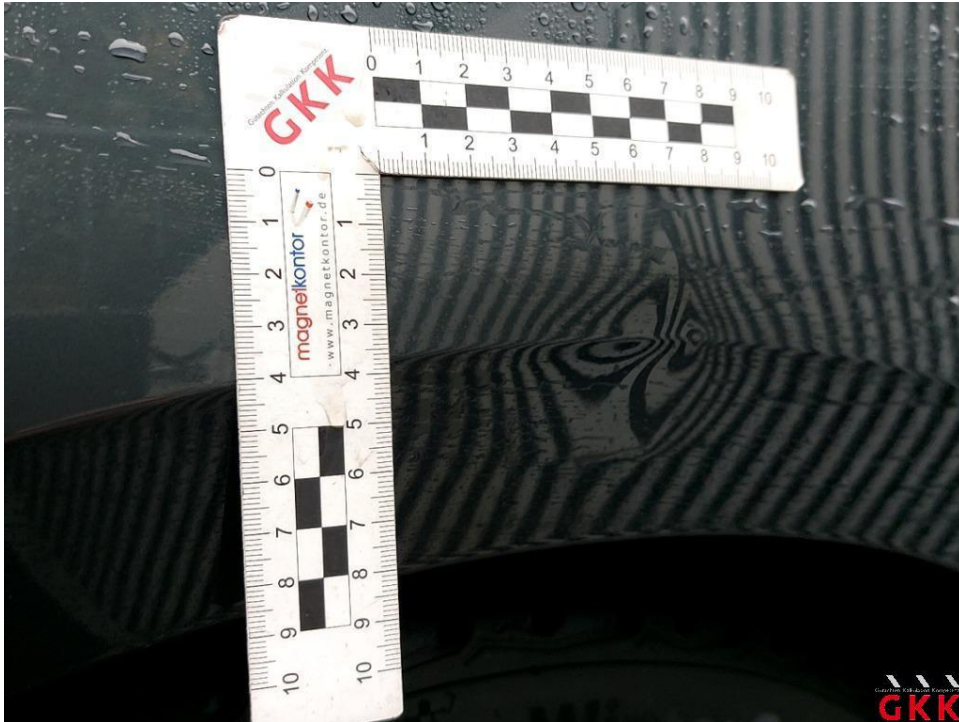
Bild 17. Seitenwand rechts, beschädigt, instand setzen - lackieren
