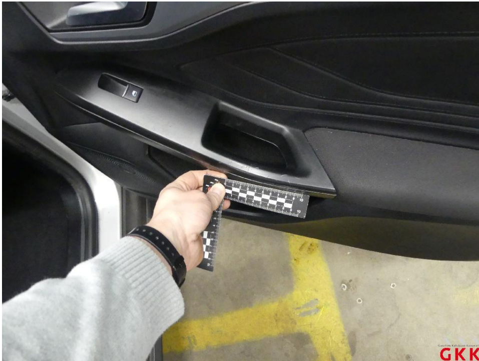
Bild 17 Tür vorne rechts, Innenverkleidung -Abdeckung-, verkratzt, ersetzen
