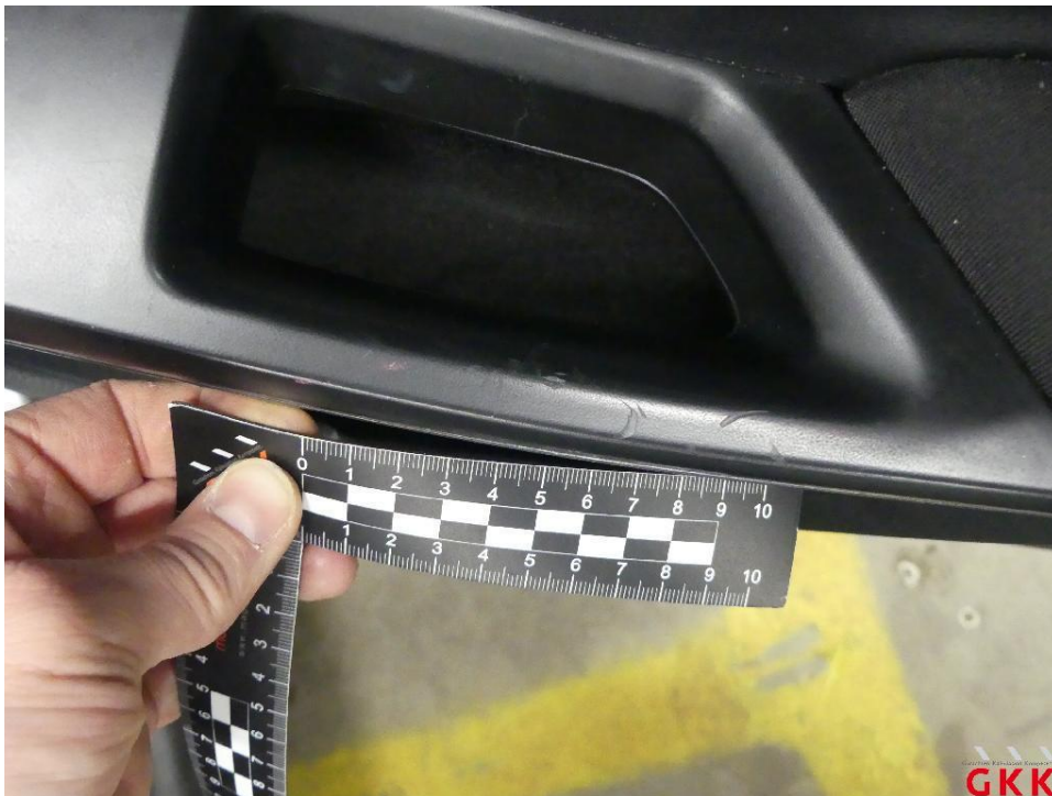
Bild 18 Tür vorne rechts, Innenverkleidung -Abdeckung-, verkratzt, ersetzen
