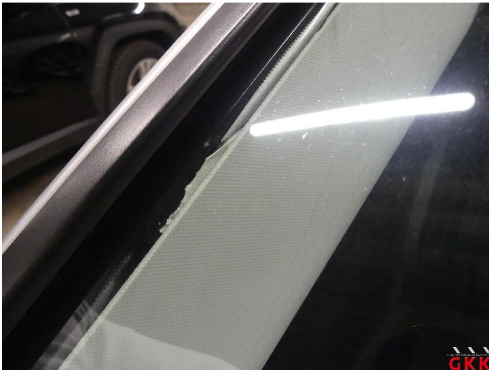
Bild 16 A- Säule rechts, Innenverkleidung, verschmutzt, reinigen
