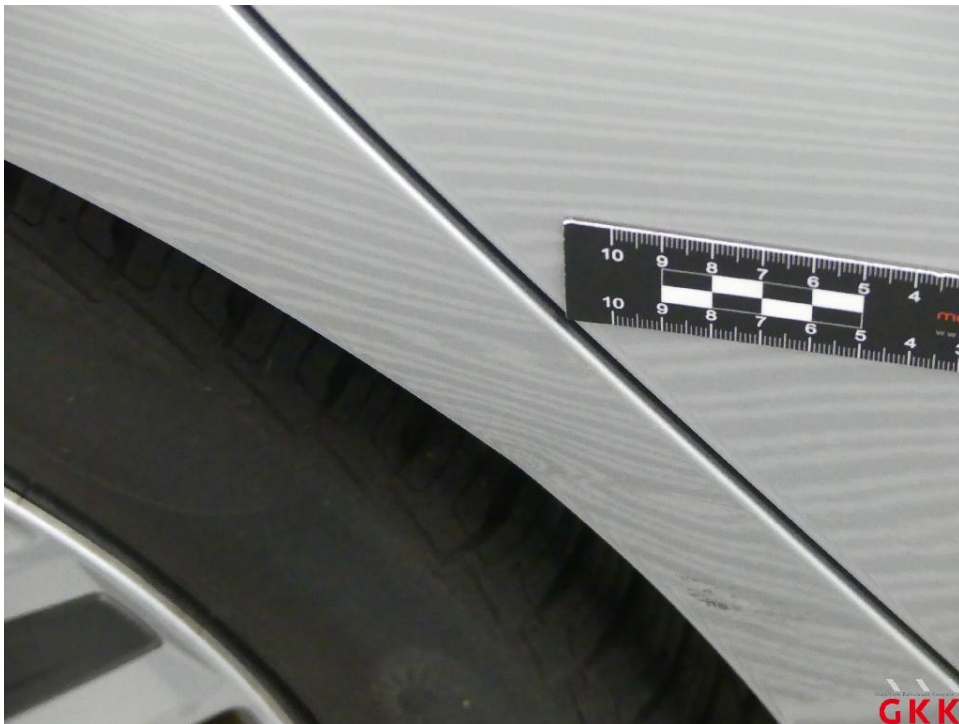
Bild 24 Seitenwand rechts, beschädigt, instand setzen - lackieren
