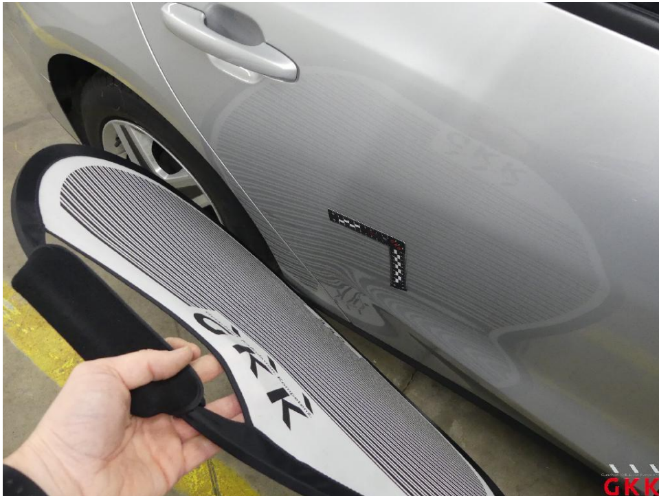
Bild 19 Tür hinten rechts, beschädigt, instand setzen - lackieren
