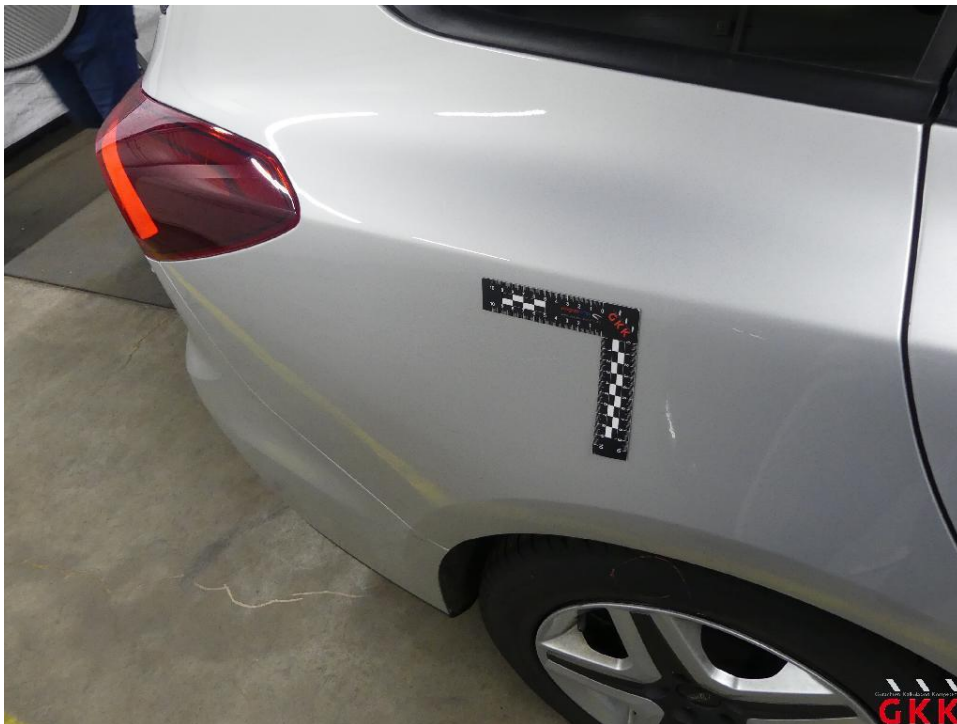
Bild 22 Seitenwand rechts, beschädigt, instand setzen - lackieren
