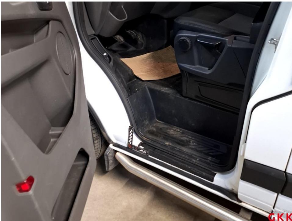
Bild 18 Tür vorne links, Einstiegsleiste, beschädigt, ersetzen
