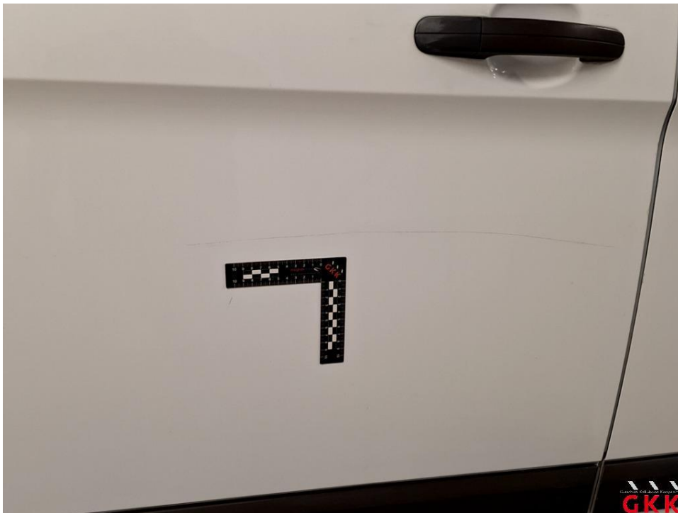
Bild 26 Schiebetür rechts, beschädigt, instand setzen - lackieren
