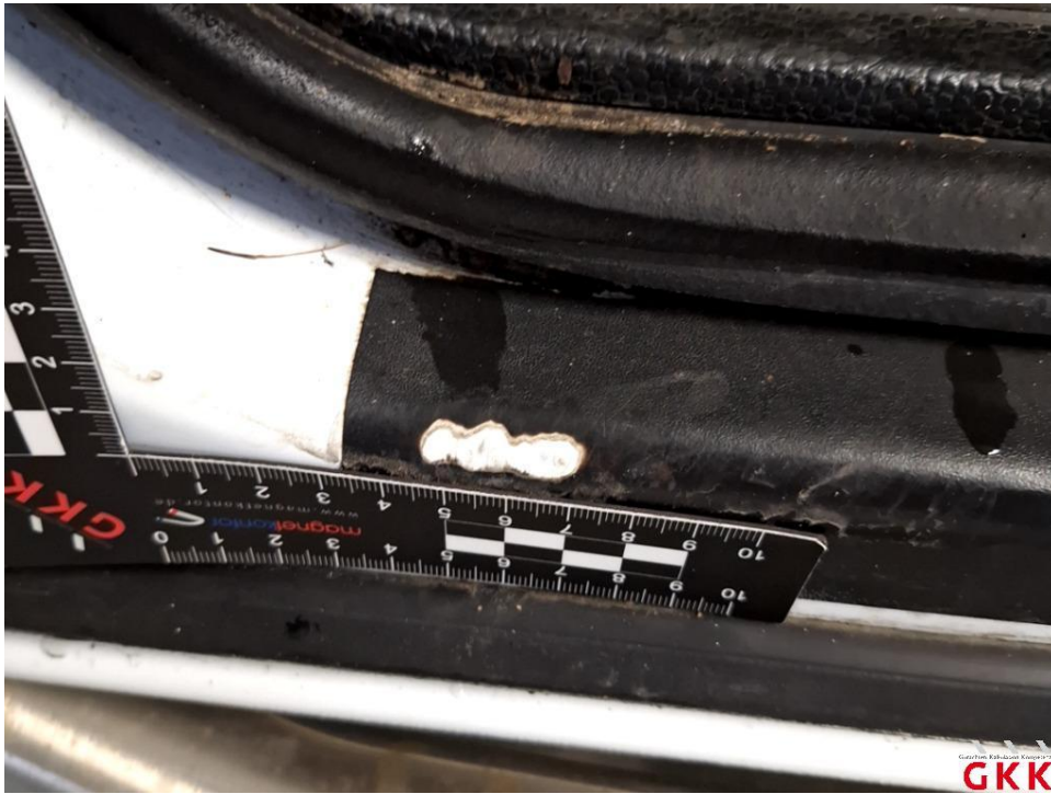
Bild 19 Tür vorne links, Einstiegsleiste, beschädigt, ersetzen
