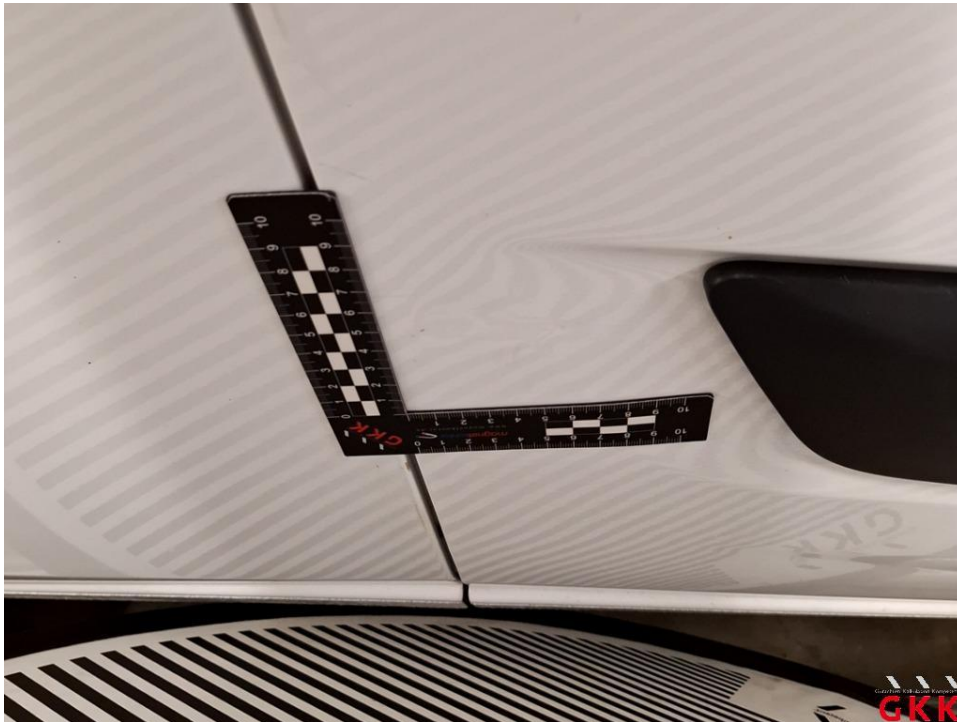
Bild 25 Schiebetür rechts, beschädigt, instand setzen - lackieren
