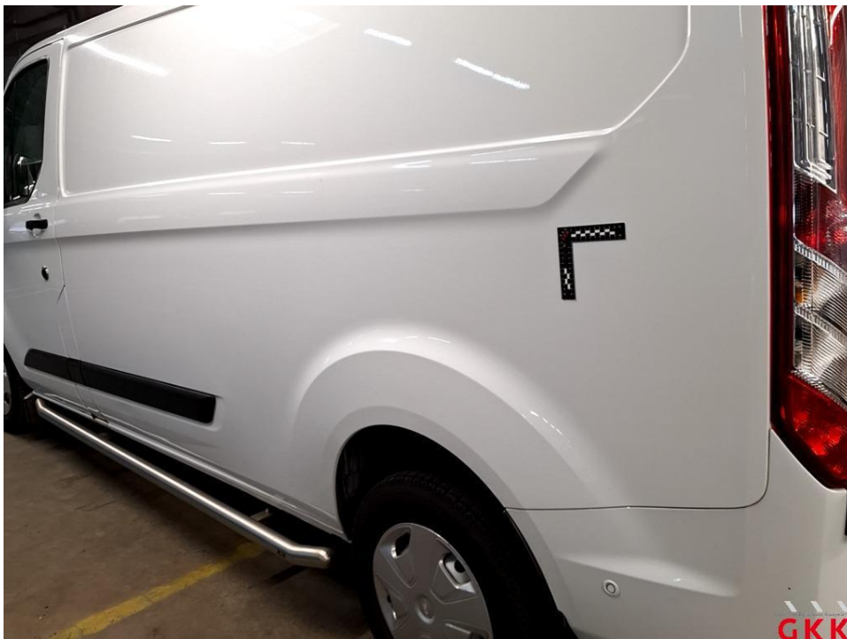
Bild 14 Seitenwand links, beschädigt, kalt drücken
