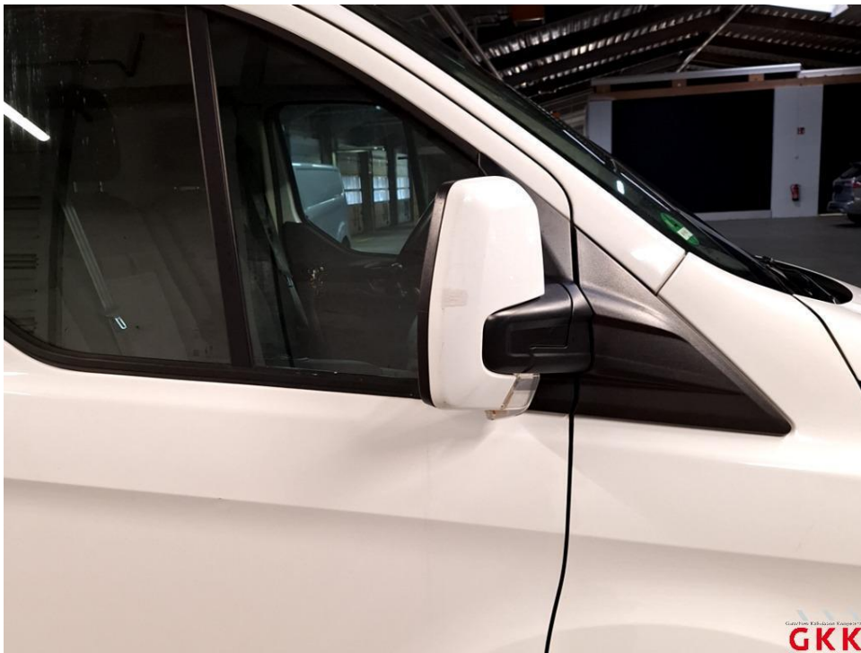
Bild 20 Spiegelgehäuse rechts, Blende -lackiert-, verkratzt, lackieren ohne LV
