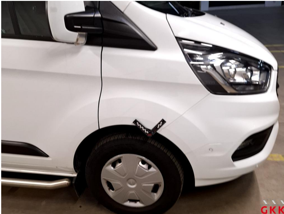
Bild 29 Kotflügel vorne rechts, verkratzt, lackieren
