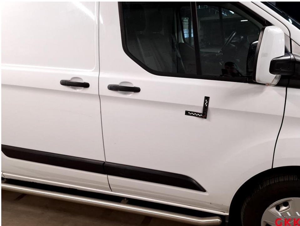
Bild 22 Tür vorne rechts, beschädigt, kalt drücken
