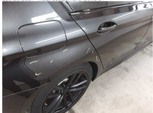
Beschädigung #11: Seitenwand rechts: Seitenwand - verkratzt / verschürft - instandsetzen und lackieren
