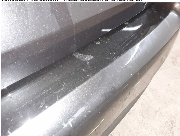
Beschädigung #9: Stossfänger hinten: Stossfänger hinten - verkratzt / verschürft - instandsetzen und lackieren
