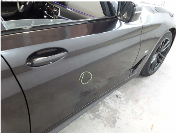
Beschädigung #5: Tür vorn rechts: Tür - Delle(n) - sanft instandsetzen
