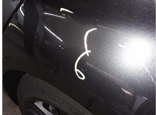
Beschädigung #10: Seitenwand links: Seitenwand - Delle / Lackschaden - instandsetzen und lackieren
