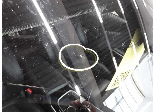
Domage #1: Vitrage: Pare-brise avec système d'avertissement de sortie de voie (mit Rissbildung zu nah am
