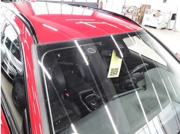
Domage #1: Vitrage: Pare-brise avec système d'avertissement de sortie de voie (mit Rissbildung zu nah am Rand) - Dommage
