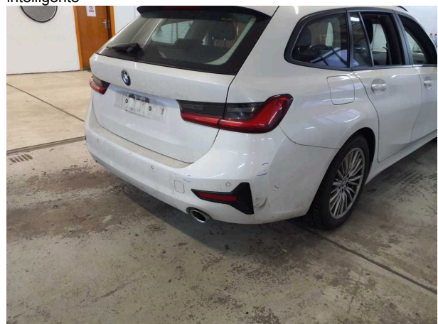
Dommage #5: Pare-chocs arrière: Pare-chocs arrière - Eraflé - Peinture
