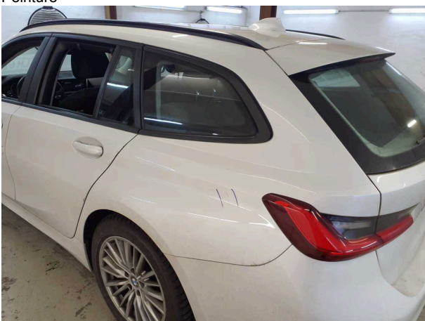
Domage #6: Panneau latéral arrière gauche: Paroi latérale - Erafilé - Peinture
