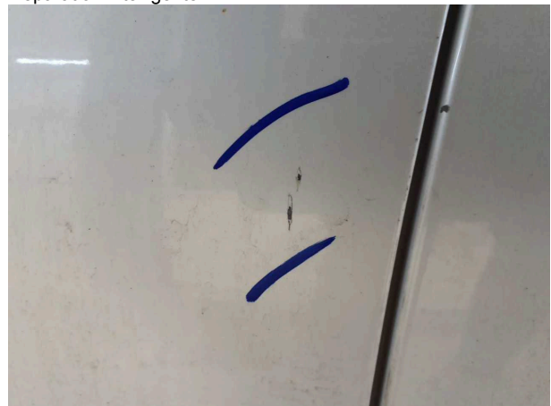
Dommage #3: Porte AvG: Porte - Eraflé - Réparation intelligente
