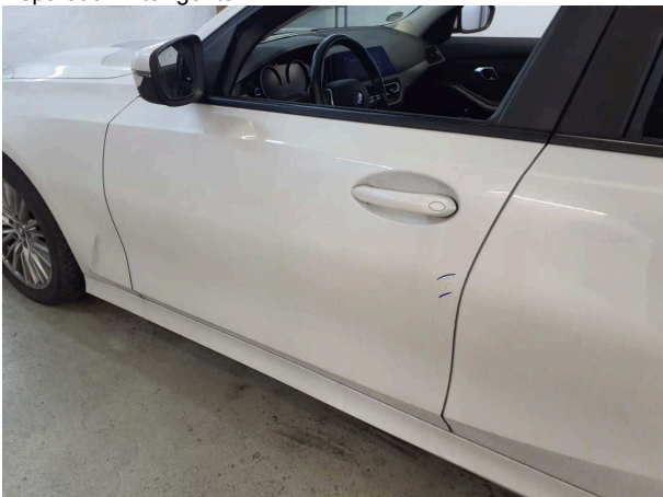
Dommage #3: Porte AvG: Porte - Eraflé - Réparation intelligente
