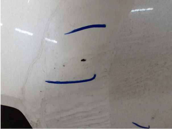
Domage #5: Pare-chocs arrière: Pare-chocs arrière - Erafilé - Peinture
