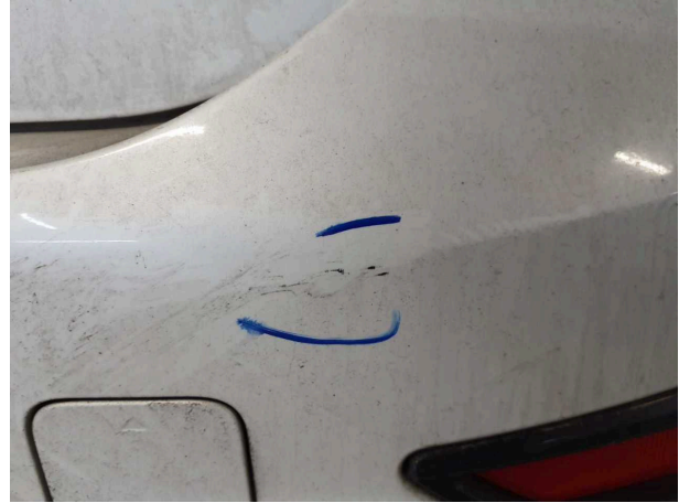
Domage #5: Pare-chocs arrière: Pare-chocs arrière - Erafilé - Peinture
