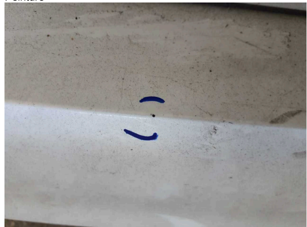
Domage #5: Pare-chocs arrière: Pare-chocs arrière - Erafilé - Peinture
