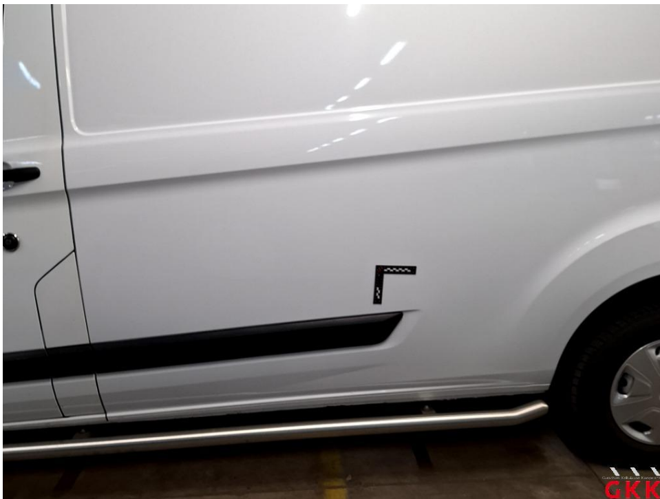
Bild 14 Seitenwand links, Lackierung abgeplatzt, auslegen, schleifen, polieren
