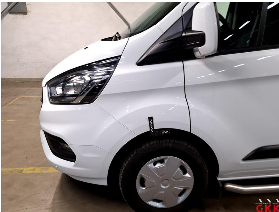
Bild 20 Kotflügel vorne links, beschädigt, instand setzen - lackieren
