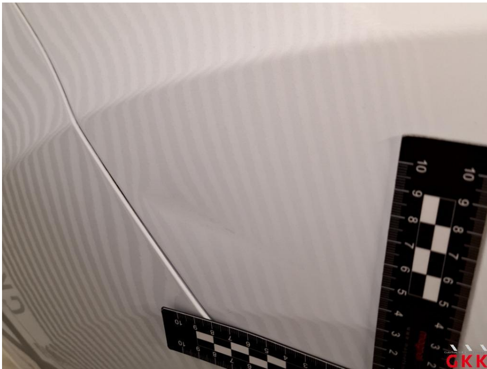
Bild 22 Kotflügel vorne links, beschädigt, instand setzen - lackieren
