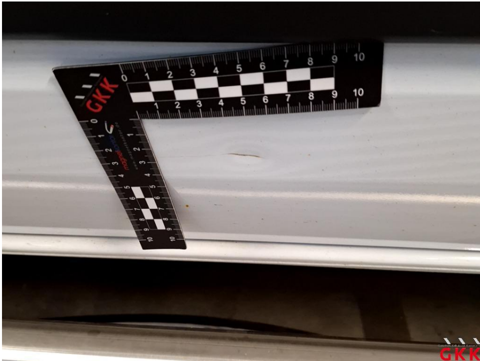
Bild 17 Tür vorne links, beschädigt, instand setzen - lackieren
