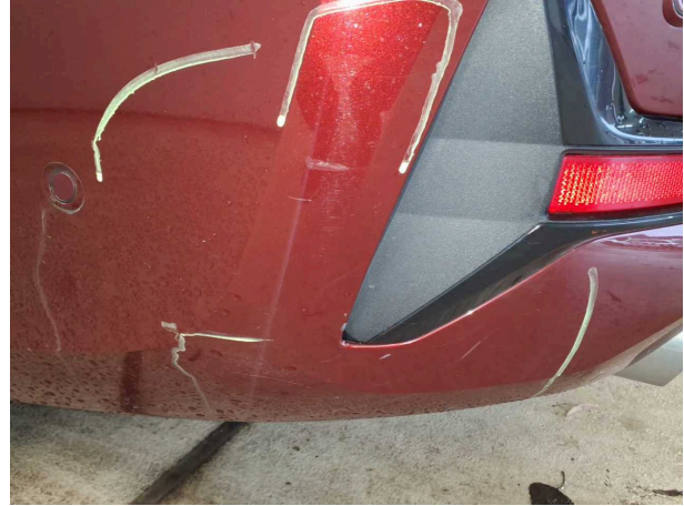
Domage #4: Pare-chocs arrière: Pare-chocs arrière - Eraflé - Réparer et repeindre
