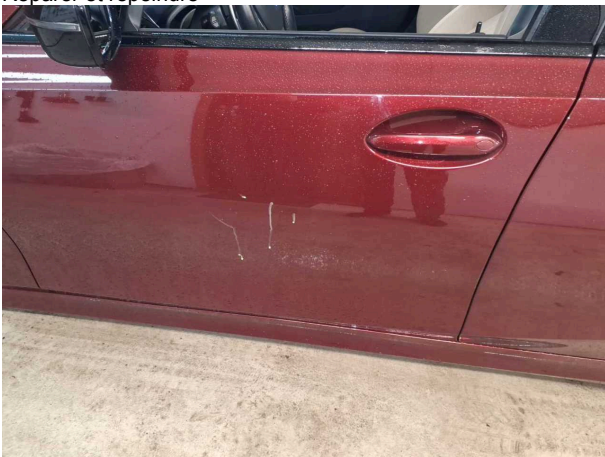
Domage #5: Porte AvG: Porte - Eraflé - Réparer et repeindre
