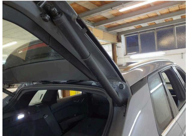
**Beschädigung #2:** Heckklappe/-tür: Gasdruckdämpfer - verschlissen - erneuern
