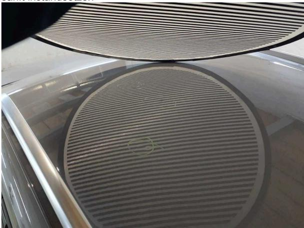
**Beschädigung #4:** Fahrzeugdach: Dach - Hagelschaden - sanft instandsetzen
