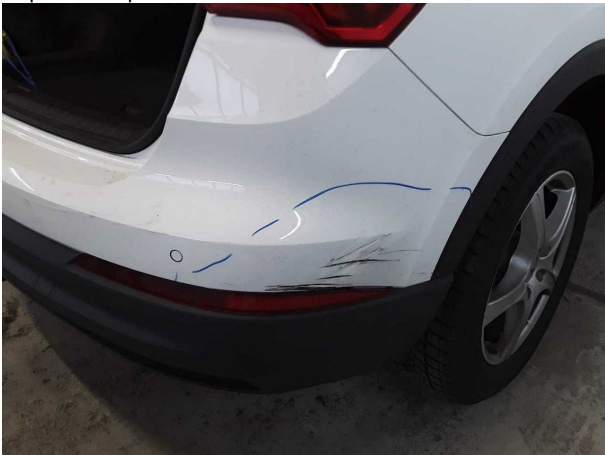
Domage #3: Pare-chocs arrière: Pare-chocs arrière (Stark verkratzt) - Déformé - Remplacer
