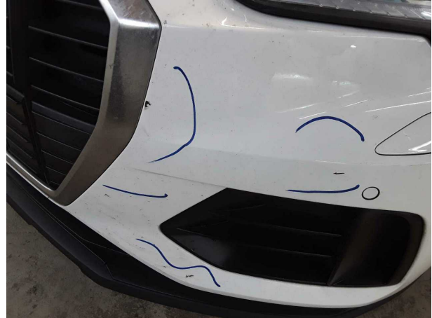
Domage #2: Pare-chocs avant: Pare-chocs avant - Erafilé - Réparer et repeindre
