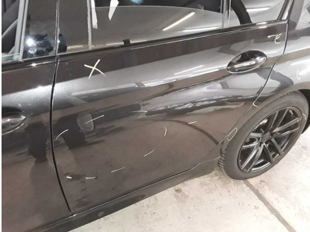
Domage #4: Porte ArG: Porte - Rayure(s) - Revêtement/ polissage
