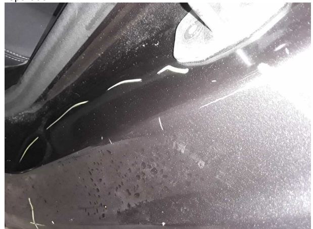
Domage #6: Panneau latéral arrière gauche: Accès - Erafilé - Réparation intelligente
