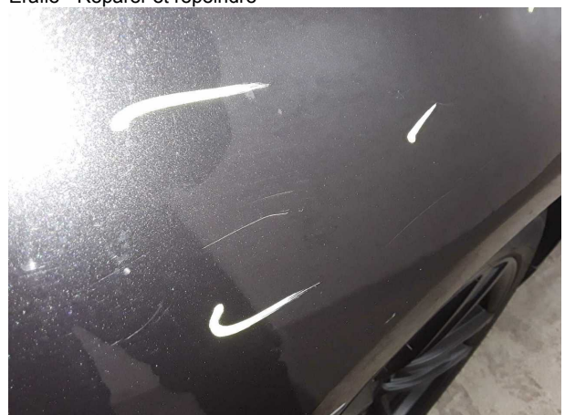
Domage #11: Panneau latéral arrière droit: Paroi latérale - Eraflé - Réparer et repeindre
