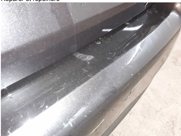
Domage #9: Pare-chocs arrière: Pare-chocs arrière - Erafilé - Réparer et repeindre
