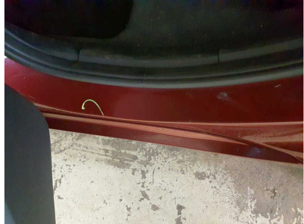
Domage #4: Panneau latéral arrière gauche: Accès - Erafilé - Réparation intelligente
