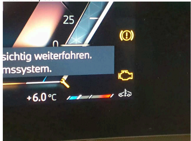
Domage #7: Systèmes électroniques: Systèmes électroniques (Motorkontrollleuchte an) - Exigible - Etablir
