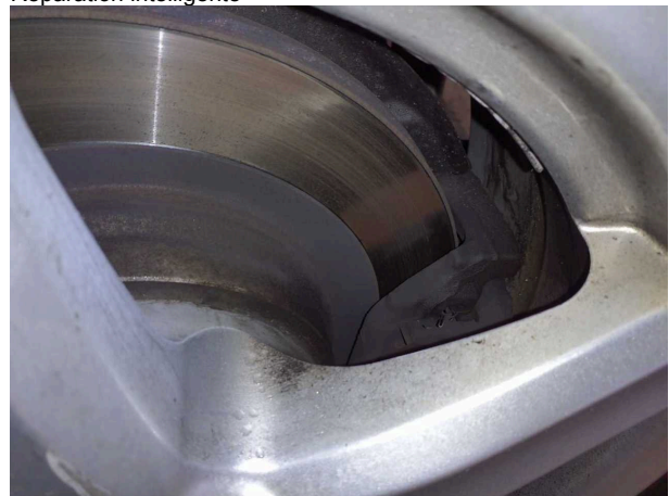
Domage #5: Système de freinage: Garnitures de frein arrière - Usé - Remplacer
