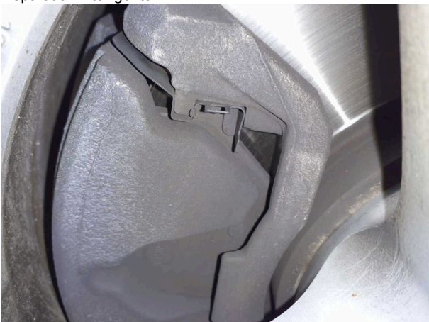
Domage #6: Système de freinage: Garnitures de frein avant - Usé - Remplacer
