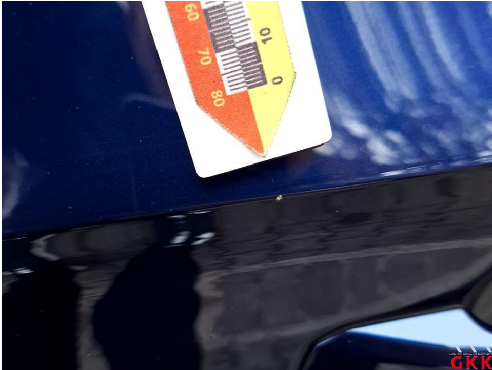
Bild 19. Tür hinten links, verkratzt, auslegen, schleifen, polieren
