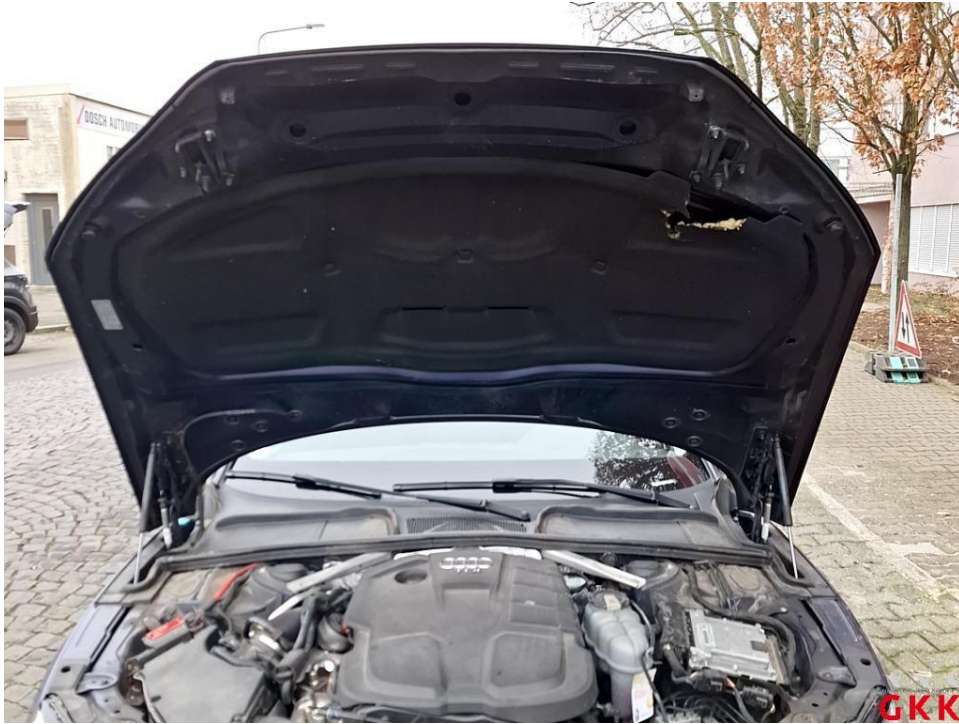
Bild 13. Motorhaube, Dämmmatte, beschädigt, ersetzen
