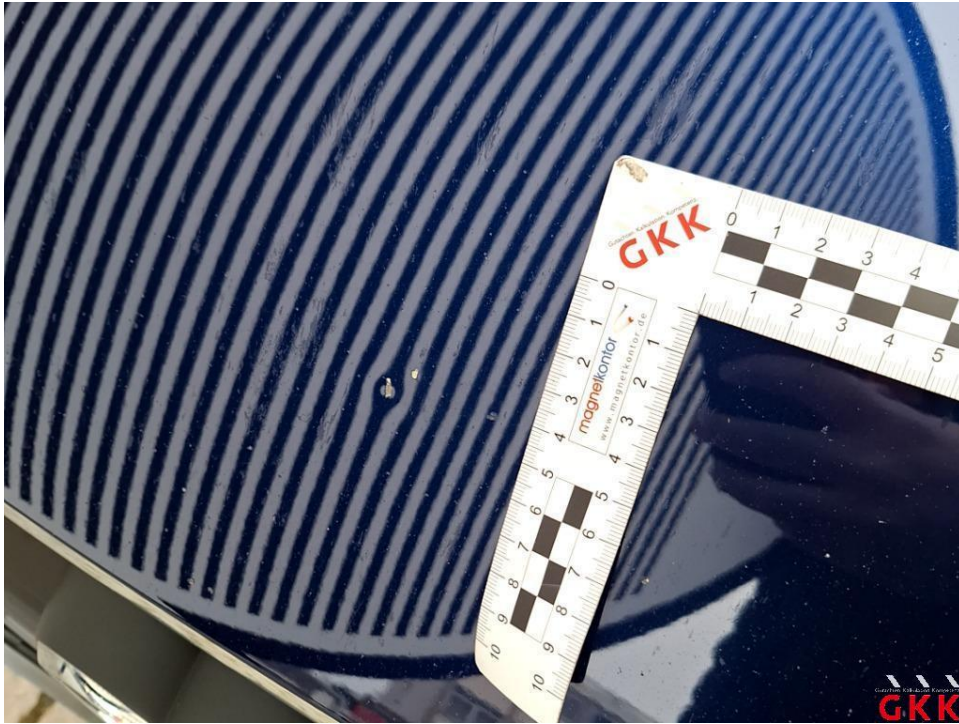
Bild 23. Motorhaube, beschädigt, instand setzen - lackieren
