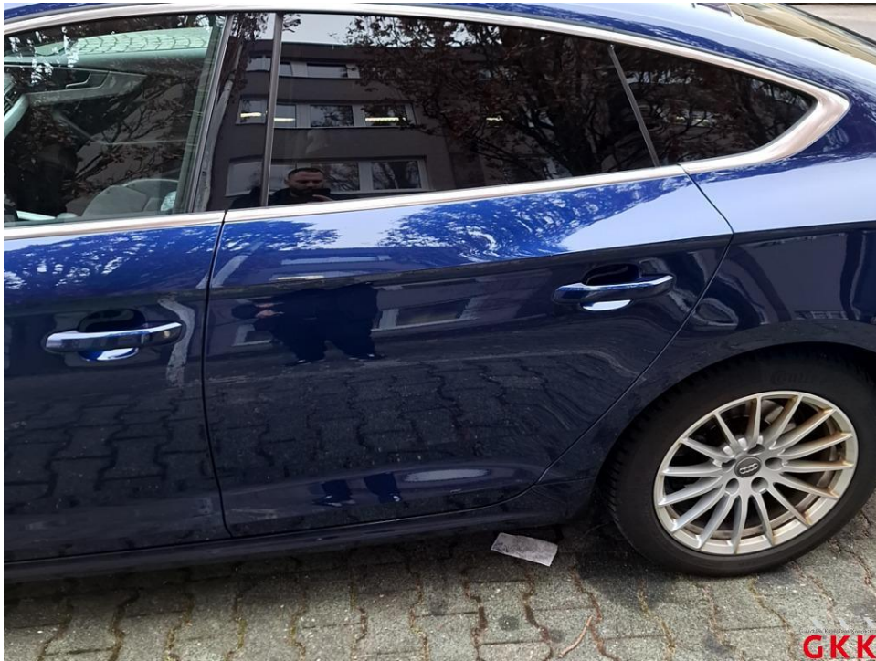
Bild 18. Tür hinten links, verkratzt, auslegen, schleifen, polieren
