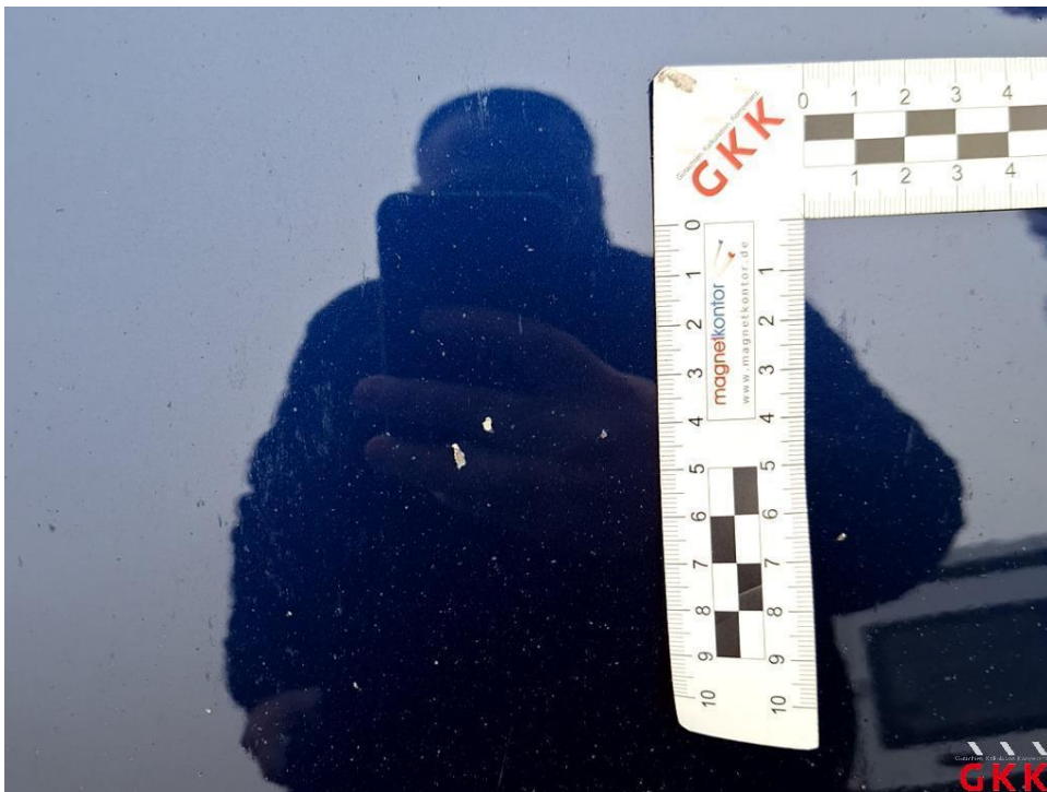
Bild 22. Motorhaube, beschädigt, instand setzen - lackieren
