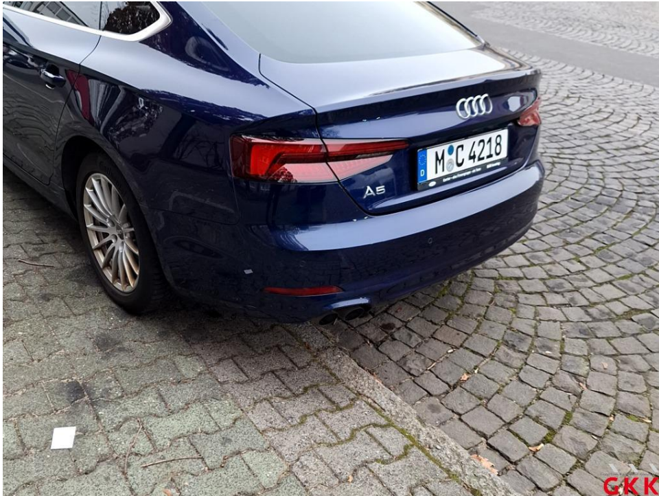
Bild 15. Stoßfänger hinten, Verkleidung -lackiert-, verkratzt, lackieren
