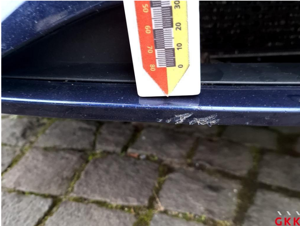
Bild 25. Stoßfänger vorne, Verkleidung -lackiert-, beschädigt, Smartrepair
