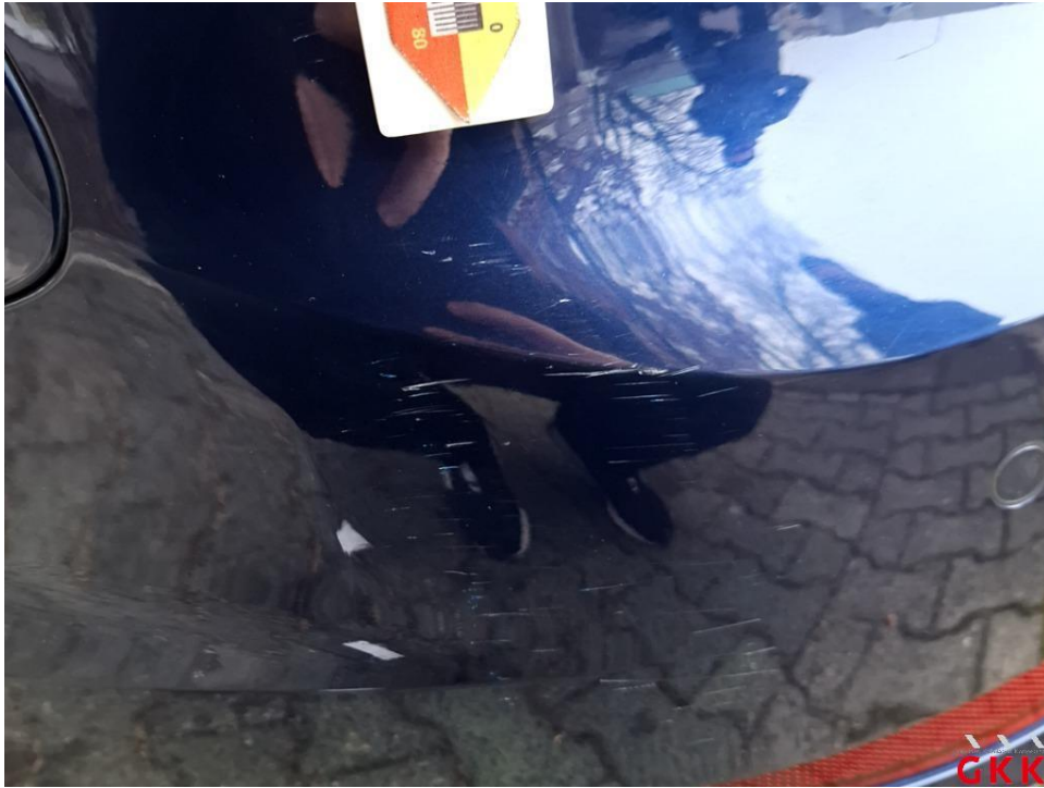
Bild 17. Stoßfänger hinten, Verkleidung -lackiert-, verkratzt, lackieren
