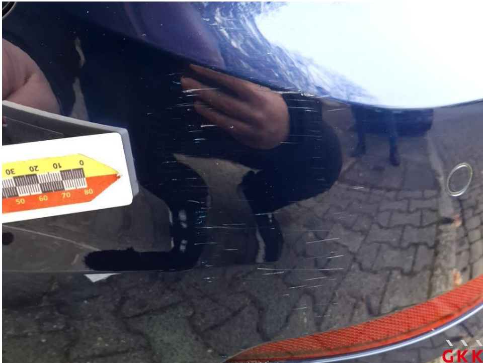
Bild 16. Stoßfänger hinten, Verkleidung -lackiert-, verkratzt, lackieren
