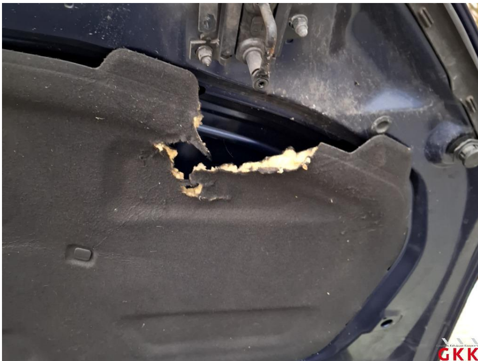
Bild 14. Motorhaube, Dämmmatte, beschädigt, ersetzen
