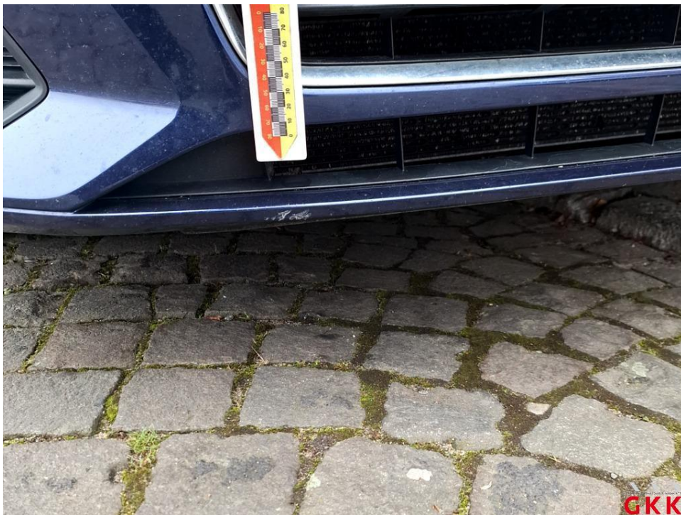
Bild 26. Stoßfänger vorne, Verkleidung -lackiert-, beschädigt, Smartrepair
