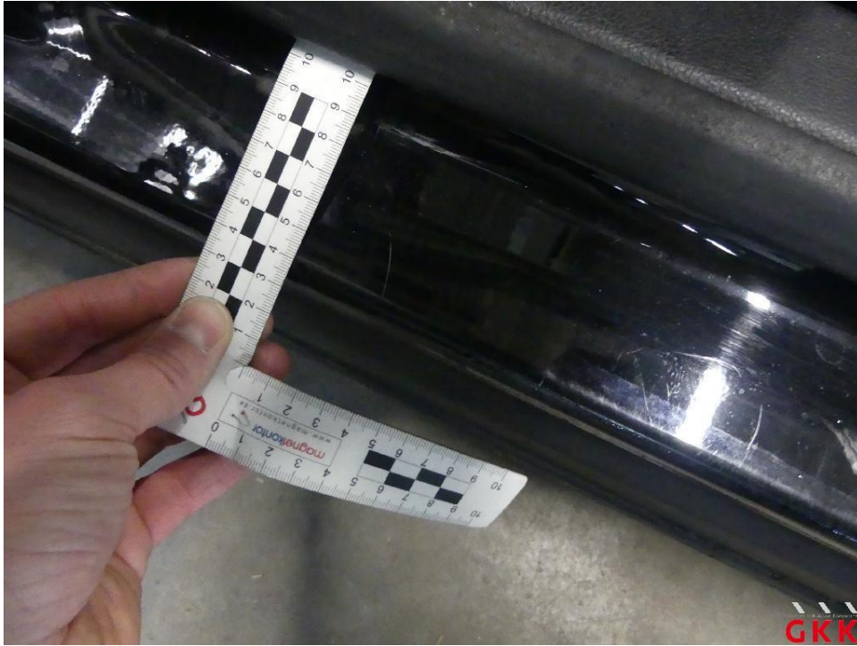
Bild 27 Tür vorne links, Einstieg, verkratzt, Smartrepair
