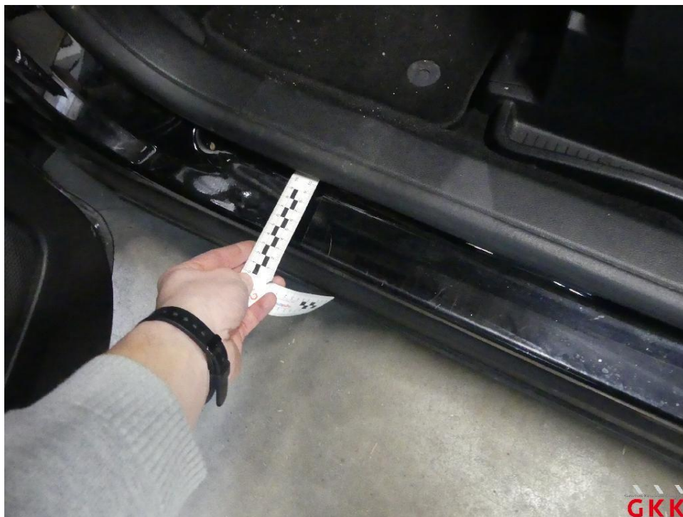
Bild 26 Tür vorne links, Einstieg, verkratzt, Smartrepair
