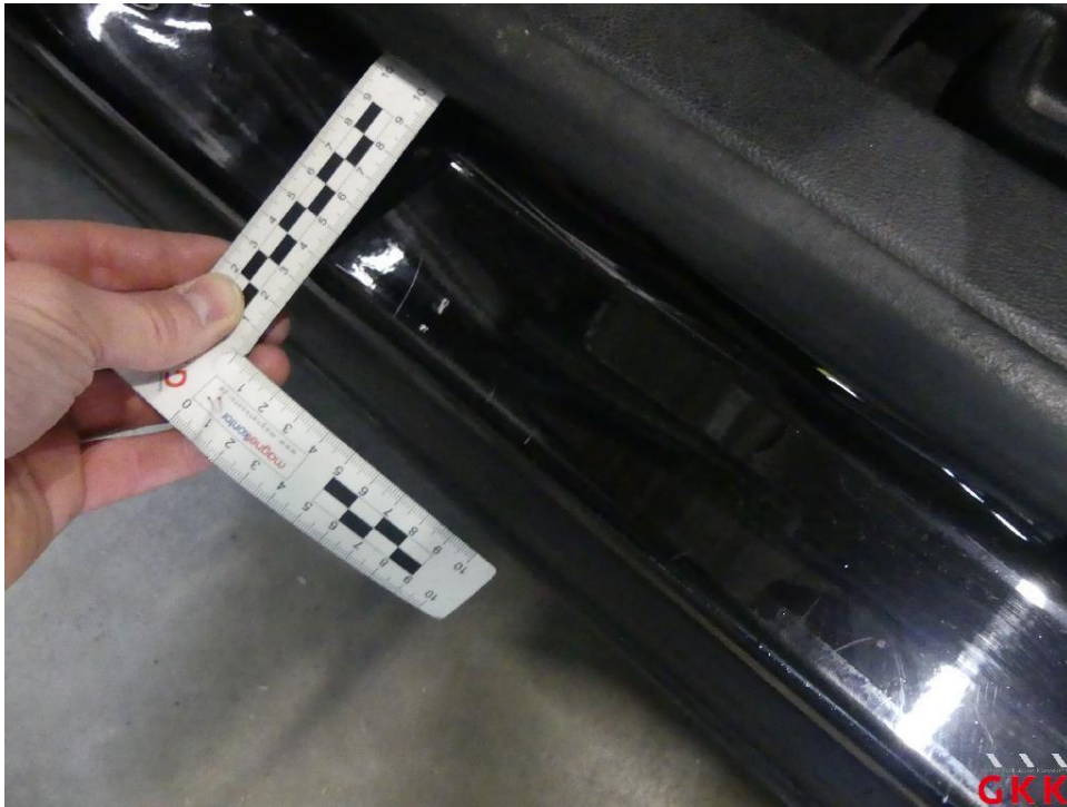
Bild 28 Tür vorne links, Einstieg, verkratzt, Smartrepair
