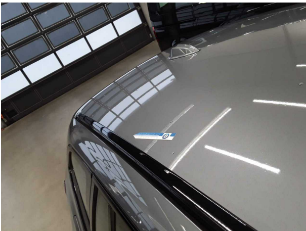
Domage #4: Toit: Toit - bosse(s) - Réparer et repeindre
