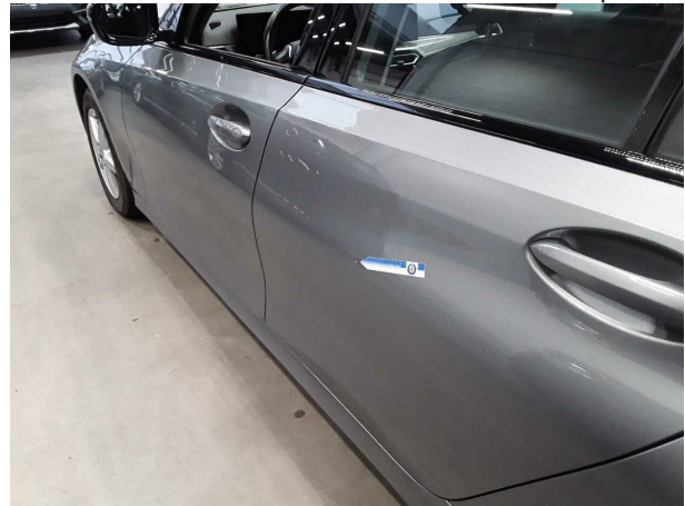
Domage #3: Porte ArG: Porte - Bosse, dommage peinture - Réparer et repeindre
