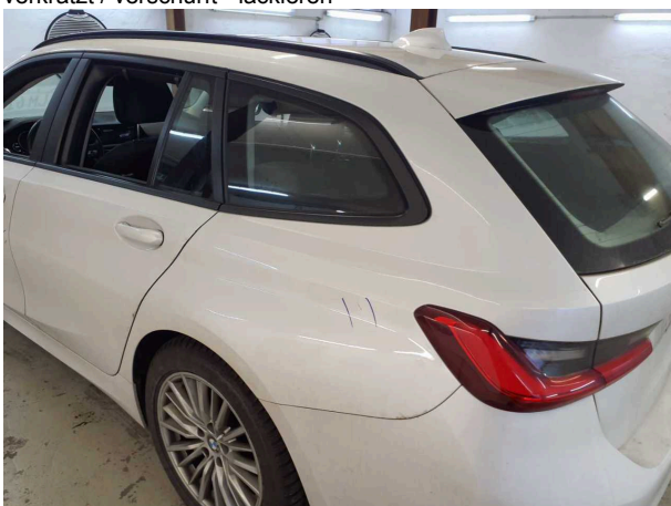
Beschädigung #6: Seitenwand links: Seitenwand - verkratzt / verschürft - lackieren
