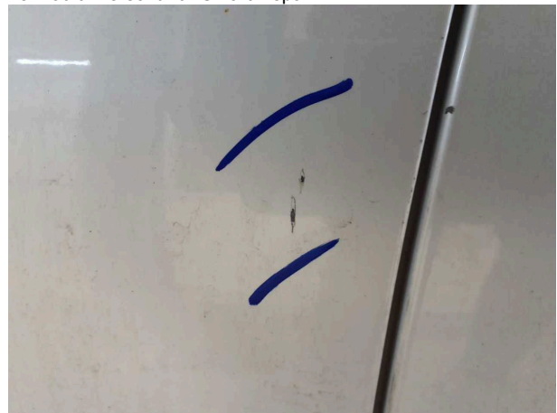
Beschädigung #3: Tür vorn links: Tür - verkratzt / verschürft - Smart Repair
