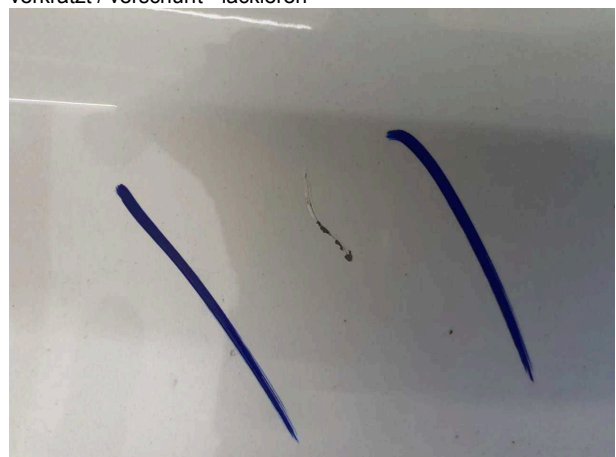
Beschädigung #6: Seitenwand links: Seitenwand - verkratzt / verschürft - lackieren
