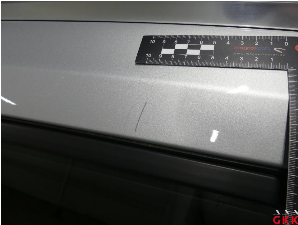
Bild 23 Dach, Holm rechts, verkratzt, lackieren
