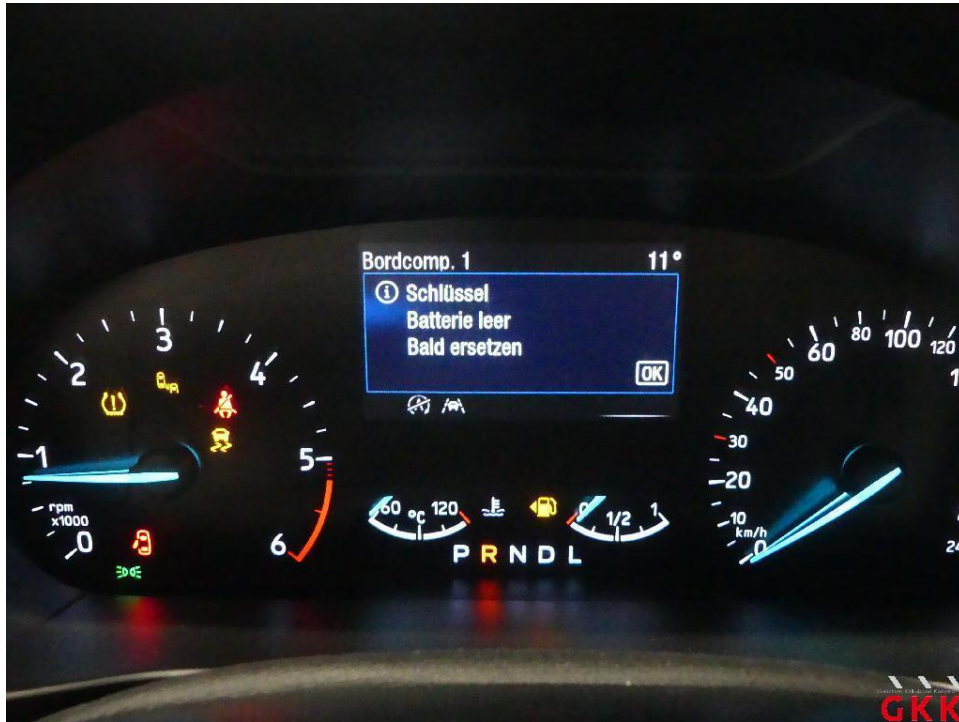
Bild 15 Hauptschlüssel, Batterie, entladen, ersetzen
