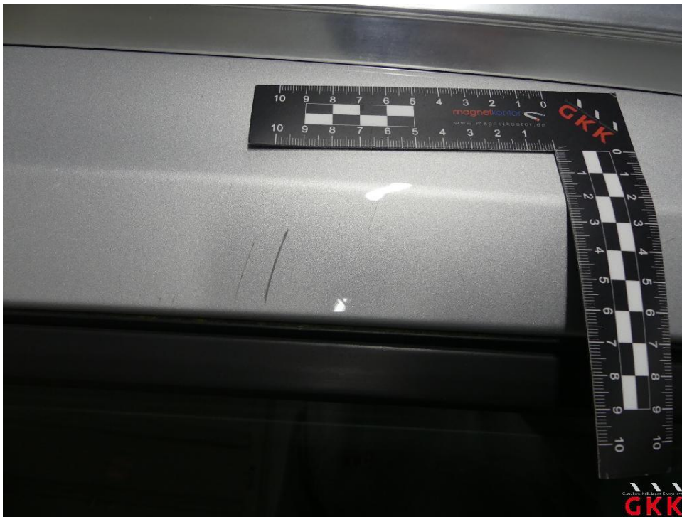
Bild 24 Dach, Holm rechts, verkratzt, lackieren
