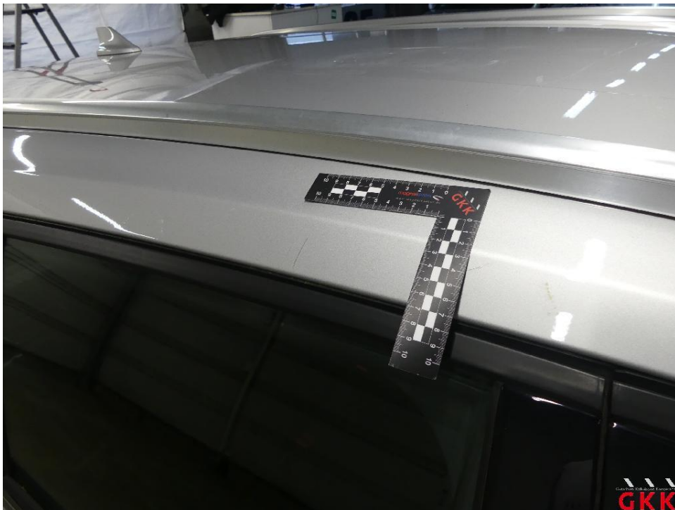
Bild 22 Dach, Holm rechts, verkratzt, lackieren
