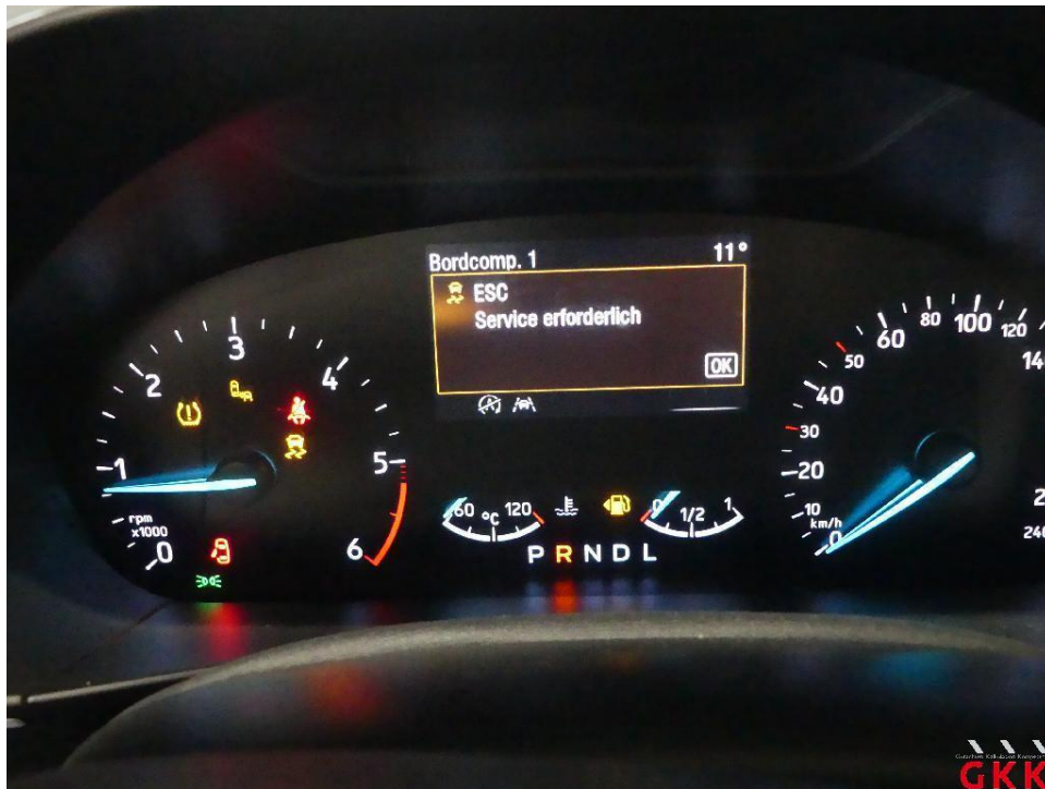
Bild 16 Kombiinstrument, Fehlerspeicher, aktiv, auslesen / prüfen
