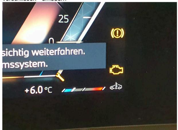
**Beschädigung #7:** elektronische Systeme: elektronische Systeme (Motorkontrollleuchte an) - fällig - Diagnose
