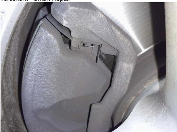
**Beschädigung #6:** Bremsanlage: Bremsbeläge vorn - verschlissen - erneuern
