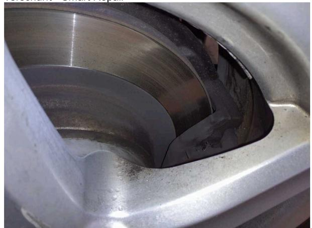
**Beschädigung #5:** Bremsanlage: Bremsbeläge hinten - verschlissen - erneuern
