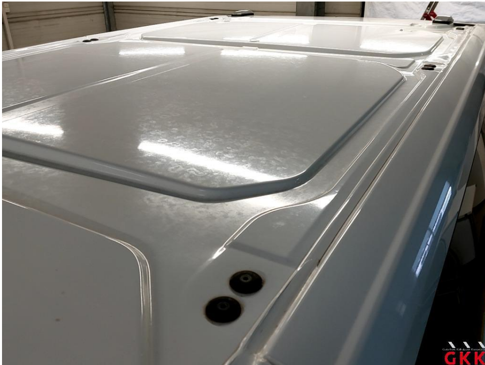
Bild 13 Dach, beschädigt, kalt drücken
