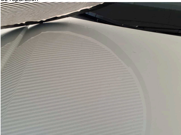
Domage 3: Capot moteur: Capot moteur - bosse(s) - Bon travail de réparation
