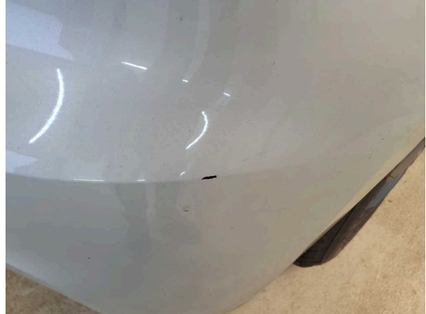
Domage 2: Pare-chocs arrière: Pare-chocs arrière - Erafilé - Réparation intelligente
