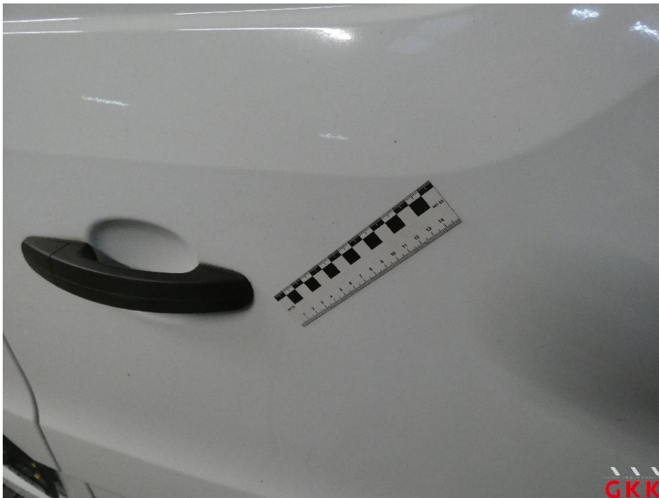
Bild 30 Hecktür rechts, Industriestaubhaftung / Flugrost, aufbereiten
