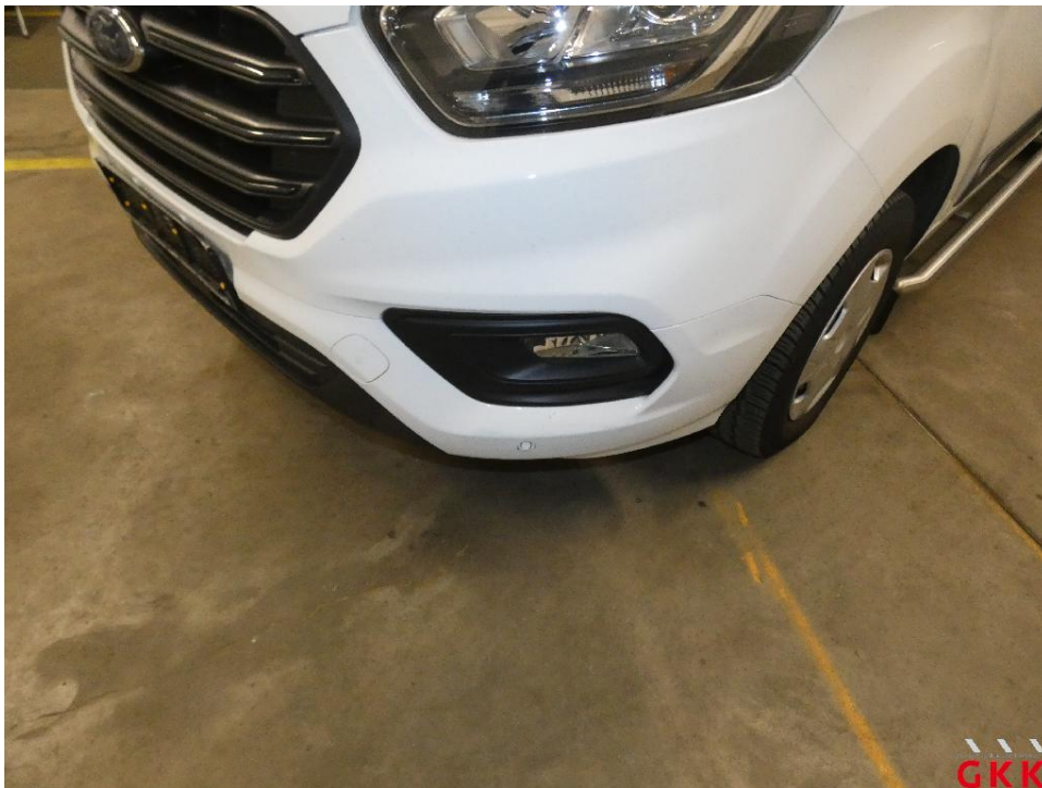
Bild 22 Stoßfänger vorne, Verkleidung unterhalb -lackiert-, verkratzt, lackieren
