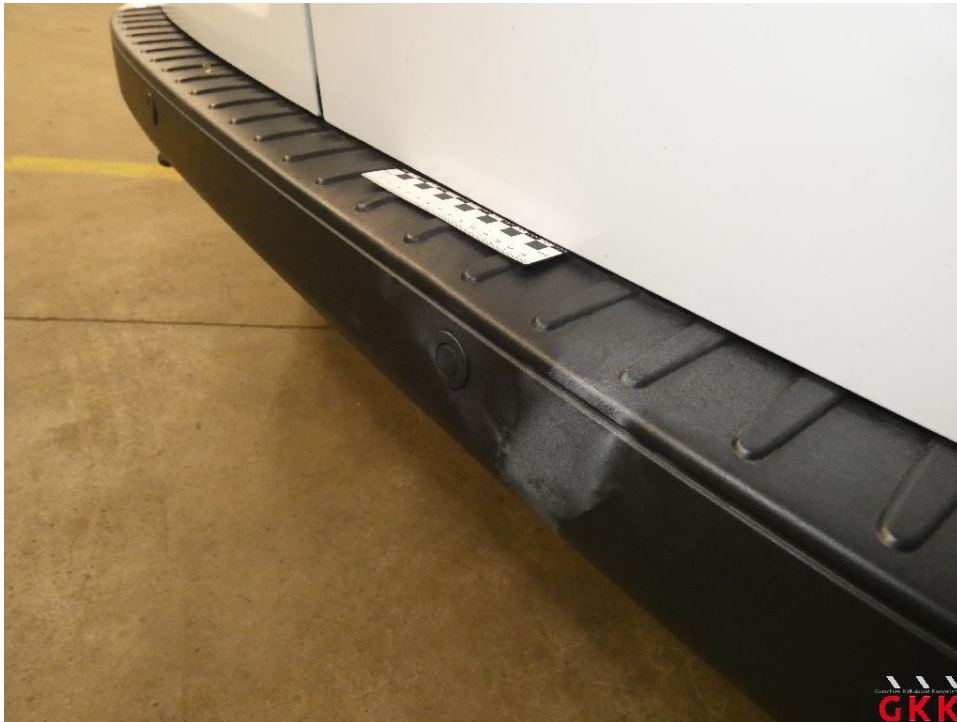
Bild 41 Stoßfänger hinten, Verkleidung -unlackiert-, beschädigt, ersetzen
