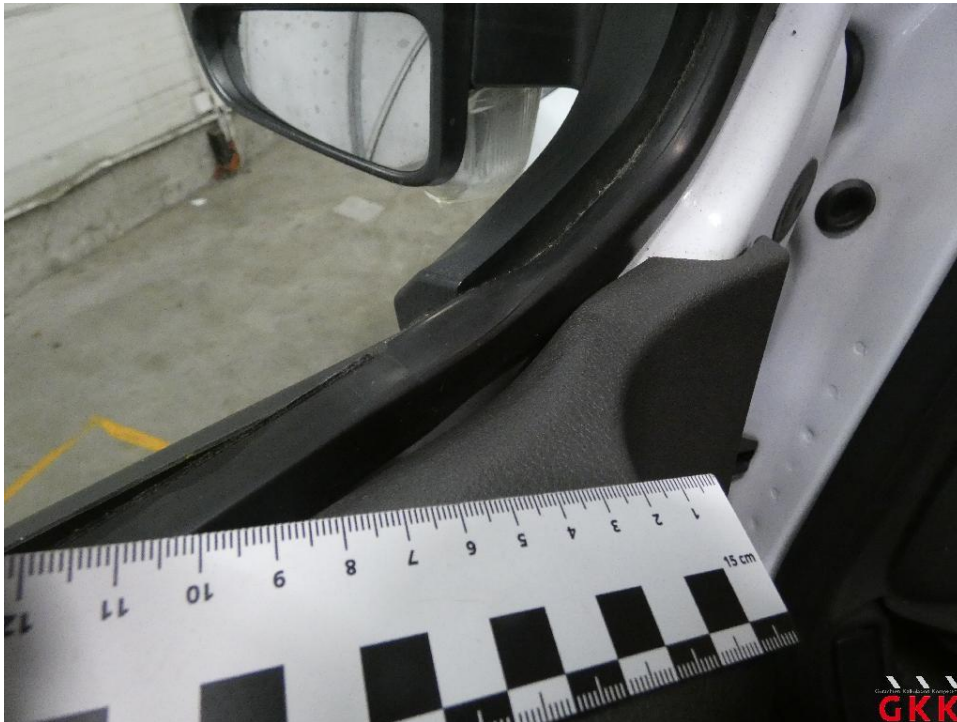
Bild 39 Tür vorne links, Dichtung, beschädigt, ersetzen
