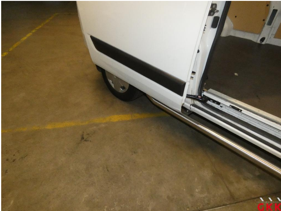
Bild 33 Schiebetür rechts, beschädigt, ersetzen
