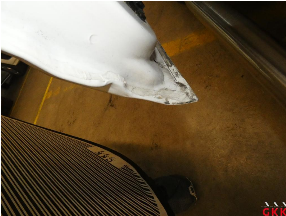
Bild 35 Schiebetür rechts, beschädigt, ersetzen
