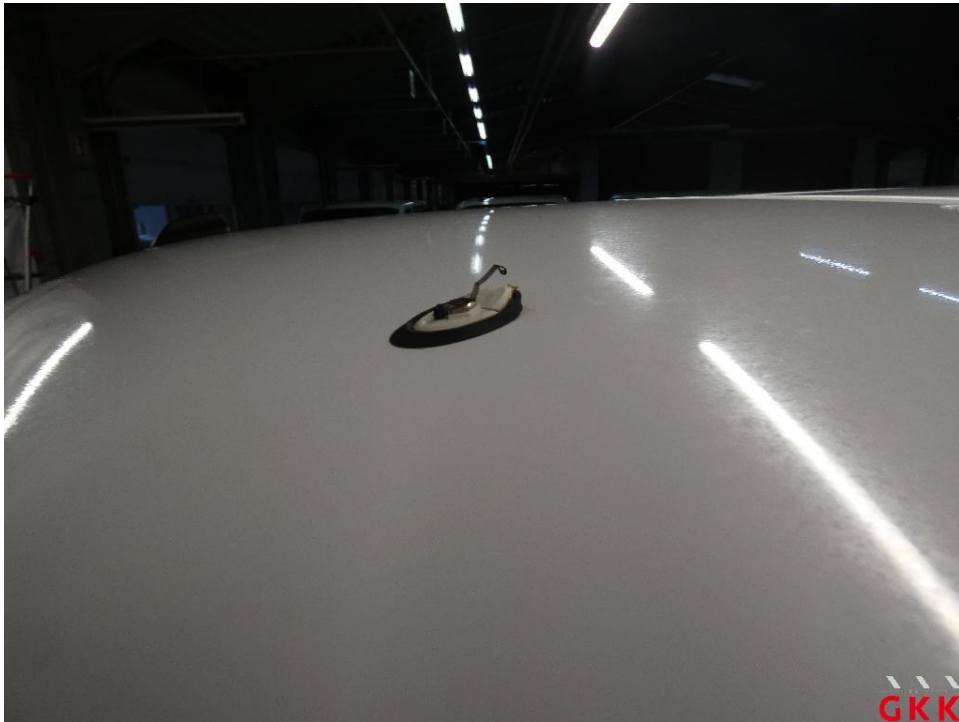
Bild 37 Antenne links, beschädigt, ersetzen
