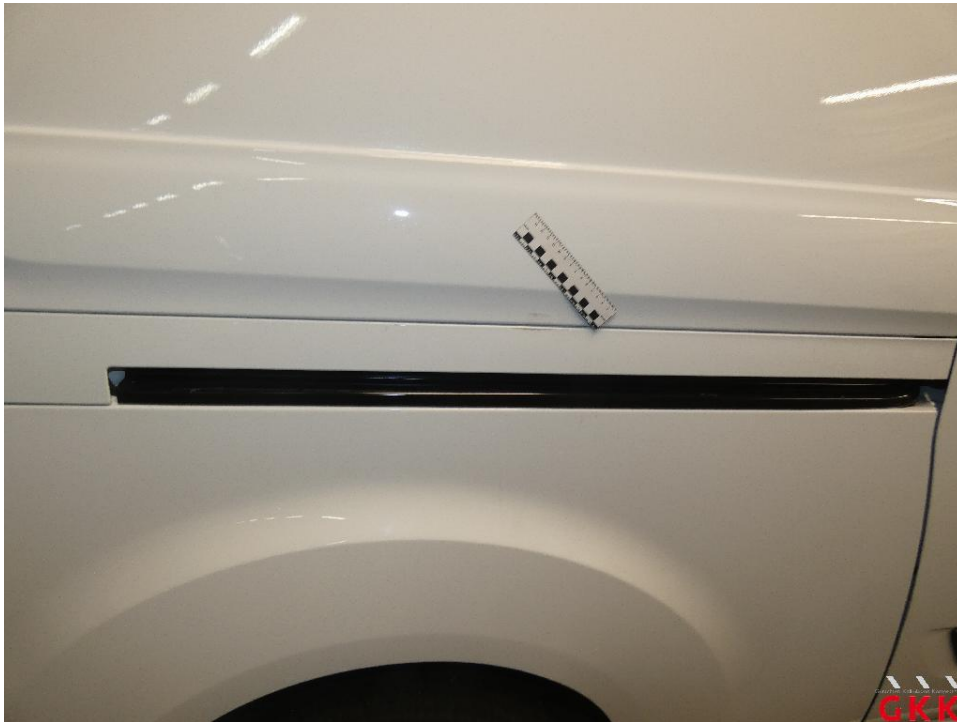
Bild 31 Seitenwand rechts, Harzanhaftungen/-rückstände, aufbereiten
