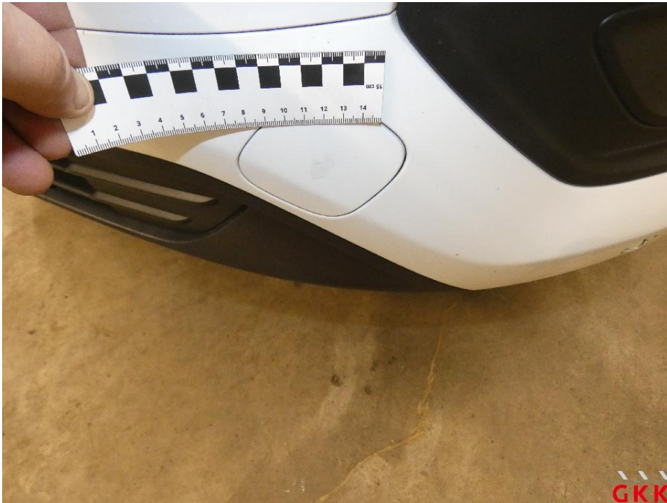
Bild 27 Stoßfänger vorne, Abdeckung Abschlepphaken, verkratzt, lackieren
