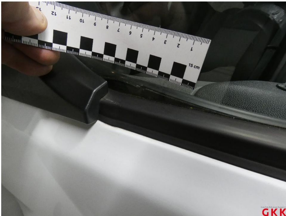
Bild 38 Tür vorne links, Dichtung, beschädigt, ersetzen
