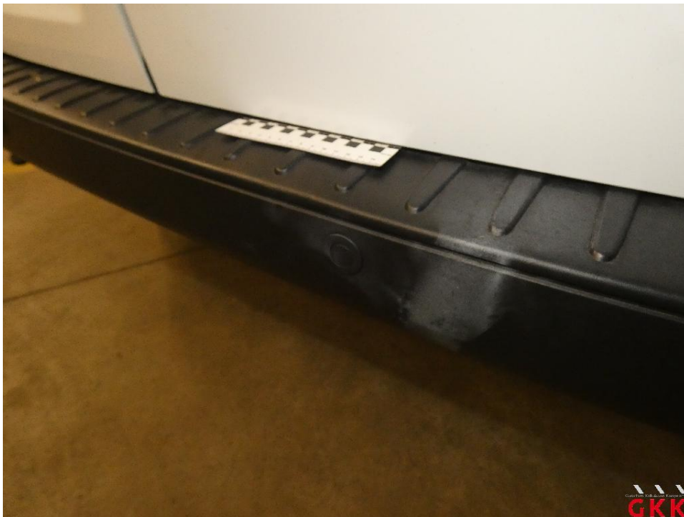
Bild 42 Stoßfänger hinten, Verkleidung -unlackiert-, beschädigt, ersetzen
