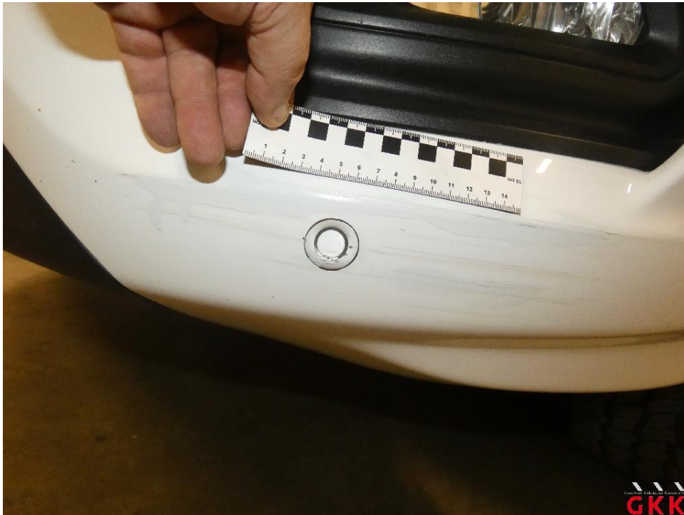
Bild 23 Stoßfänger vorne, Verkleidung unterhalb -lackiert-, verkratzt, lackieren
