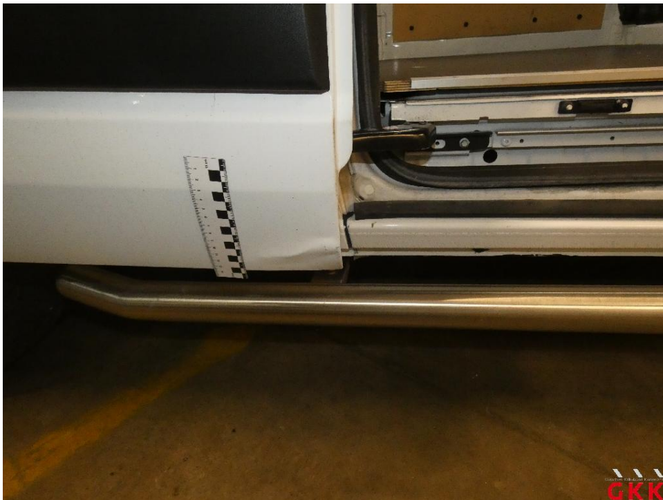
Bild 34 Schiebetür rechts, beschädigt, ersetzen
