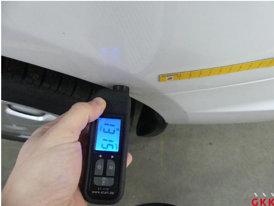
Bild 45 Seitenwand links, Reparaturmangel, lackieren
