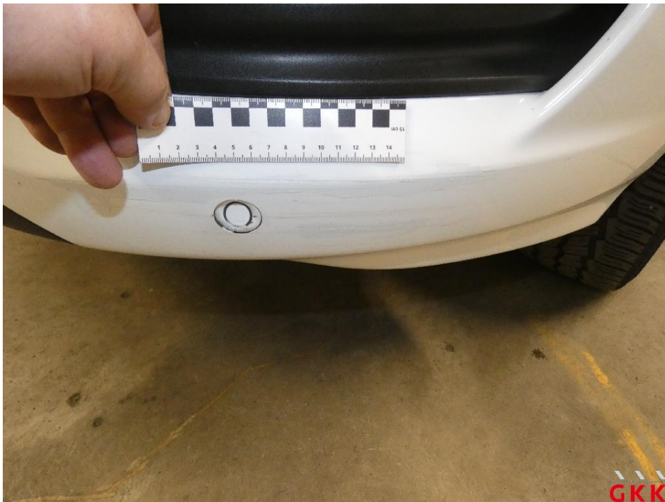
Bild 24 Stoßfänger vorne, PDC-Sensor, lose, ersetzen
