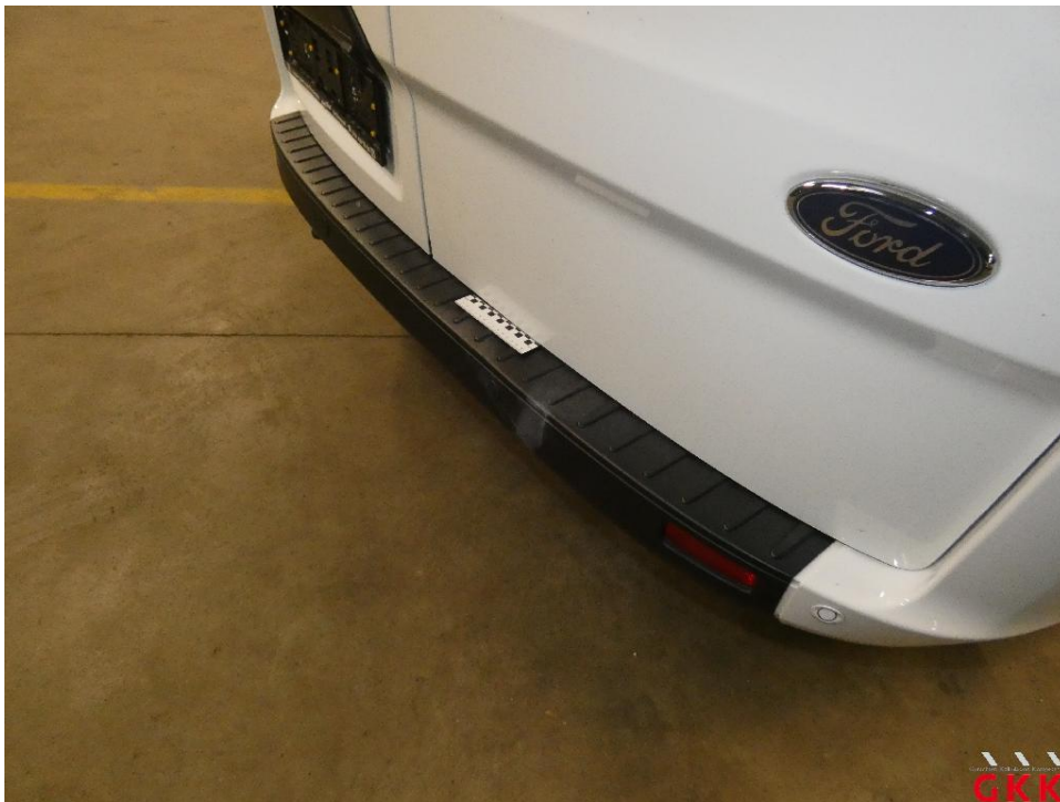
Bild 40 Stoßfänger hinten, Verkleidung -unlackiert-, beschädigt, ersetzen
