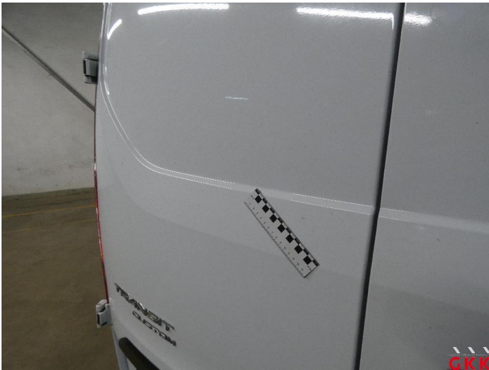
Bild 28 Hecktür links, korrodiert, lackieren
