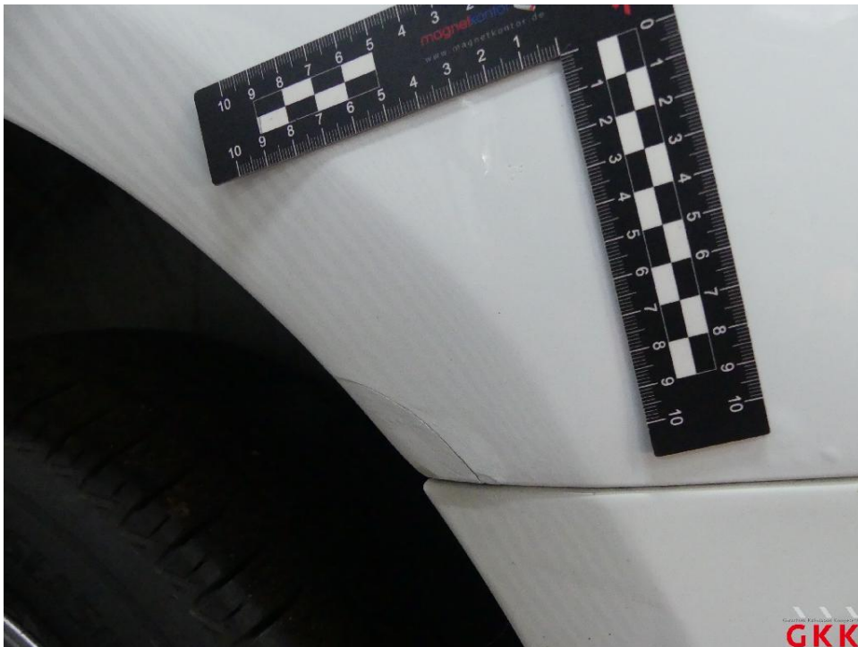
Bild 44 Seitenwand links, Reparaturmangel, lackieren
