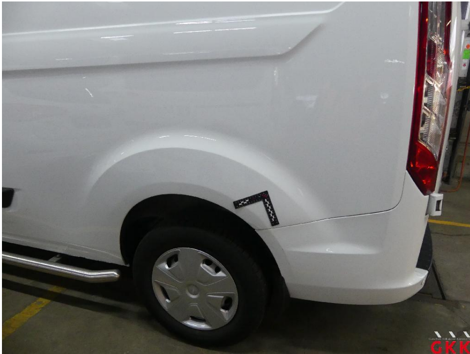
Bild 43 Seitenwand links, Reparaturmangel, lackieren
