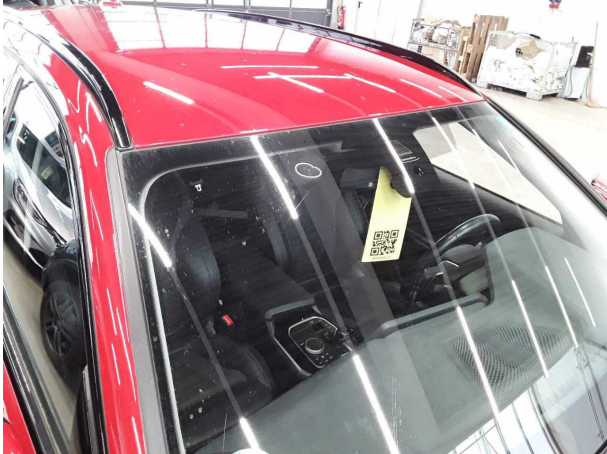
Beschädigung #1: Verglasung: Frontscheibe mit Spurhalteassistent (mit Rissbildung zu nah am Rand) - Steinschlag
