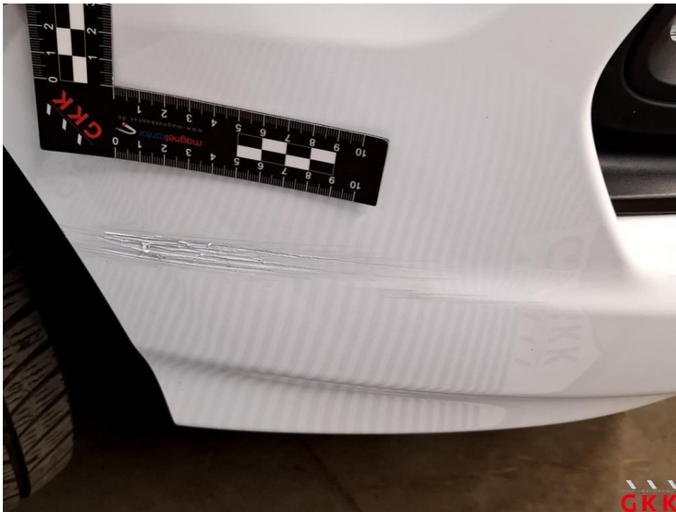
Bild 16 Stoßfänger vorne, Verkleidung -lackiert-, beschädigt, ersetzen
