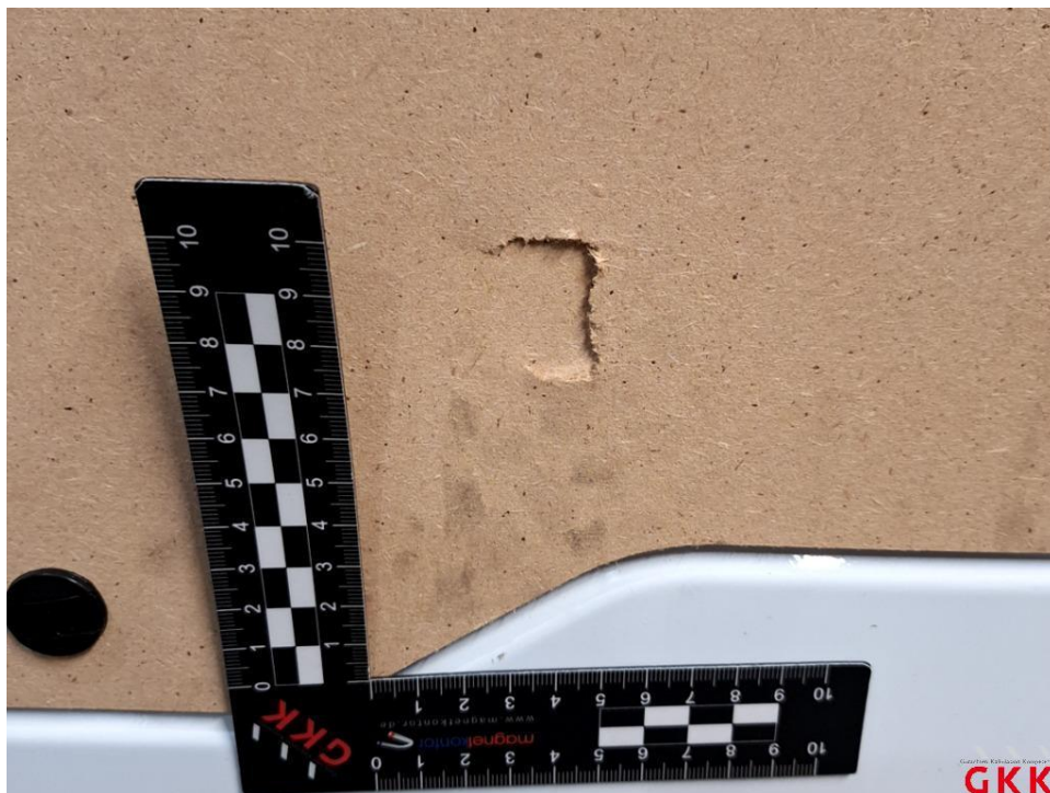
Bild 27 Hecktür rechts, Innenverkleidung, beschädigt, ersetzen
