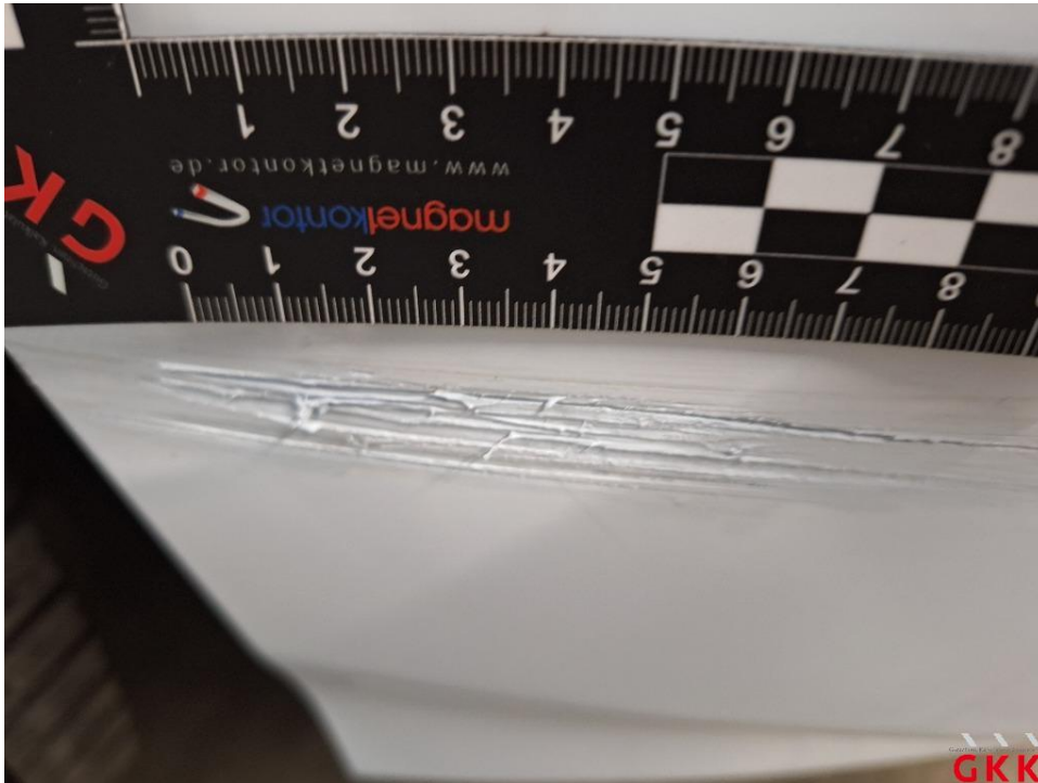
Bild 17 Stoßfänger vorne, Verkleidung -lackiert-, beschädigt, ersetzen
