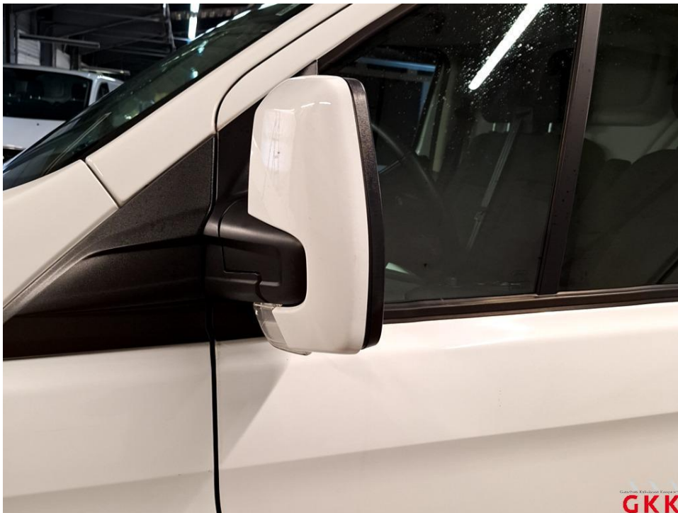
Bild 18 Spiegelgehäuse links, Blende -lackiert-, lose, ersetzen
