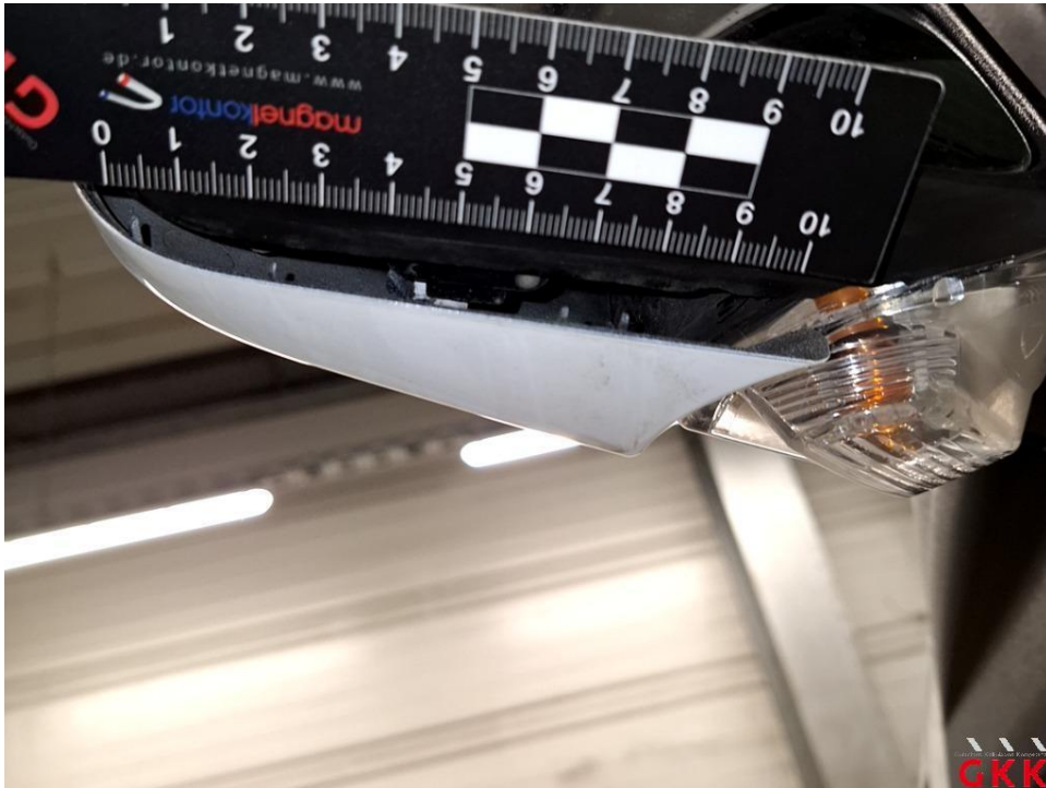
Bild 19 Spiegelgehäuse links, Blende -lackiert-, lose, ersetzen
