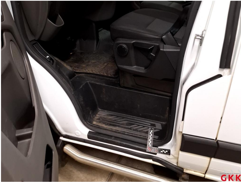
Bild 13 Tür vorne links, Dichtung, lose, ersetzen
