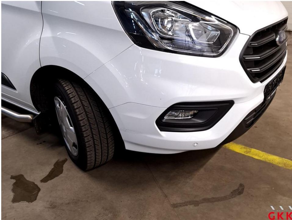
Bild 15 Stoßfänger vorne, Verkleidung -lackiert-, beschädigt, ersetzen
