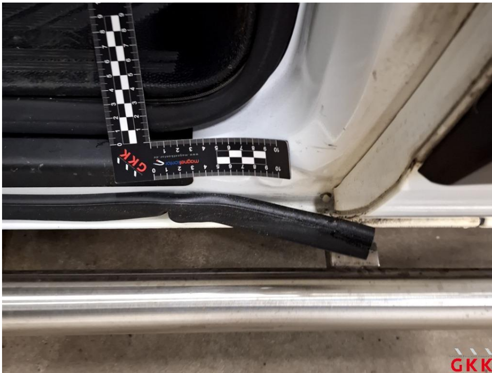
Bild 14 Tür vorne links, Dichtung, lose, ersetzen
