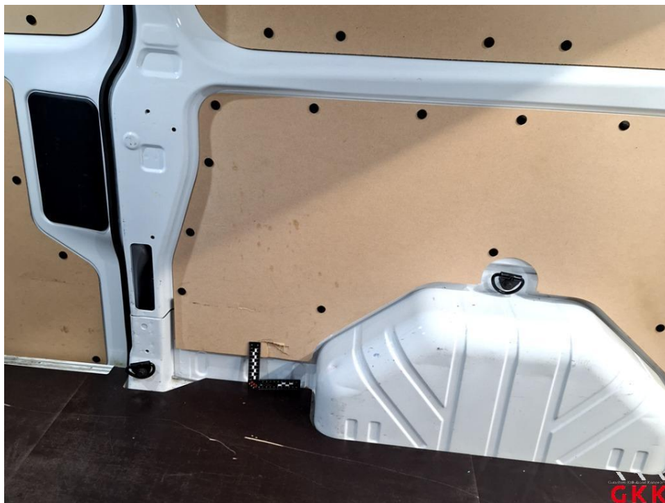
Bild 28 Seitenwand rechts, Innenverkleidung, beschädigt, ersetzen
