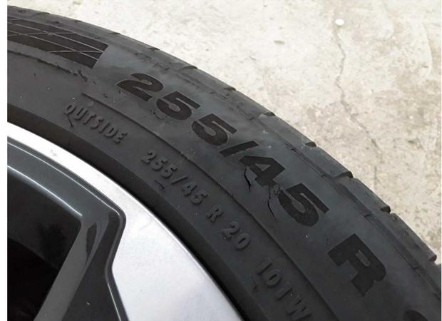
**Beschädigung #3:** 2.Radsatz: 1 Reifen - beschädigt - erneuern
