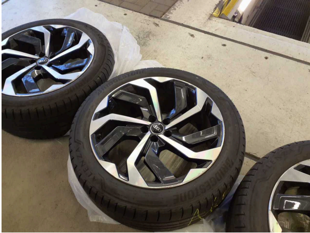
Beschädigung #6: 2.Radsatz: 1 Leichtmetallfelge (Materialabrieb) - verkratzt / verschürft - erneuern
