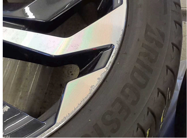
Beschädigung #6: 2.Radsatz: 1 Leichtmetallfelge (Materialabrieb) - verkratzt / verschürft - erneuern
