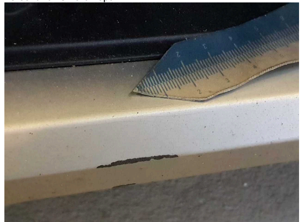
Beschädigung #2: Stossfänger vorn: Spoiler - verkratzt / verschürft - Smart Repair
