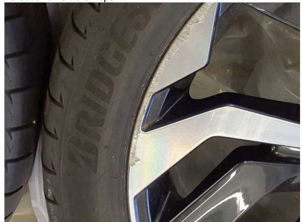
Beschädigung #5: 2.Radsatz: 1 Leichtmetallfelge (Materialabrieb) - verkratzt / verschürft - erneuern
