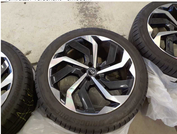
Beschädigung #7: 2.Radsatz: 1 Leichtmetallfelge (Materialabrieb) - verkratzt / verschürft - erneuern
