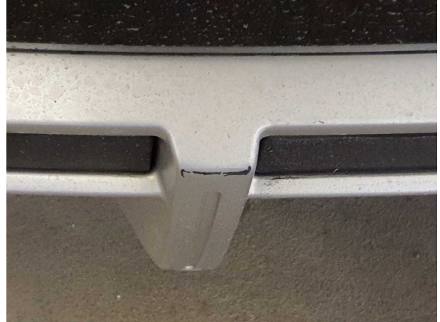
Beschädigung #1: Stossfänger hinten: Spoiler - verkratzt / verschürft - Smart Repair
