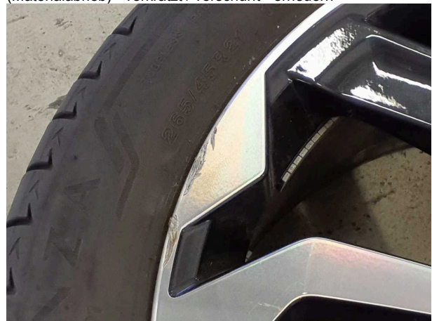
Beschädigung #7: 2.Radsatz: 1 Leichtmetallfelge (Materialabrieb) - verkratzt / verschürft - erneuern
