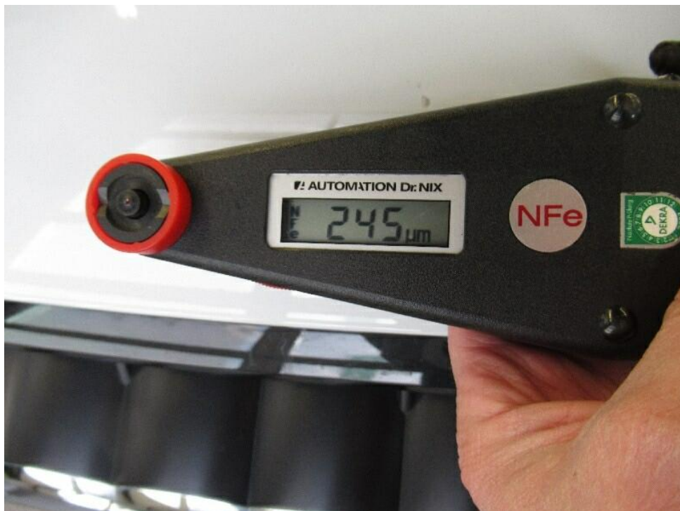
Bild 22 : Lackwerte Motorhaube (Original)
