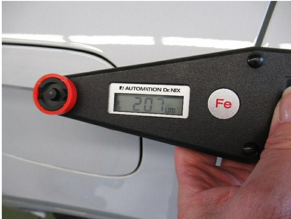
Bild 23 : Lackwerte Motorhaube (Original)
