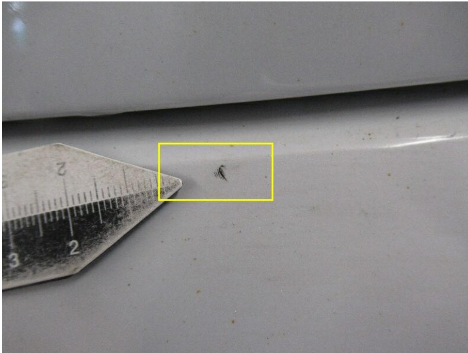
Bild 17 : Stoßfänger hinten Lackierung, verschrammt, Gebrauchsspur
