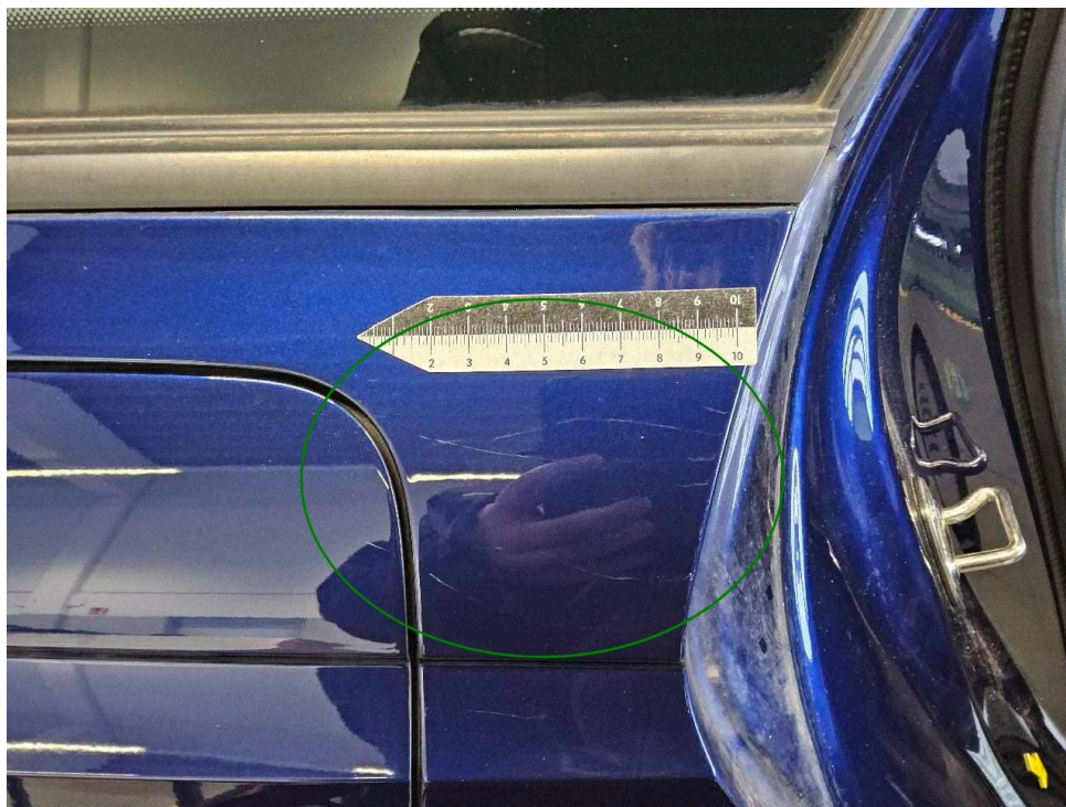
Bild 20 : Seitenwand hinten rechts zerkratzt
