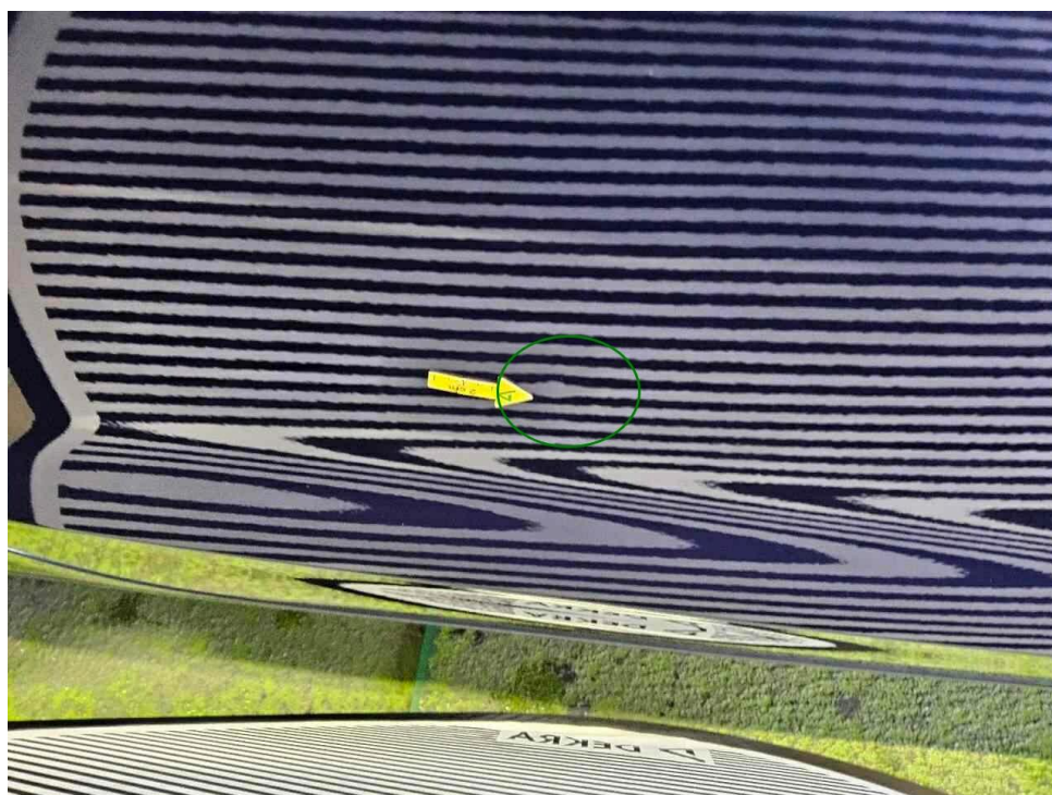
Bild 18 : Tür hinten rechts eingedellt
