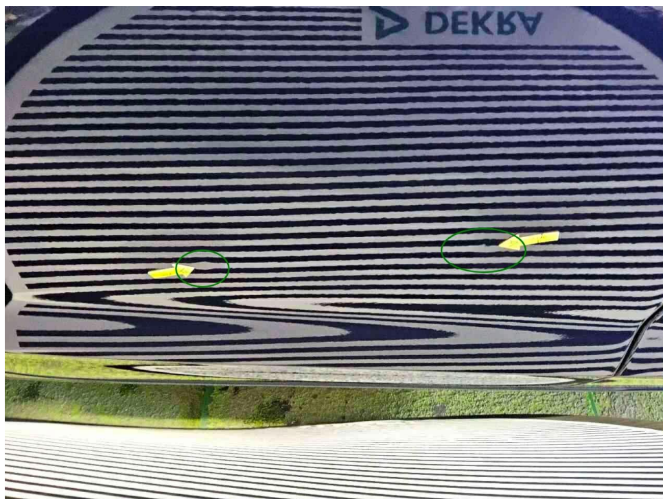
Bild 17 : Tür hinten rechts eingedellt
