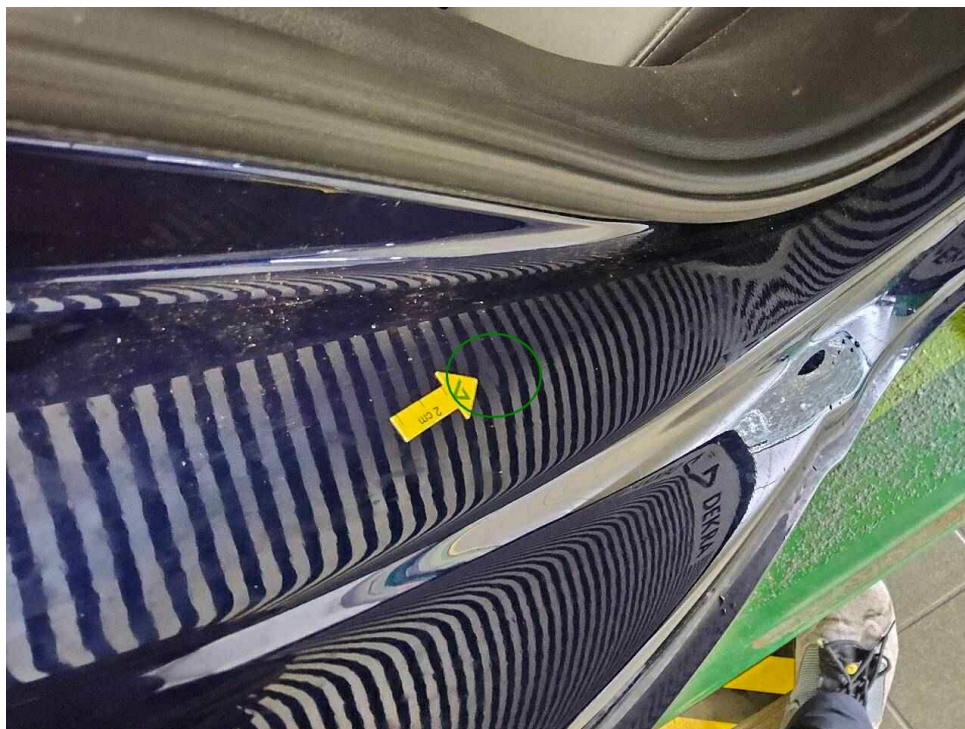
Bild 19 : Tür hinten rechts eingedellt
