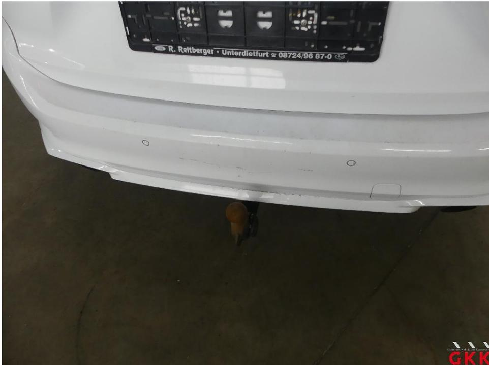
Bild 51 Stoßfänger hinten, Verkleidung -lackiert-, aufgeworfen, ersetzen
