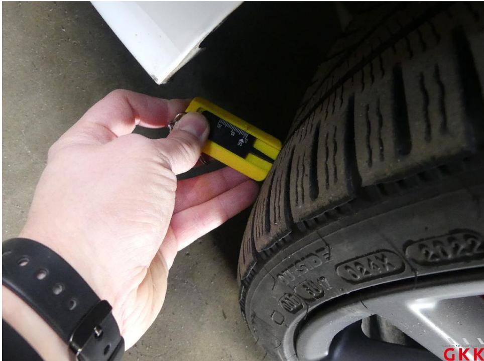
Bild 59 Reifen, vorn und hinten, Untermaß, ersetzen
