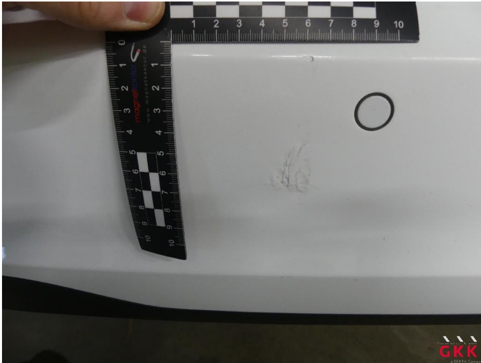
Bild 17 Stoßfänger hinten, Verkleidung -lackiert-, beschädigt, ersetzen
