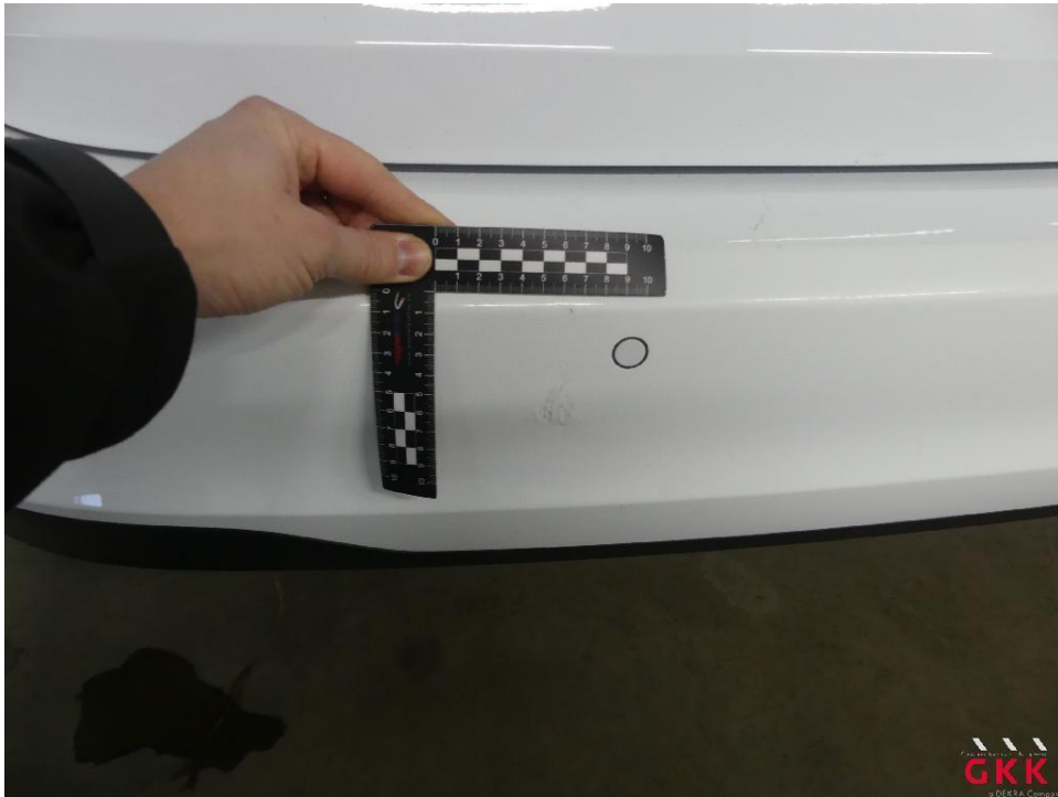
Bild 15 Stoßfänger hinten, Verkleidung -lackiert-, beschädigt, ersetzen
