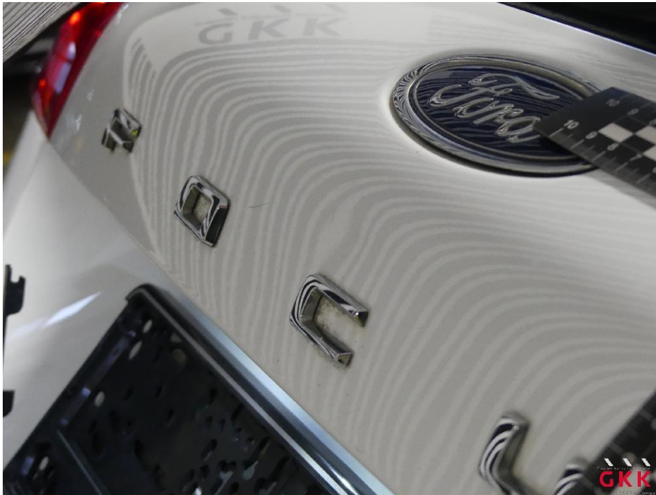
Bild 19 Heckklappe, 4 bis 10 Dellen / Bauteil, kalt drücken
