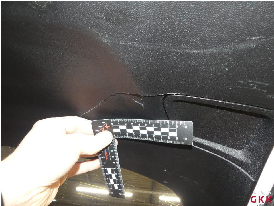
Bild 21 Heckklappe, Innenverkleidung, beschädigt, ersetzen
