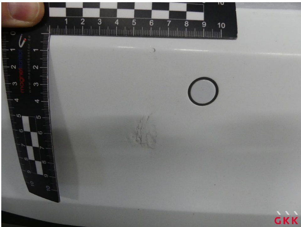
Bild 16 Stoßfänger hinten, Verkleidung -lackiert-, beschädigt, ersetzen
