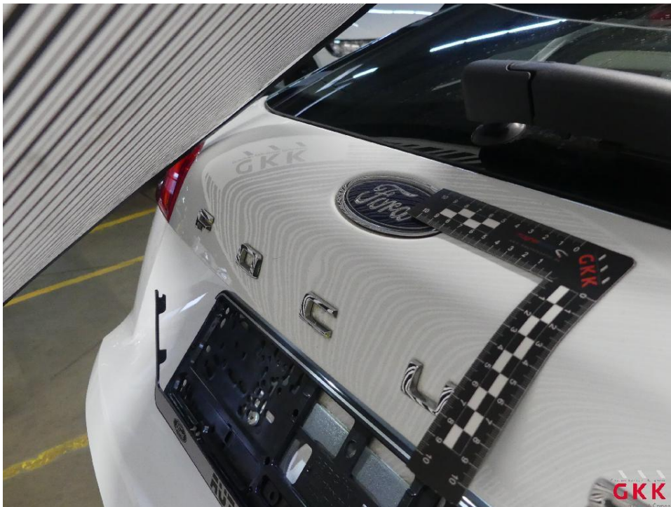
Bild 20 Heckklappe, 4 bis 10 Dellen / Bauteil, kalt drücken
