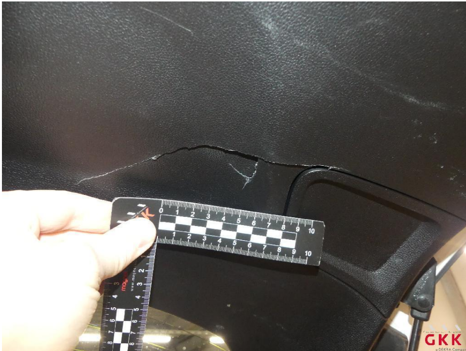
Bild 23 Heckklappe, Innenverkleidung, beschädigt, ersetzen
